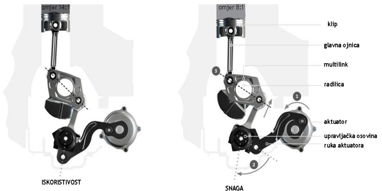
Slika 4.2. Dva modela rada motora
