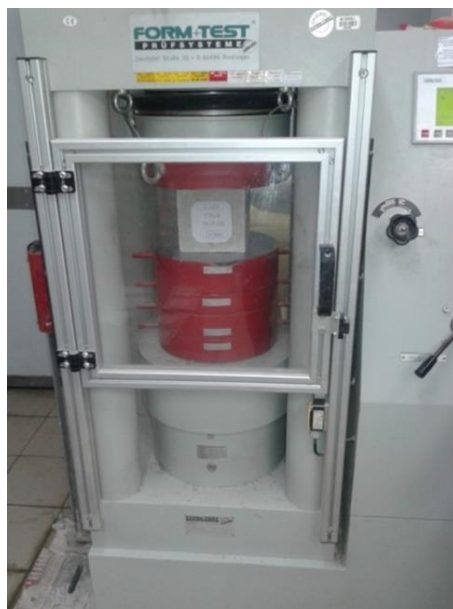
Slika 24 Ispitivanje tlačne čvrstoće betonskih kocki u laboratoriju
