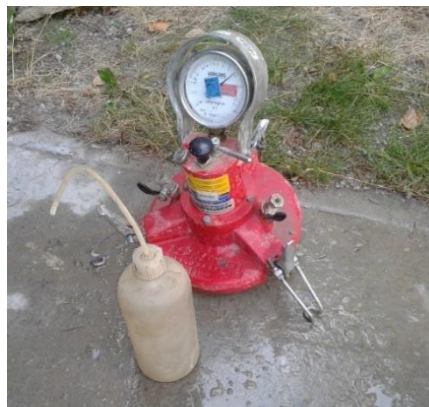
Slika 22 a) Porometar za svježi beton (Ukrainczyk, 1994); b) porometar korišten u istraživanju
