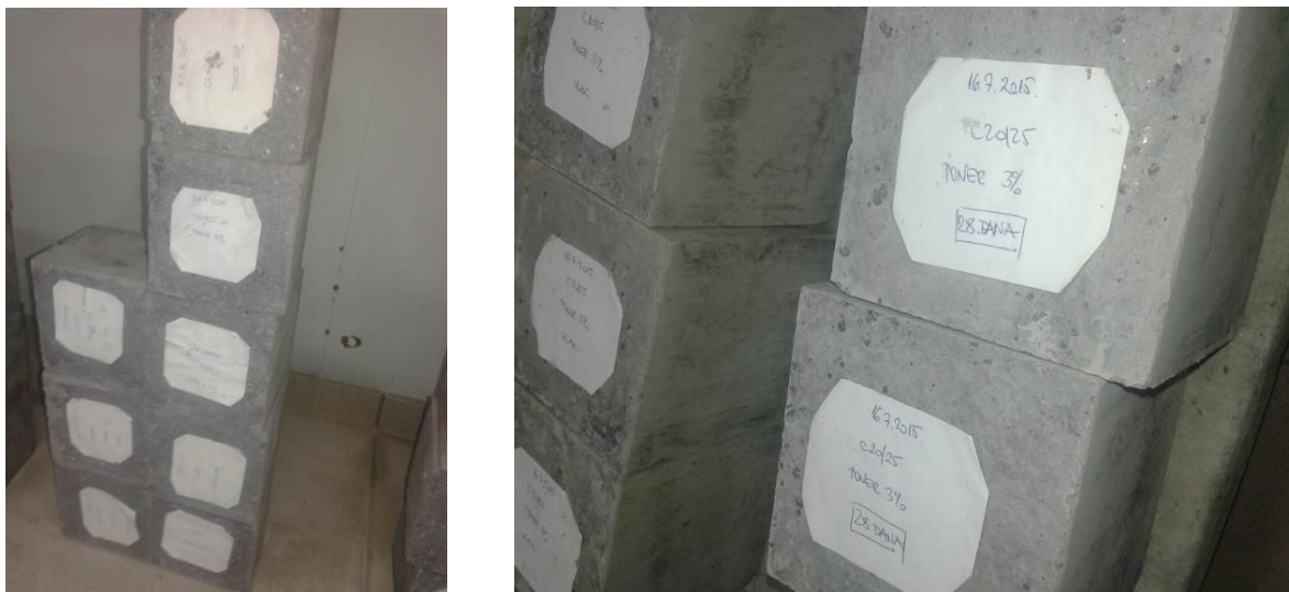
Slika 23 Njegovanje betonskih testnih kocki u vlažnoj komori
