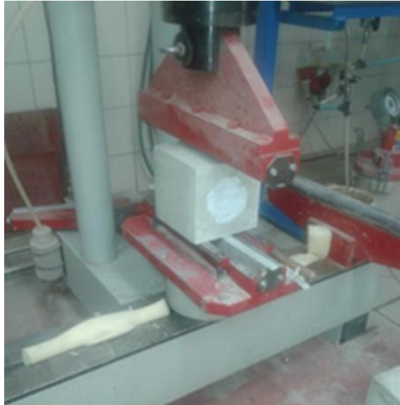
Slika 26 Ispitivanje vlačne čvrstoće betonskih kocki u laboratoriju
