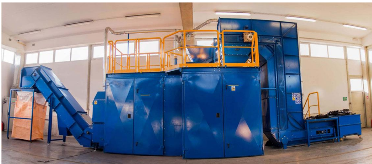
Slika 10 Uređaj za obradu otpadnih tonerskih spremnika
