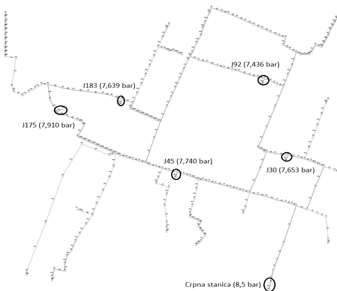
Slika 5.7. Položaj aktivnih hidranata u sustavu
