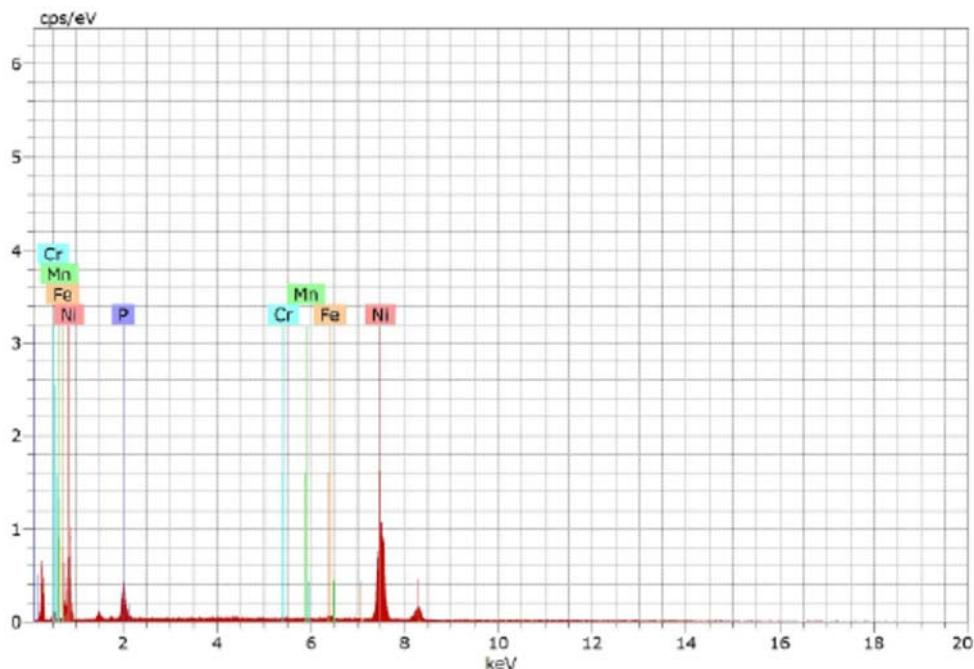
Slika 4.78. Prikaz kemijskog sastava uzorka Ni-P prevlake na supstratu toplinski obrađenog uzorka na 200 °C u točki A
