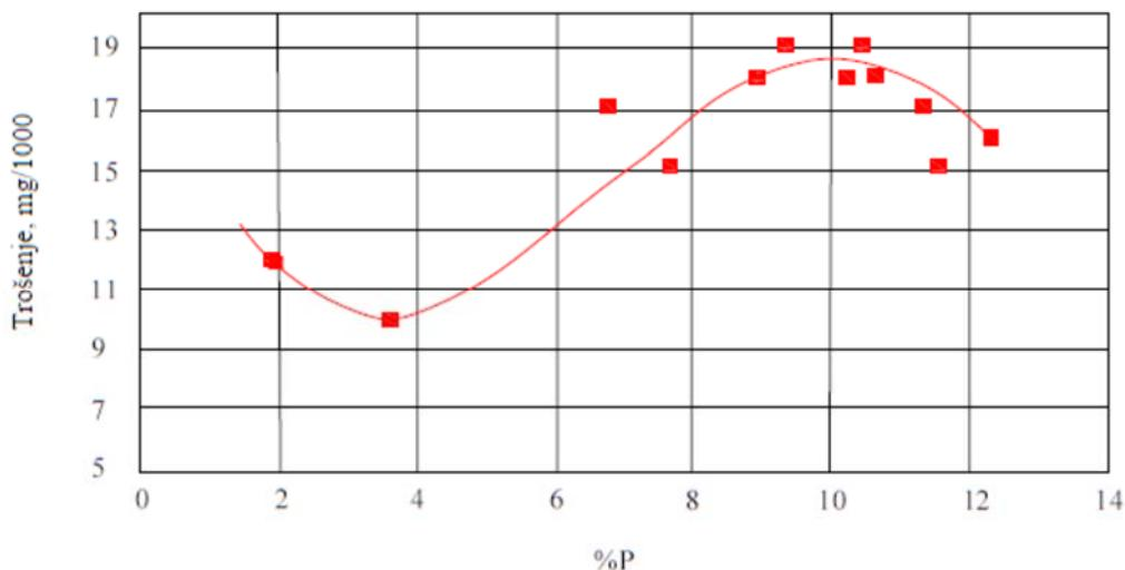
Slika 2.2. Utjecaj sadržaja fosfora na otpornost na trošenje prevlake (Taheri, 2002)
