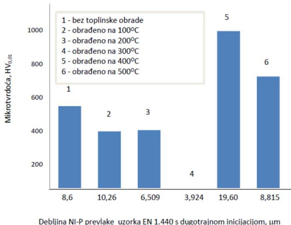
Slika 5.1. Odnos mikrotvrdoće i debljine Ni-P prevlaka kod uzoraka dobivenih bestrujnim niklanjem sa dugotrajanom inicijacijom
