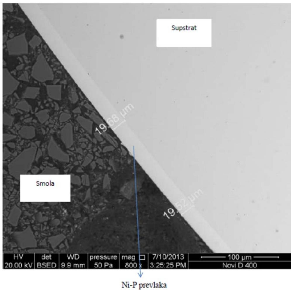
Slika 4.91. Debljina lijeve strane Ni-P prevlake na supstratu toplinski obrađenog uzorka na
