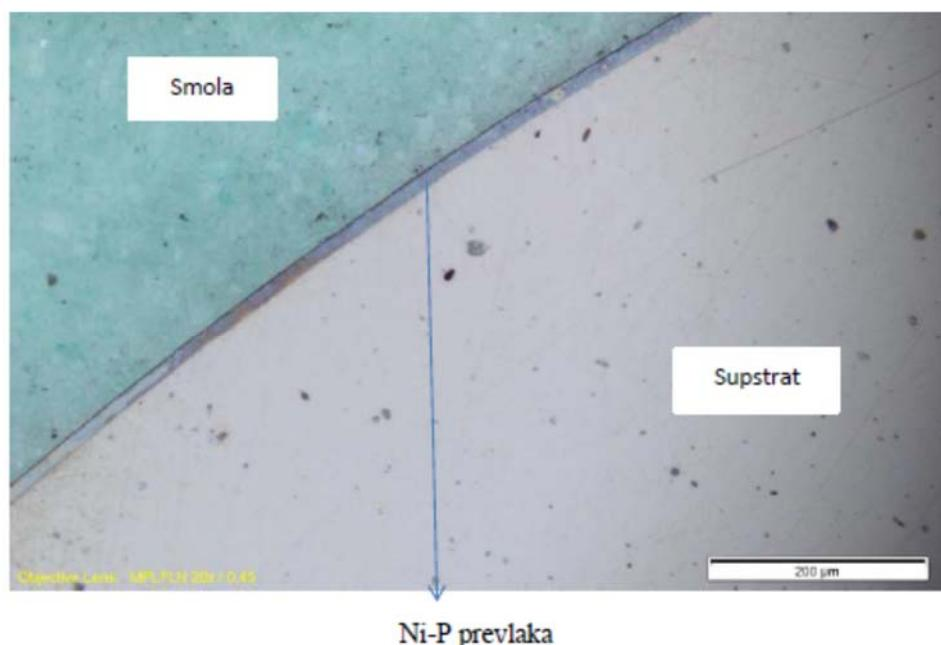
Slika 4.38. Ni-P prevlaka i supstrat toplinski obrađenog uzorka na 500 °C
