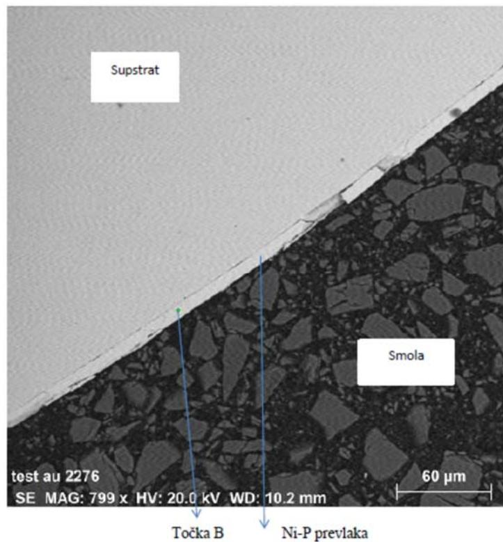
Slika 4.107. Kemijska analiza Ni-P prevlake na supstratu uzorka toplinski obrađenog na 500 °C u točki B
