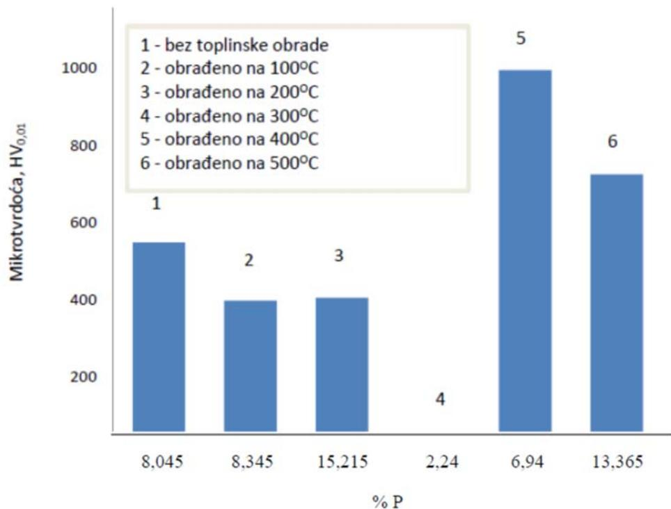
Slika 5.5. Odnos mikrotvrdoće Ni-P prevlake i fosfora u prevlaci kod uzoraka dobivenih bestrujnim niklanjem sa dugotrajnom inicijacijom
