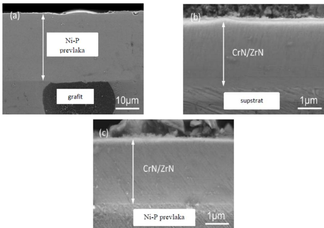
Slika 3.13. a) Ni-P prevlaka, b) CrN/ZrN sloj, c) Ni-P prevlaka kao podloga CrN/ZrN sloju
