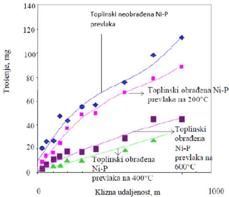
Slika 2.5. Povećanje otpornosti Ni-P prevlake na trošenje pod utjecajem toplinske obrade
