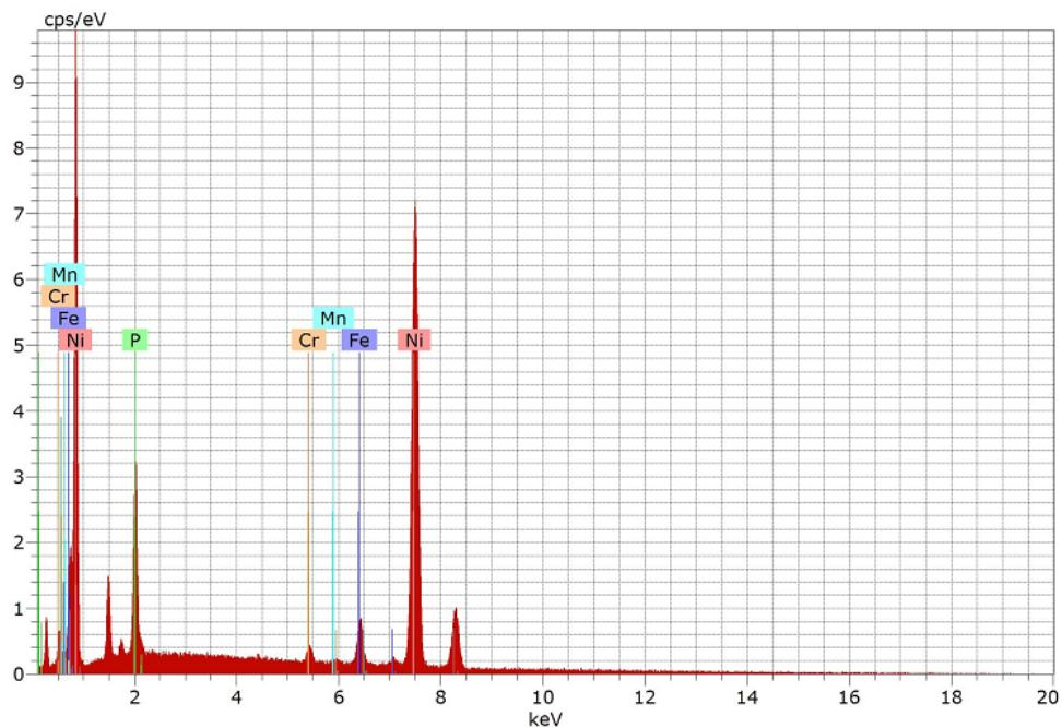
Slika 4.62. Prikaz kemijskog sastava uzorka Ni-P prevlake na supstratu toplinski neobrađenog uzorka u točki B
