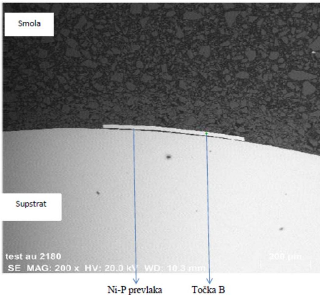
Slika 4.61. Kemijska analiza Ni-P prevlake na supstratu toplinski neobrađenog uzorka u točki B
