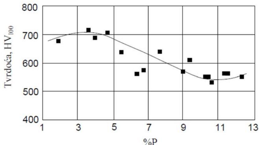
Slika 2.6. Ovisnost tvrdoće o sadržaju fosfora (Taheri, 2002)
