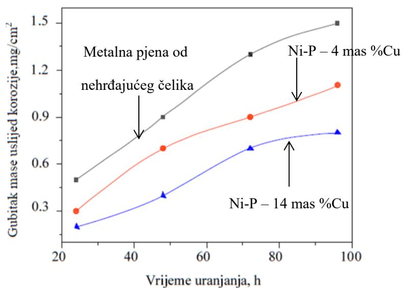
Slika 3.9. Utjecaj bakra u Ni-Cu-P prevlaci na korozionsko trošenje u HCl (Abdel i dr., 2009)
