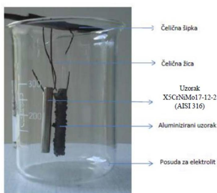
Slika 4.15. Uzorak čelika X5CrNiMo17-12-2 i
