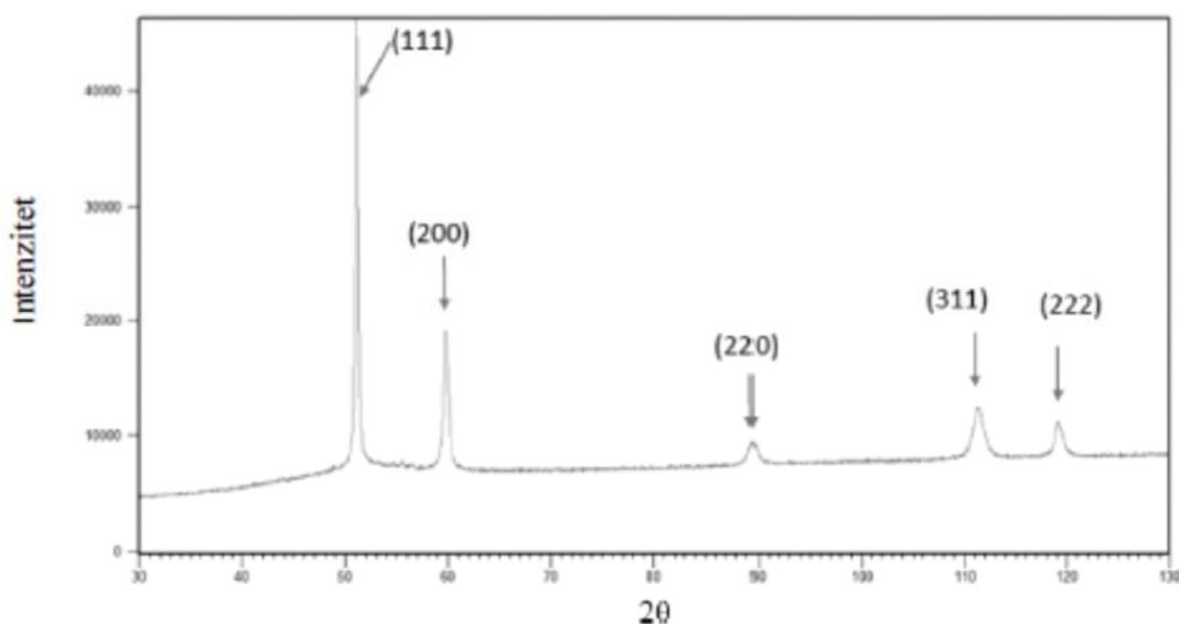
Slika 4.26. Analiza toplinski neobrađene Ni-P prevlake X zrakama
