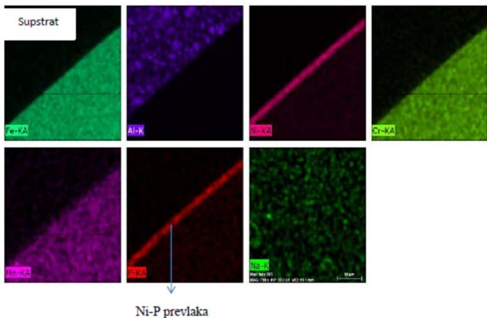
Slika 4.32. Raspodjela kemijskih elemenata na povrsini Ni-P prevlake i supstrata toplinski obrađenog uzorka na 400 °C
