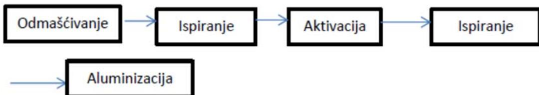
Slika 4.13. Shema pripreme i aluminizacije uzorka
