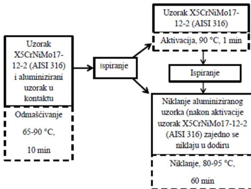
Slika 4.16. Priprema i postupak bestrujnog niklanja uzorka od čelika X5CrNiMo17-12-2
