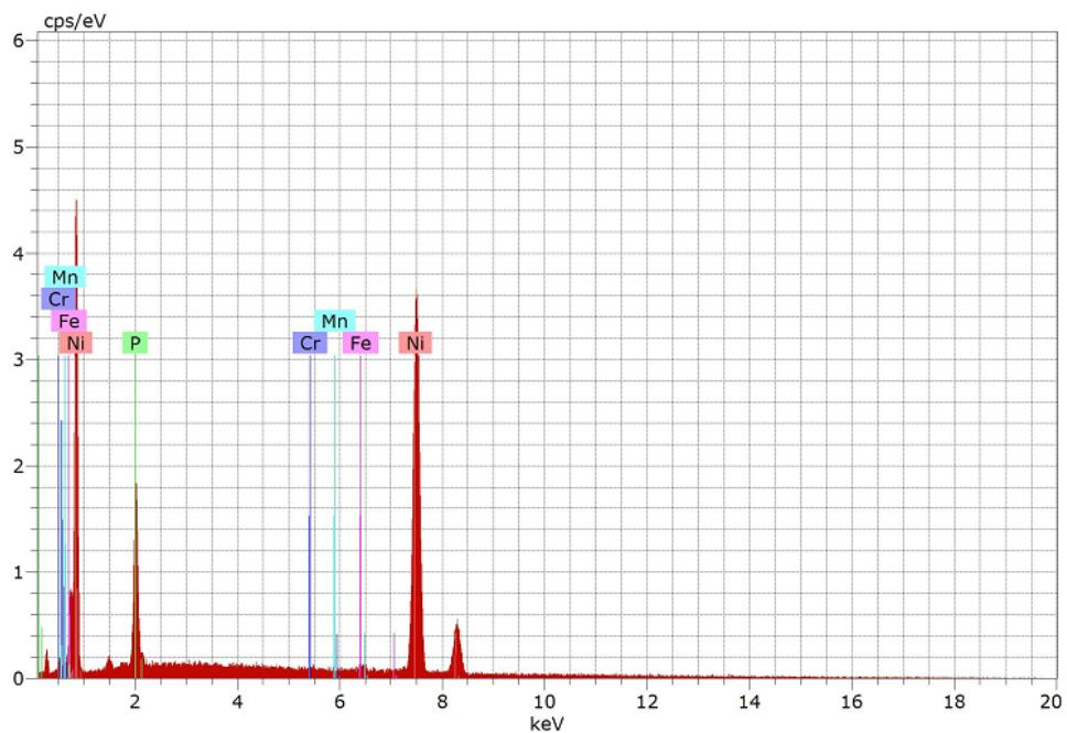
Slika 4.80. Prikaz kemijskog sastava uzorka Ni-P prevlake na supstratu toplinski obrađenog uzorka na 200 °C u točki B
