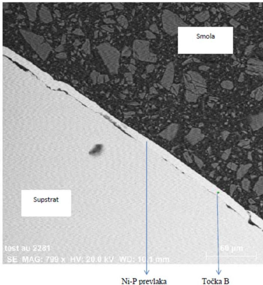
Slika 4.70. Kemijska analiza Ni-P prevlake na supstratu uzorka toplinski obrađenog uzorka na  $100\text{ }^{\circ}\text{C}$  u točki B
