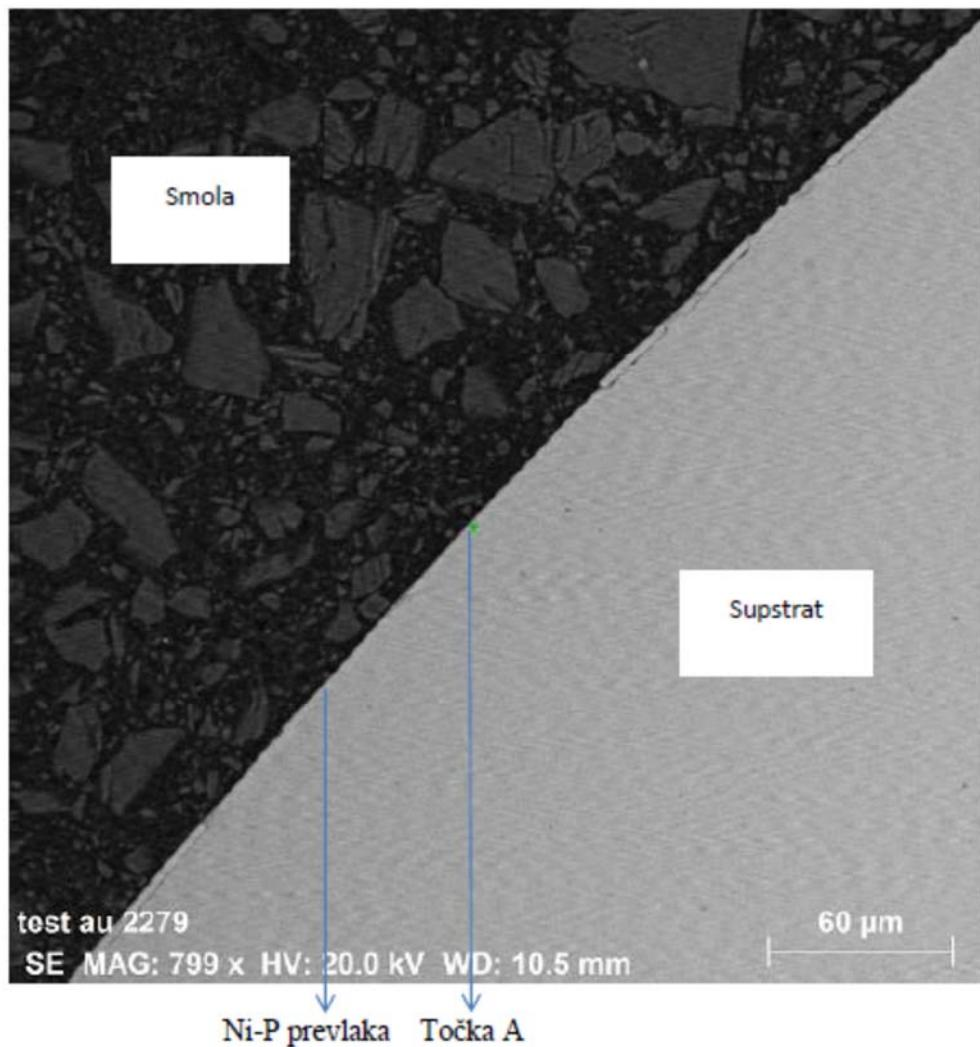
Slika 4.86. Kemijska analiza Ni-P prevlakе na supstratu toplinski obrađenog uzorka na 300 °C u točki A
