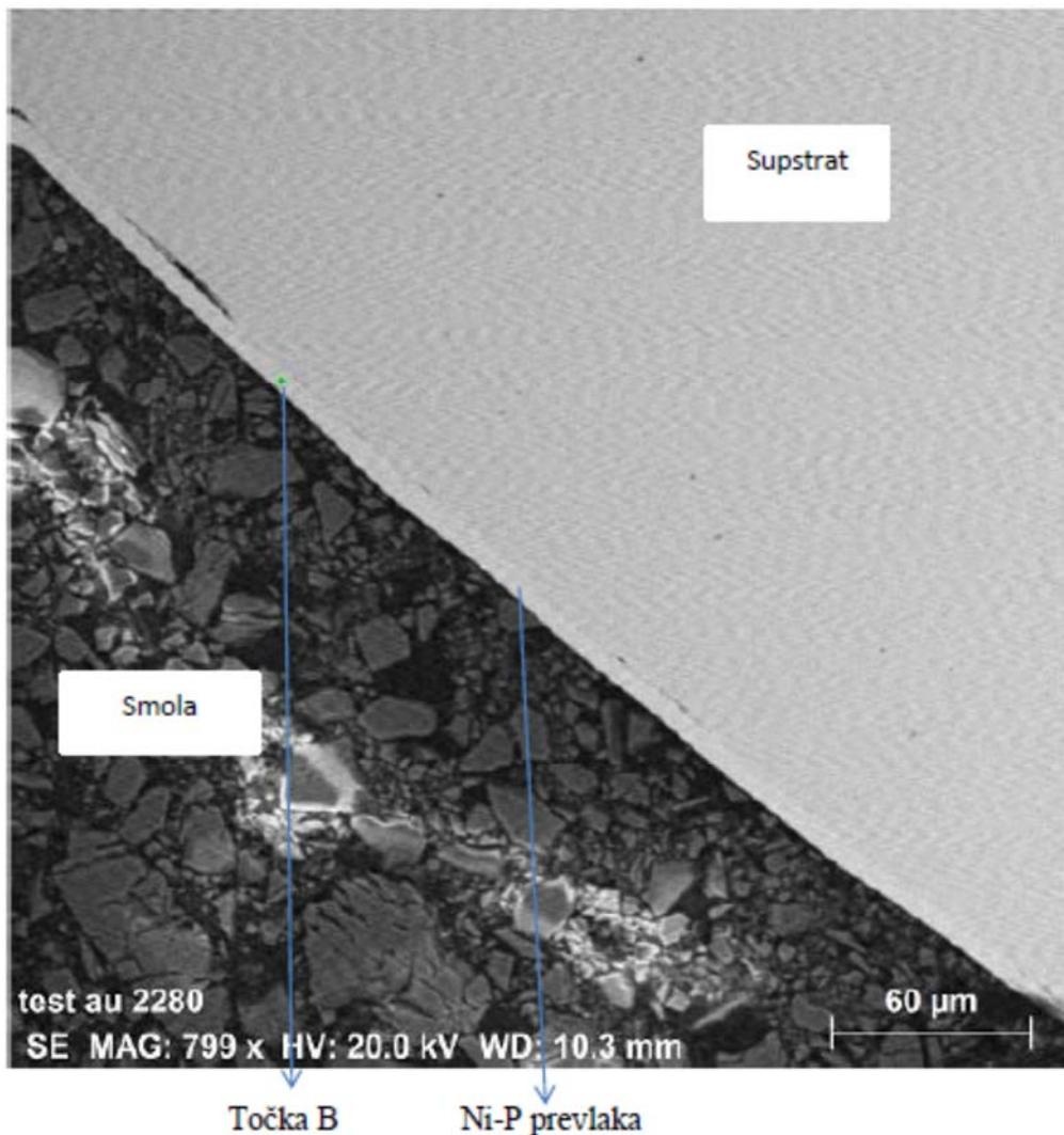
Slika 4.79. Kemijska analiza Ni-P prevlake na supstratu toplinski obrađenog uzorka na 200 °C u točki B
