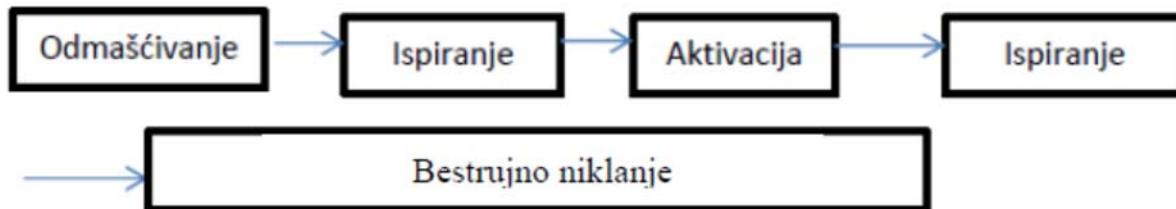
Slika 4.8. Shematski prikaz pripreme uzorka i postupka bestrujnog niklanja supstrata X5CrNiMo17-12-2
