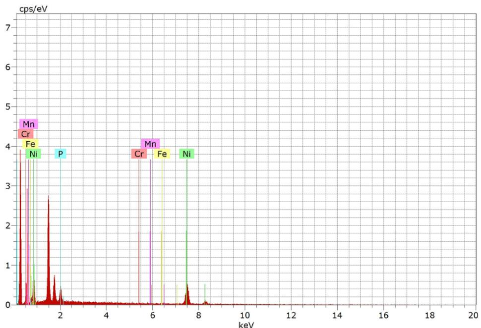
Slika 4.69. Prikaz kemijskog sastava uzorka Ni-P prevlake na supstratu toplinski obrađenog uzorka na 100 °C u točki A
