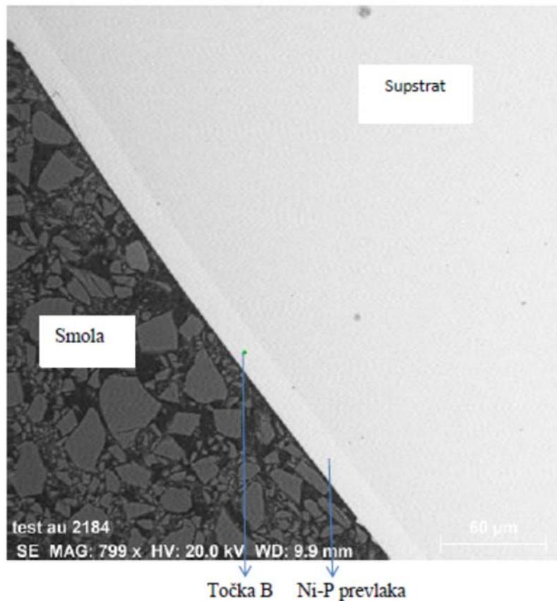
Slika 4.98. Kemijska analiza Ni-P prevlake na supstratu uzorka toplinski obrađenog uzorka na  $400^{\circ}\text{C}$  u točki B
