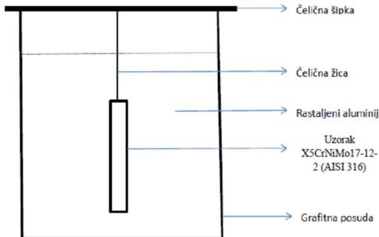
Slika 4.12. Shema uzorka uronjenog u rastaljeni aluminij
