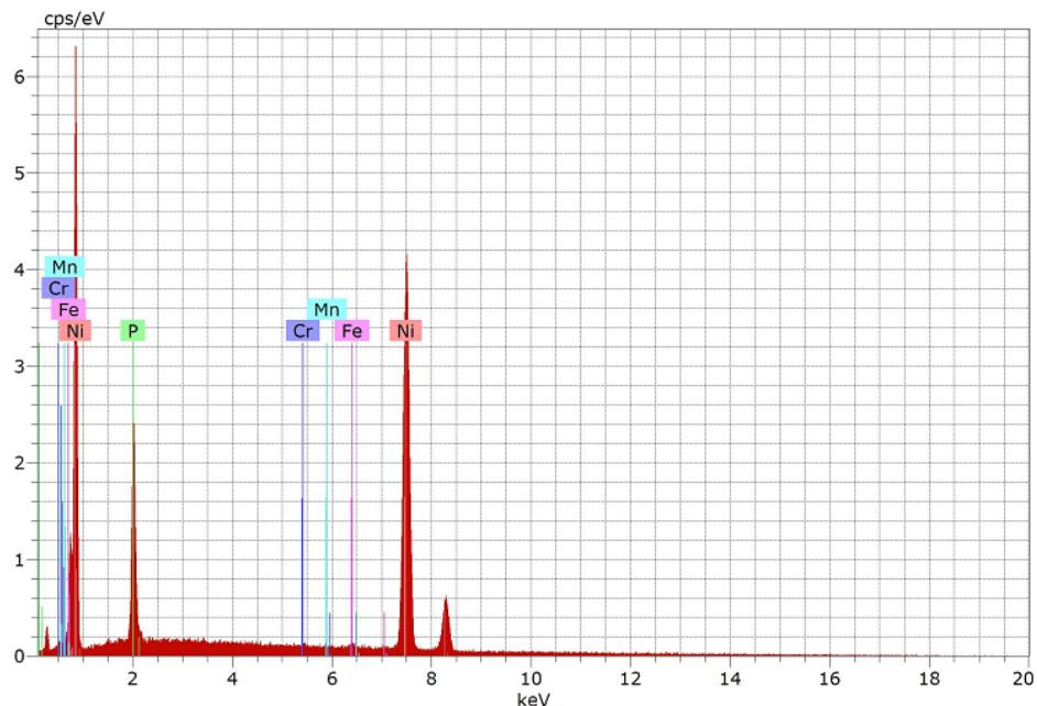
Slika 4.106. Prikaz kemijskog sastava uzorka Ni-P prevlake na supstratu toplinski obrađenog uzorka na 500 °C u točki A
