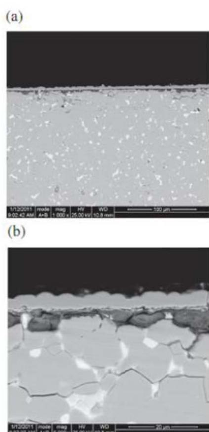
Slika 2.10. Adhezija Ni-P prevlake na sinteriranom NdFeB supstratu sa fosfatnim slojem (Yao Wang i dr., 2011)
