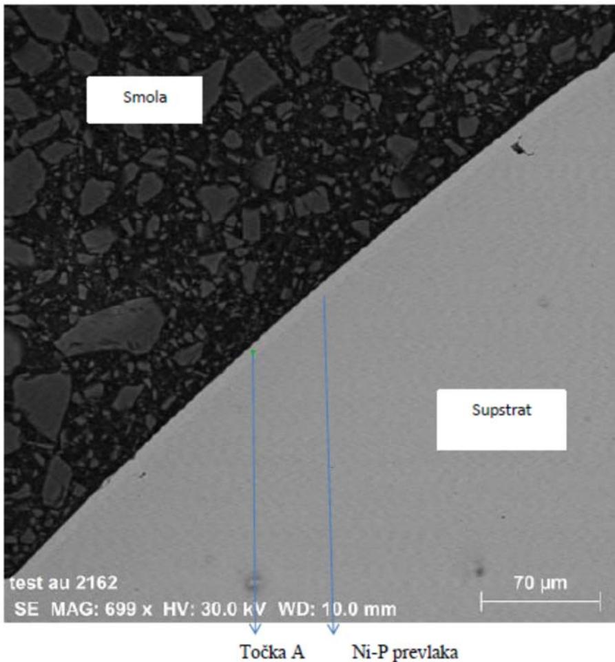
Slika 4.34. Kemijska analiza Ni-P prevlake na supstratu toplinski obrađenog uzorka na  $400^\circ\text{C}$  u točki A
