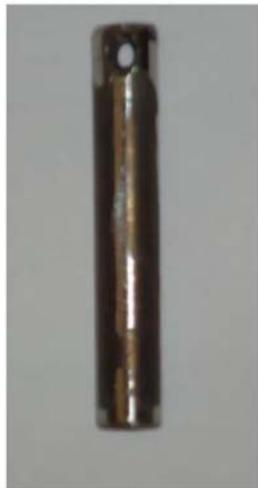
Slika 4.11. Oljuštena Ni-P prevlaka nakon toplinske obrade.
