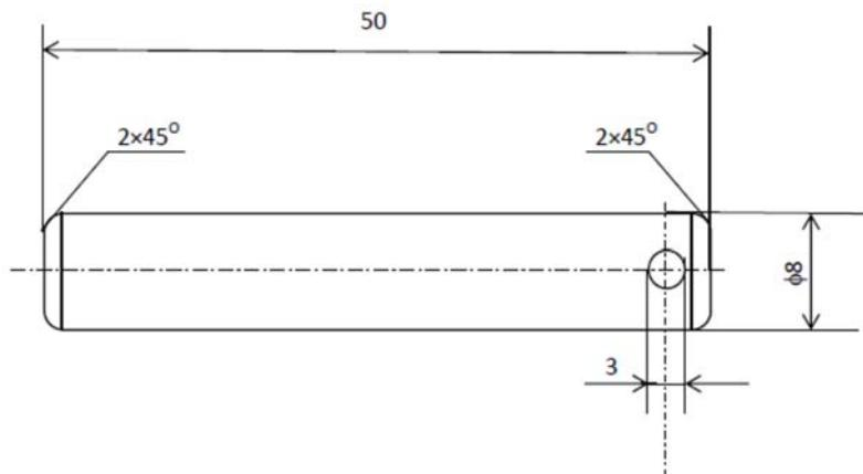
Slika 4.2. Dimenzije uzorka za bestrujno niklanje
