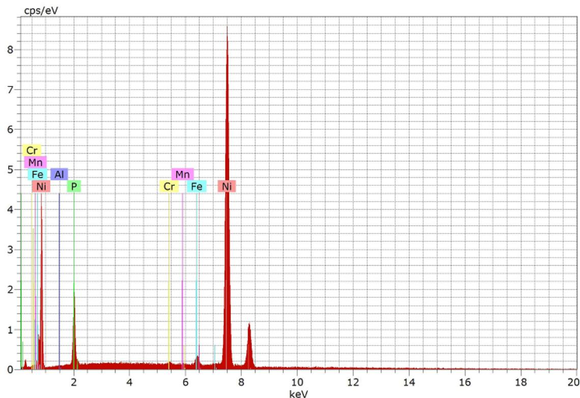
Slika 4.35. Prikaz kemijskog sastava uzorka Ni-P prevlake u točki A, na supstratu toplinski obrađenog uzorka na 400 °C
