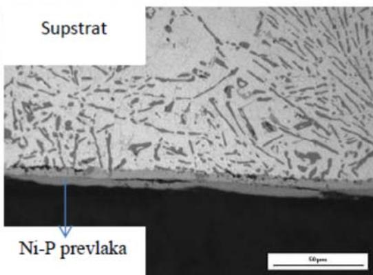
Slika 2.11. Presjek Ni-P prevlakе; grijano na temperaturi od  $550\text{ }^{\circ}\text{C}$  u trajanju 1 h (Novak i dr., 2009)
