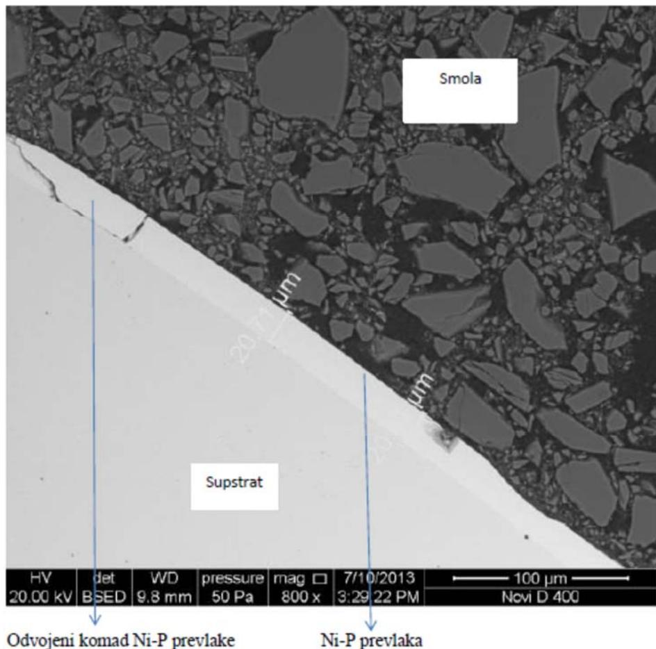
Slika 4.92. Debljina desne strane Ni-P prevlake na supstratu toplinski obrađenog uzorka na  $400^{\circ}\text{C}$
