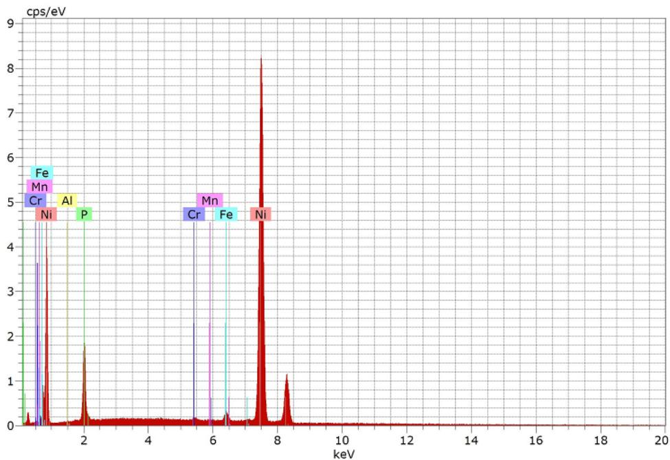
Slika 4.37. Prikaz kemijskog sastava uzorka Ni-P prevlake u točki B, na supstratu toplinski obrađenog uzorka na 400 °C
