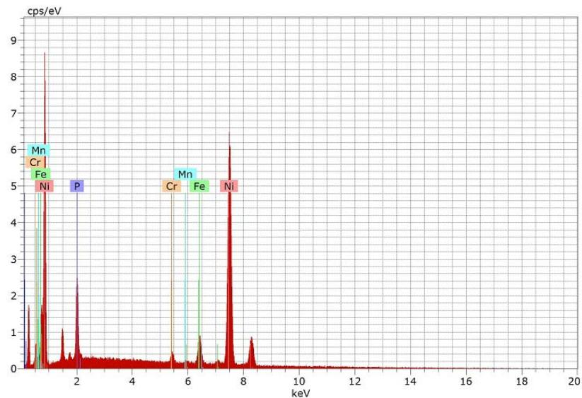
Slika 4.99. Prikaz kemijskog sastava uzorka Ni-P prevlake na supstratu toplinski obrađenog uzorka na 400 °C
