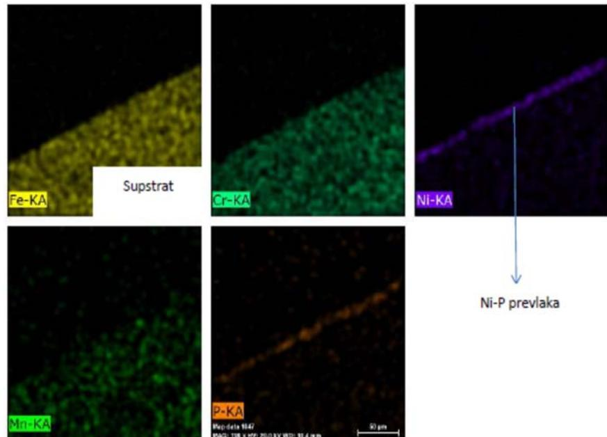
Slika 4.103. Raspodjela kemijskih elemenata na povrsini Ni-P prevlake i supstrata toplinski obrađenog uzorka na 500 °C
