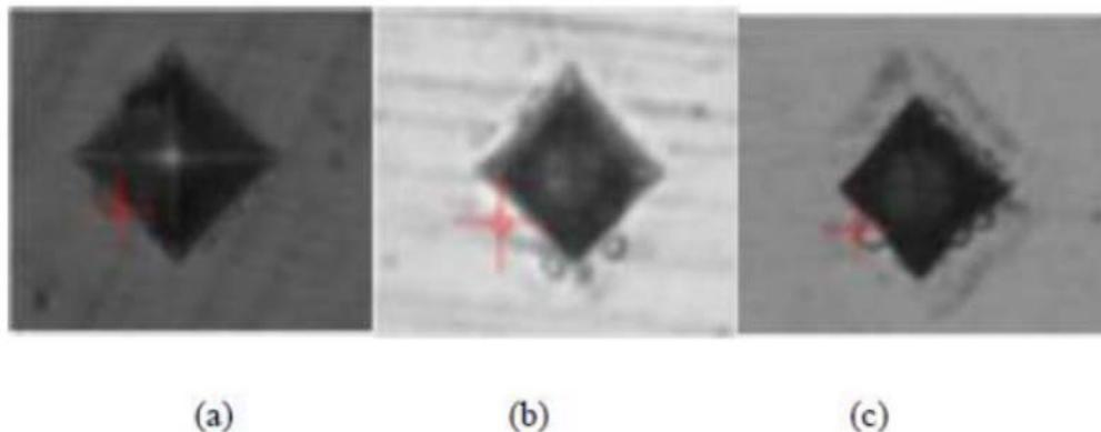
Slika 2.13. Otisak Ni-P prevlake nakon određivanja tvrdoće prema Vickersu, s različitim parametrima kupelji a) pH 8; 80 °C i 10 % fosfora, b) pH 8; 80 °C i 20 % fosfora, c) pH 6; 70 °C i 20 % fosfora (Arun i dr., 2013)
