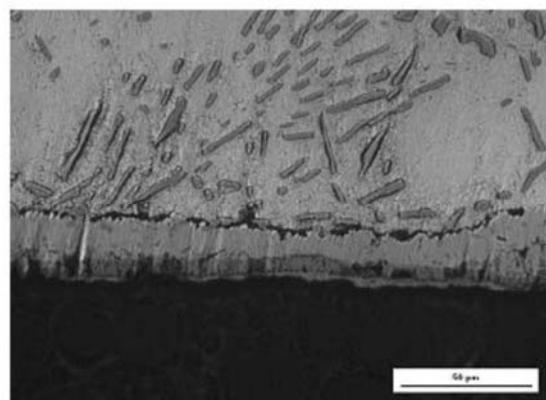
Slika 2.12. Presjek Ni-P prevlakе; grijano na temperaturi od  $550\text{ }^{\circ}\text{C}$  u trajanju 8 h (Novak i dr., 2009)
