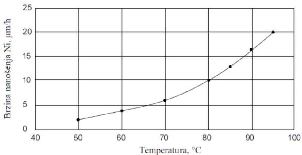
Slika 3.3. Utjecaj temperature na brzinu nanošenja nikla (Taheri, 2002)
