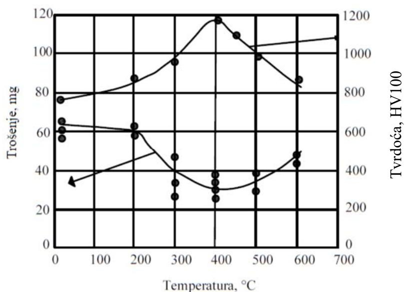
Slika 2.3. Utjecaj toplinske obrade na trošenje prevlake (Taheri, 2002)
