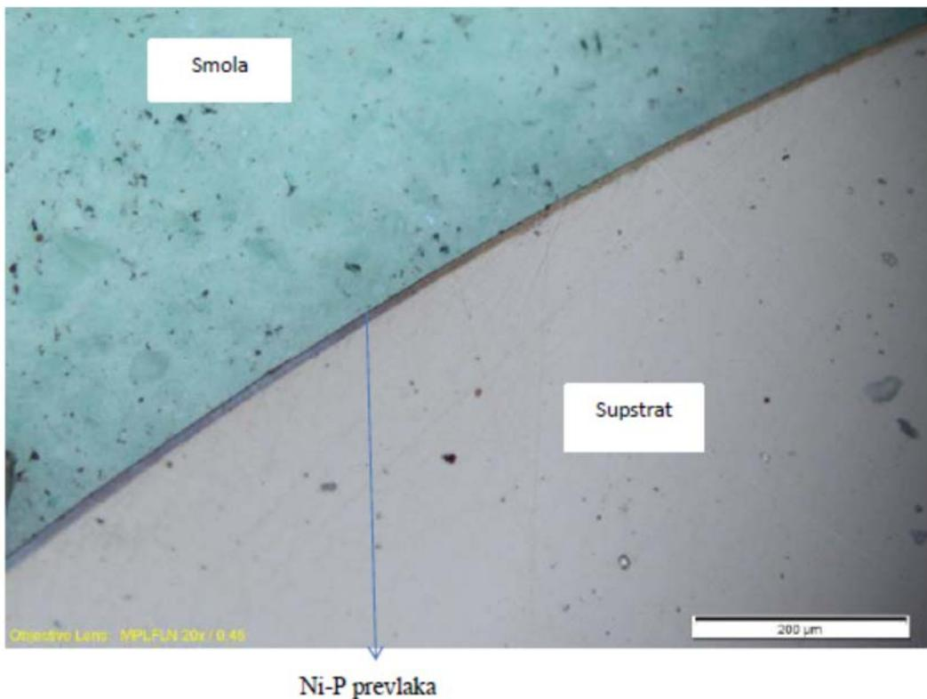
Slika 4.29. Ni-P prevlaka i supstrat toplinski obrađenog uzorka na 400 °C
