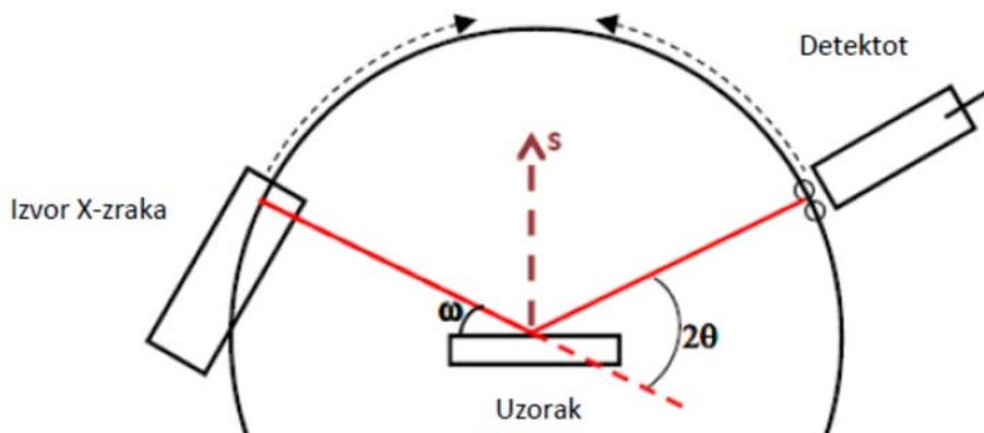
Slika 4.1. Analiza X-zrakama na principu Bragg-Brentano geometrije (Speakman, 2016)
