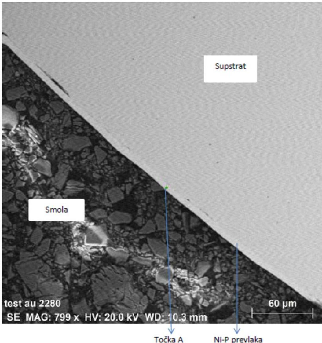
Slika 4.77. Kemijska analiza Ni-P prevlake na supstratu toplinski obrađenog uzorka na 200 °C u točki A
