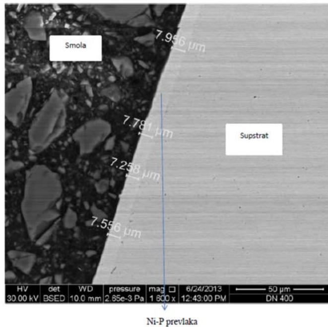
Slika 4.41. Debljina lijeve strane Ni-P prevlakе na supstratu toplinski obrađenog uzorka na  $500\text{ }^{\circ}\text{C}$
