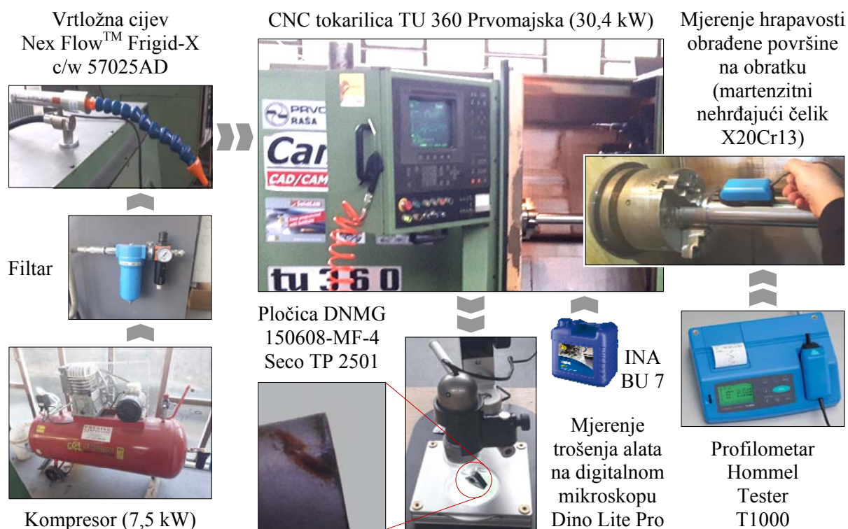
Slika 5.14. Eksperimentalna konfiguracija za ispitivanje obradivosti
