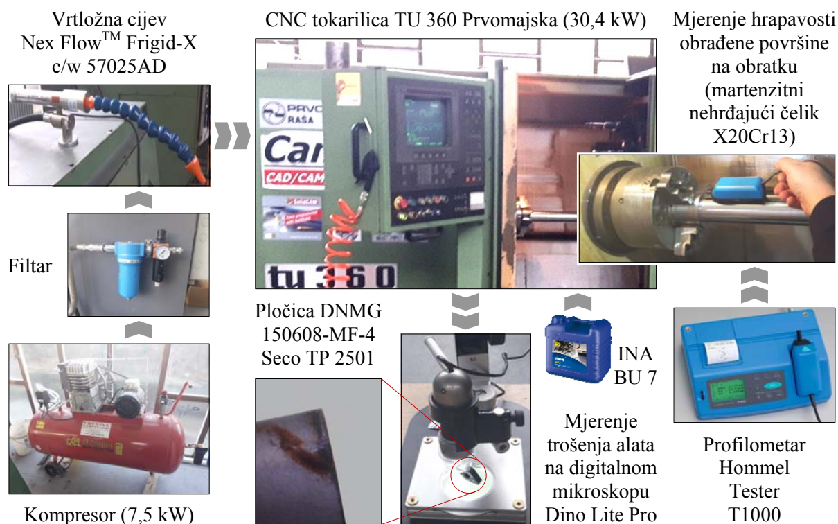
Slika 5.14. Eksperimentalna konfiguracija za ispitivanje obradivosti
