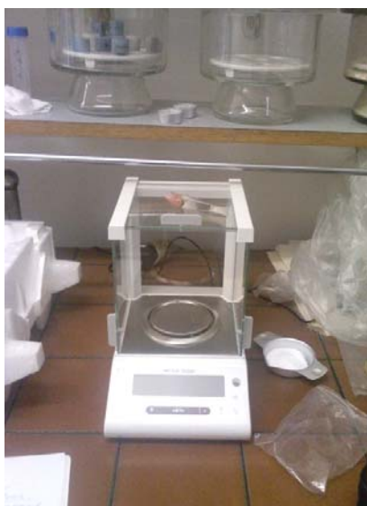
Slika 5.11. Laboratorijska vaga i uzorci (OS2, EM2 i VC2) uronjeni u elektrolit (3,5 %-tna vodena otopina NaCl temperature 25 °C)
