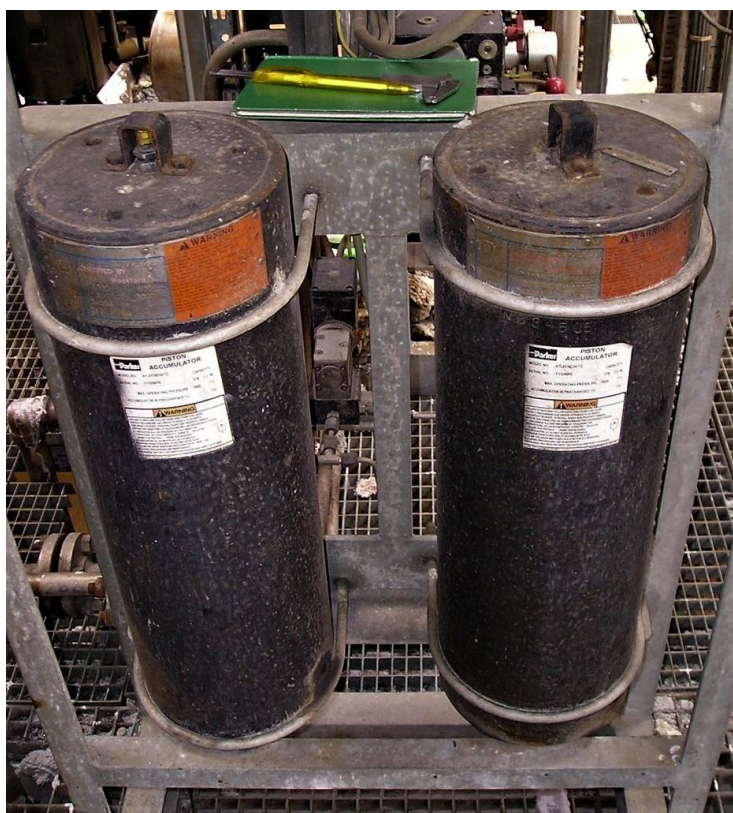
Slika 3-10 Hidraulički akumulatori unutar hidrauličkih jedinica
