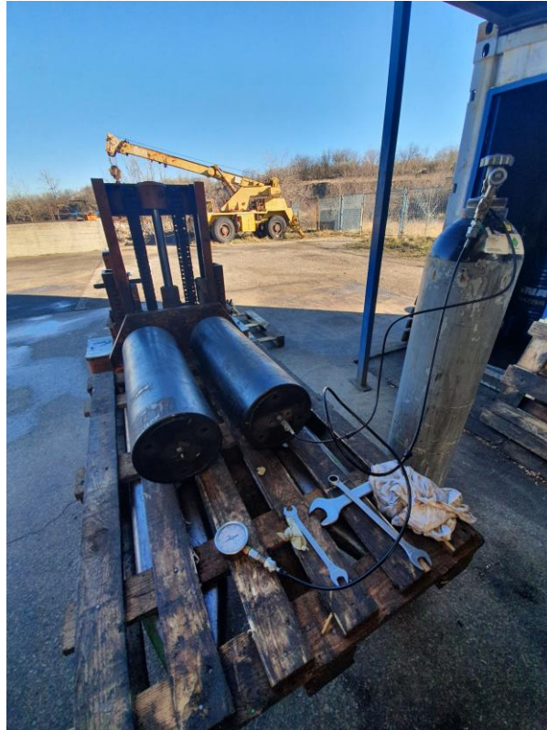
Slika 4-6 Ispitivanje hidrauličkih akumulatora
