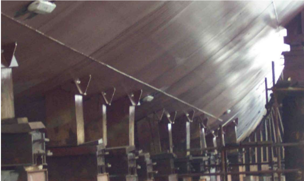
Slika 2-6. Izgled potporne strukture broda na navozu, prikaz 1. Izvor: autor
