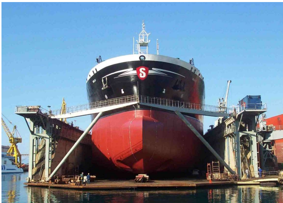
Slika 2-4. Brod u plutajućem doku, pogled na pramac. Izvor: autor
