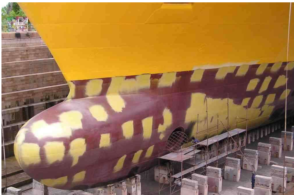
Slika 2-11. Izgled vanjske oplate nakon djelomičnog premaza. Izvor: autor
