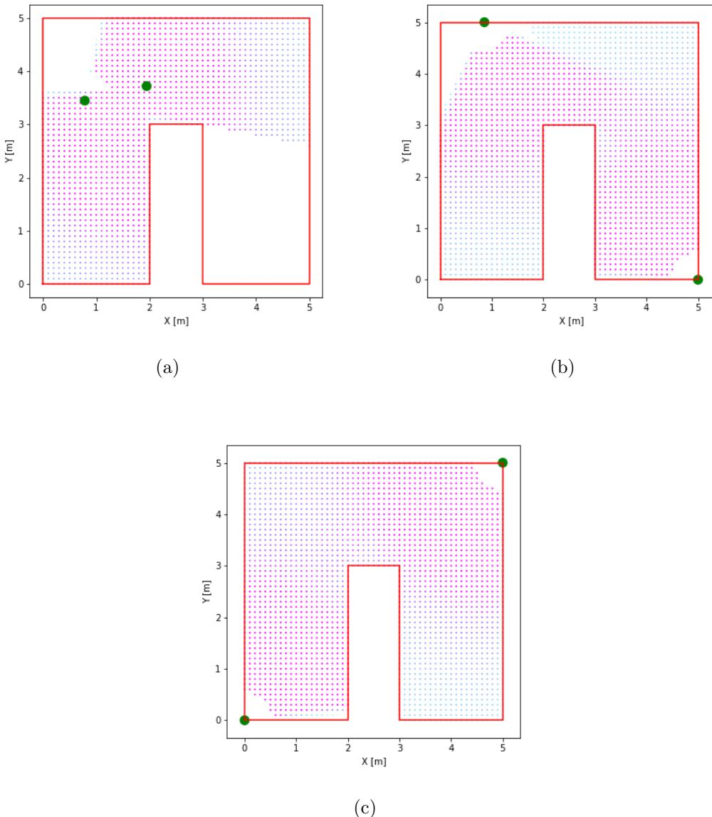
**Slika 8.9:** Primjer razmještaja dva usmjereni osjetila u dvodimenzionalnom modelu Ispitnog prostora 1
