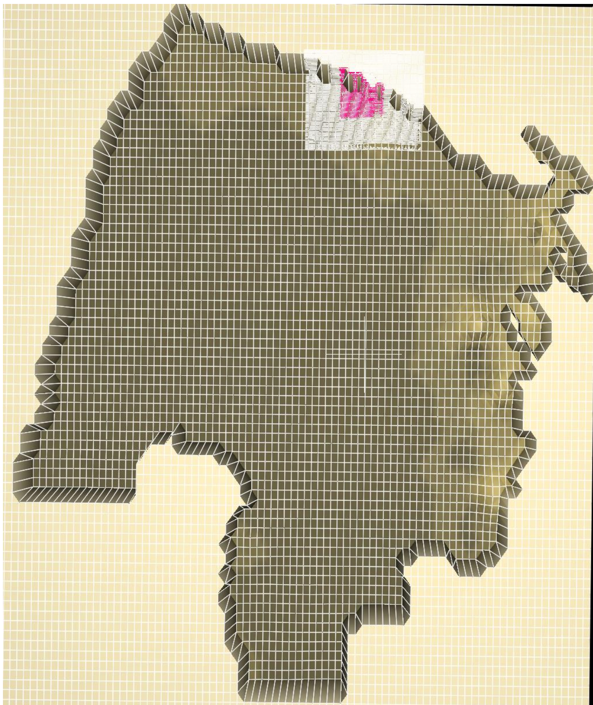
Slika 9. Prikaz tri mreže modela konačnih razlika: grube – bijele linije na tamnosmeđoj podlozi (165m X 232m) (prikazana svaka druga linija), fine – bijelo (55m X 77,33m) i najfinije – roza (18,33m X 25,77m)
