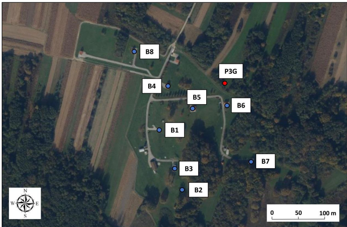
Slika 5-11 Prostorni raspored bunara i piezometara na vodocrpilištu Bartolovec
