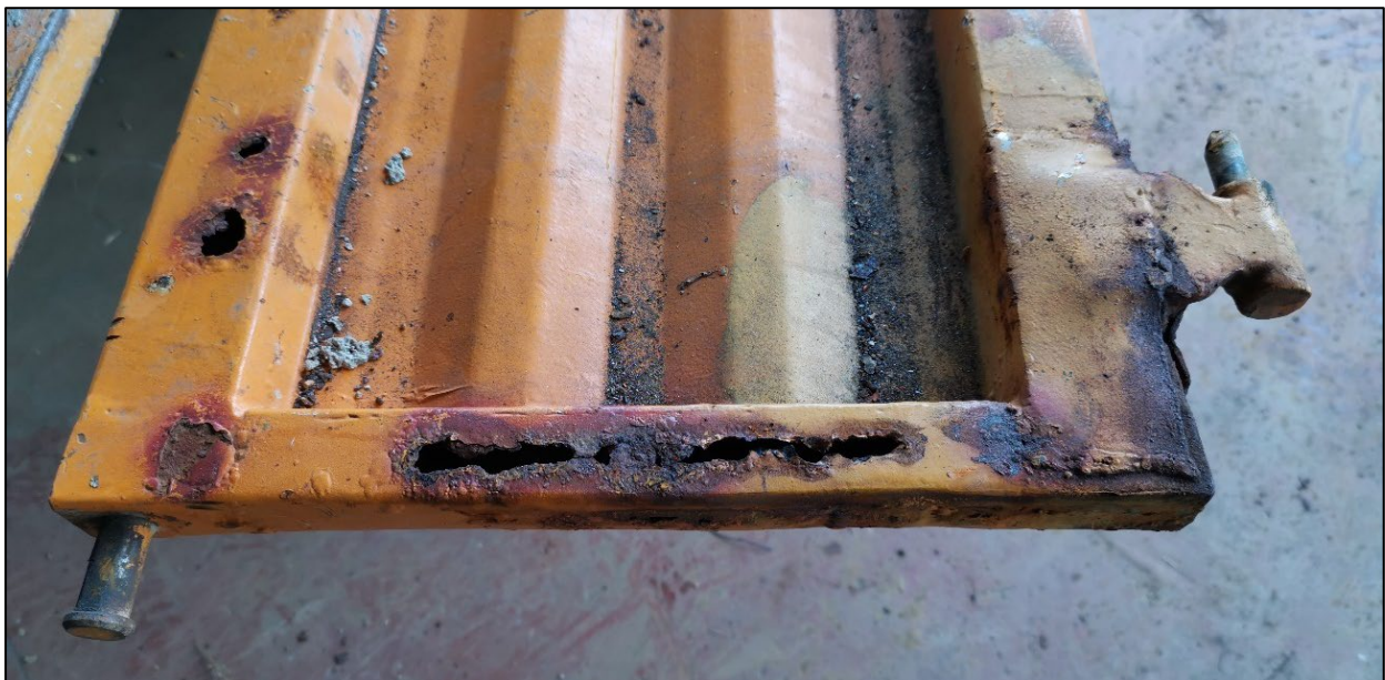
Slika 2.4. Korodirani dijelovi stranice dostavnog vozila [11]
