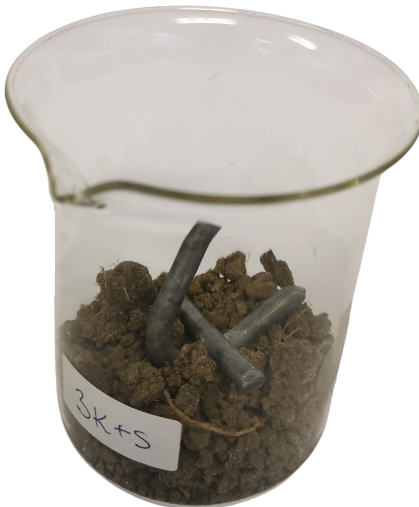
Slika 8.25. Postavljanje uzorka 3K+S u čašu
