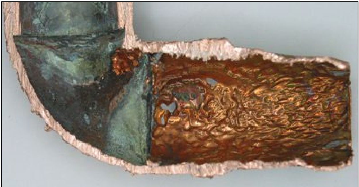
Slika 5.19. Erozijska korozija bakrene cijevi [51]
