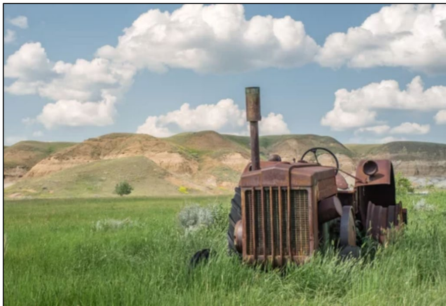
Slika 4.11. Korozija traktora u ruralnoj atmosferi [24]
