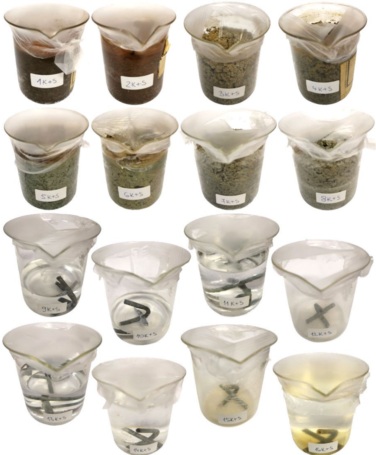
Slika 8.58. Čaše Križnog zavarenog spoja + savijeni dio na kraju eksperimenta
