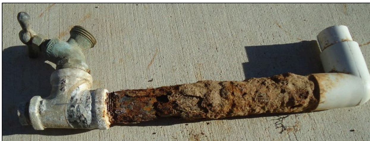
Slika 5.4. Galvanska korozija pocinčane čelične cijevi [41]
