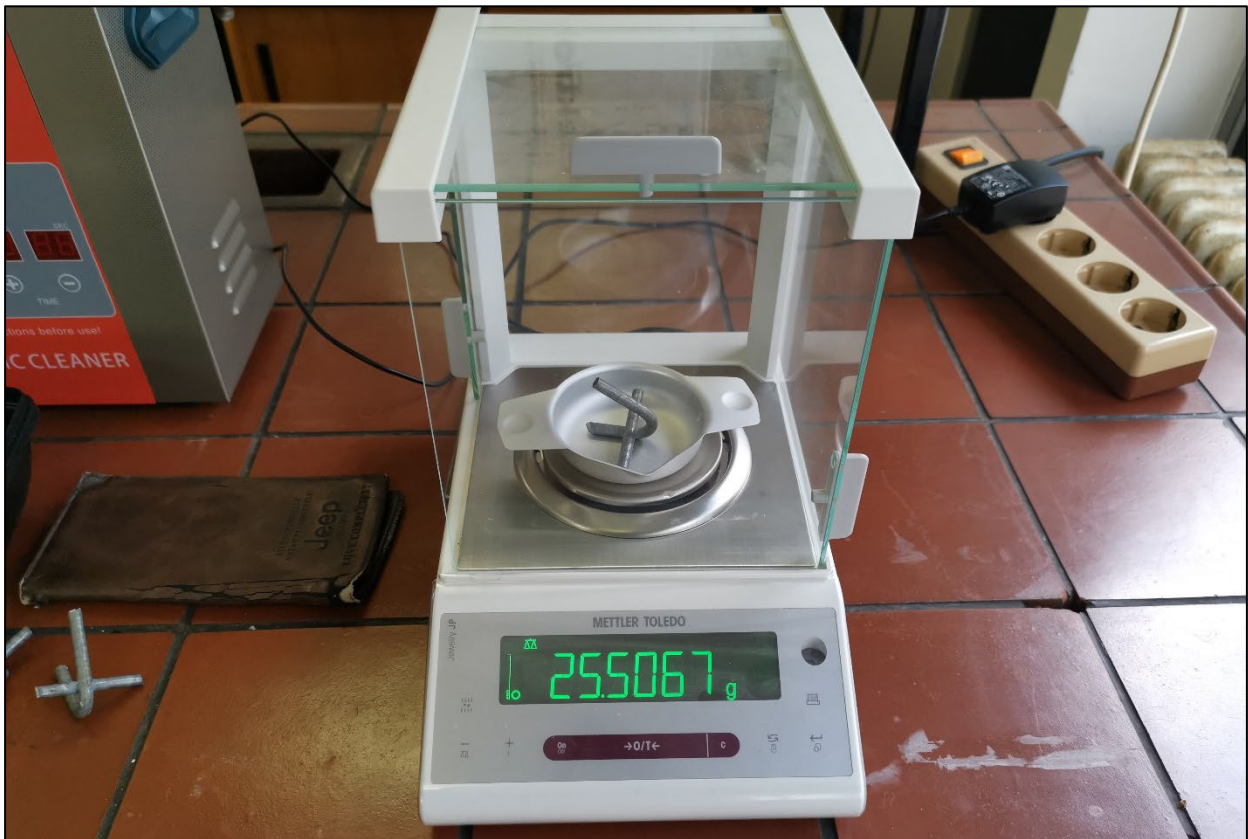
Slika 8.23. Mjerenje početne mase uzorka 15K+S
