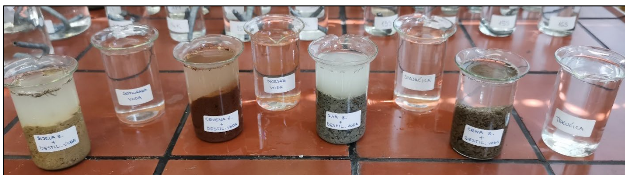
Slika 8.37. Priprema suspenzije zemlje u vodi i tekućine za mjerenje pH-vrijednosti
