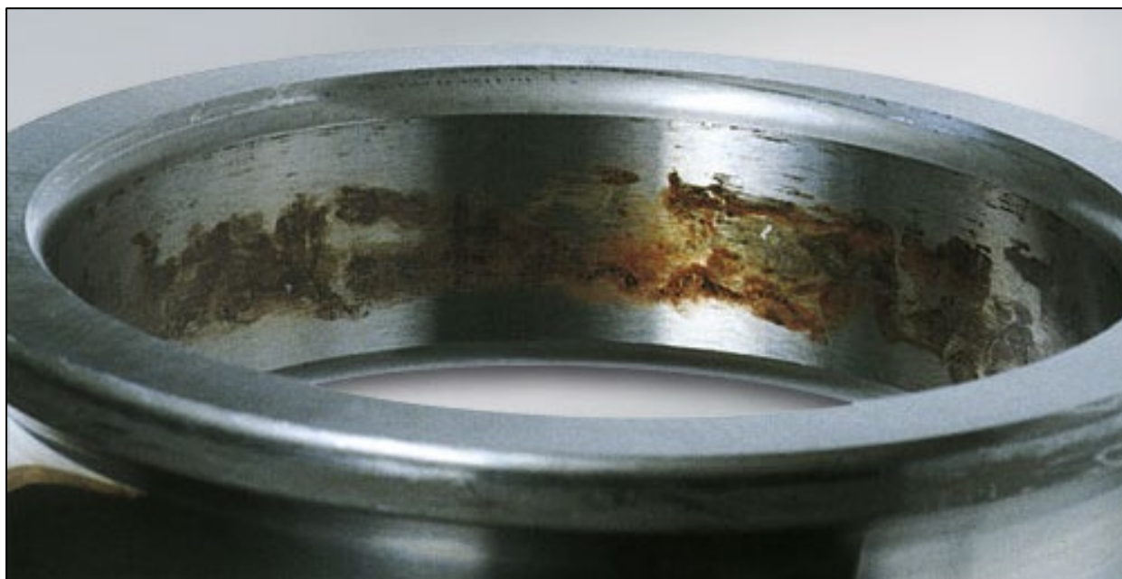
Slika 5.22. Tarna korozija unutarnjeg prstena jednorednog kugličnog ležaja [54]
