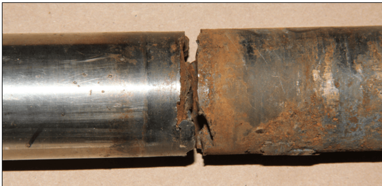
Slika 5.26. Lom vratila uzrokovan korozijskim zamorom [57]
