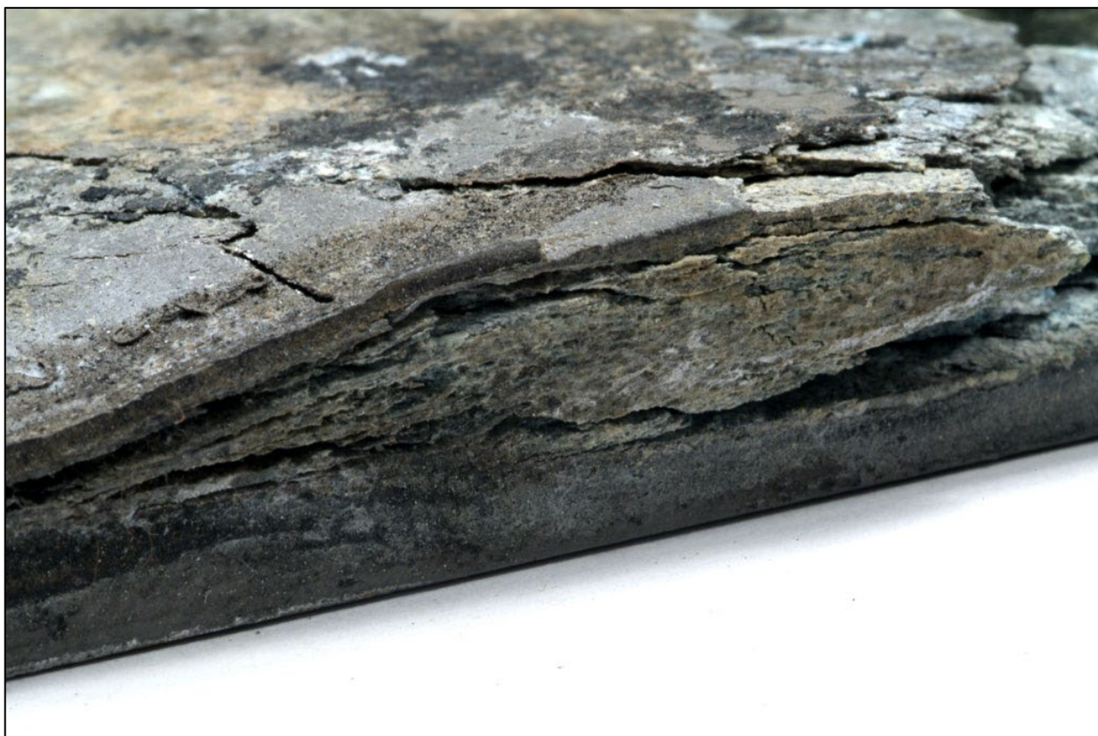
Slika 5.15. Eksfolijacija aluminija na zrakoplovu [47]
