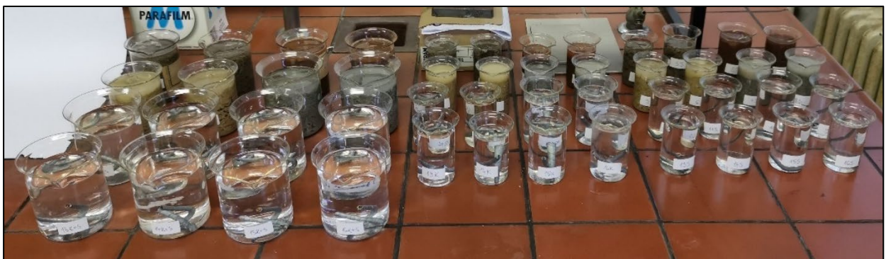
Slika 8.31. Napunjene čaše prije stavljanja laboratorijskog filma Parafilm®
