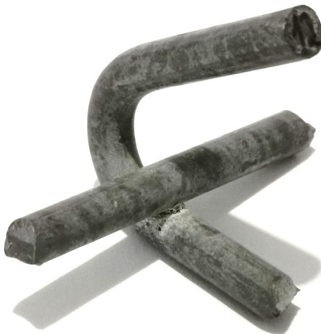
Slika 8.4. Križni zavareni spoj + savijeni dio
