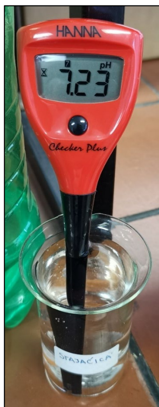
Slika 8.38. Mjerenje pH-vrijednosti vode pH mjerачem Hanna® Checker® Plus
