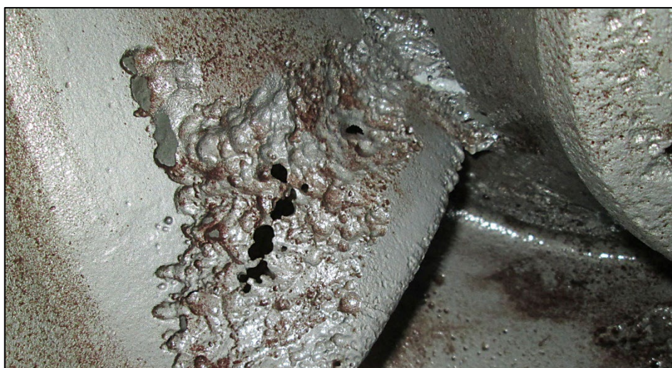
Slika 5.21. Kavitacijska korozija rotora pumpe [53]
