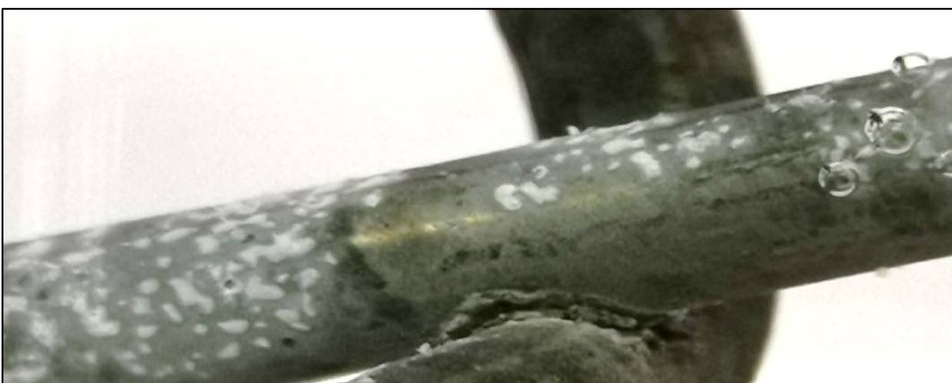
Slika 8.53. Četvrti pregled – 10K+S – nastavak kristalizacije morske soli na površini žice
