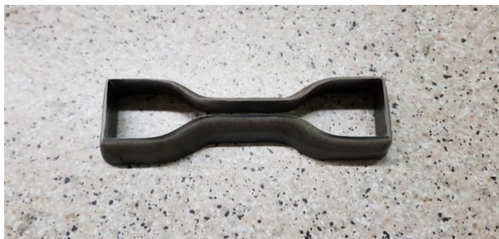
Slika 5.15 Alat za prosijecanje korišten prilikom pripreme uzoraka
