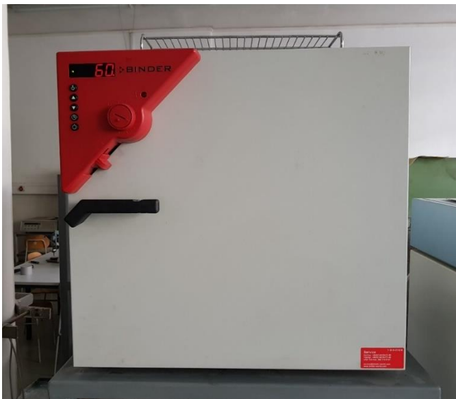
Slika 5.1 Sušenje polimera EOS PA12 2200
