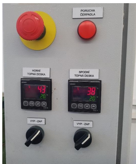
Slika 5.13 Prikaz radne temperature gornje i donje ploče preše
