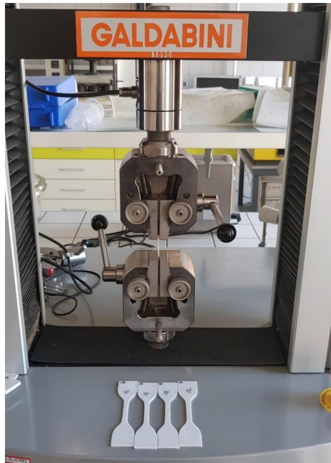
Slika 5.16 Ispitivanje vlačne čvrstoće
