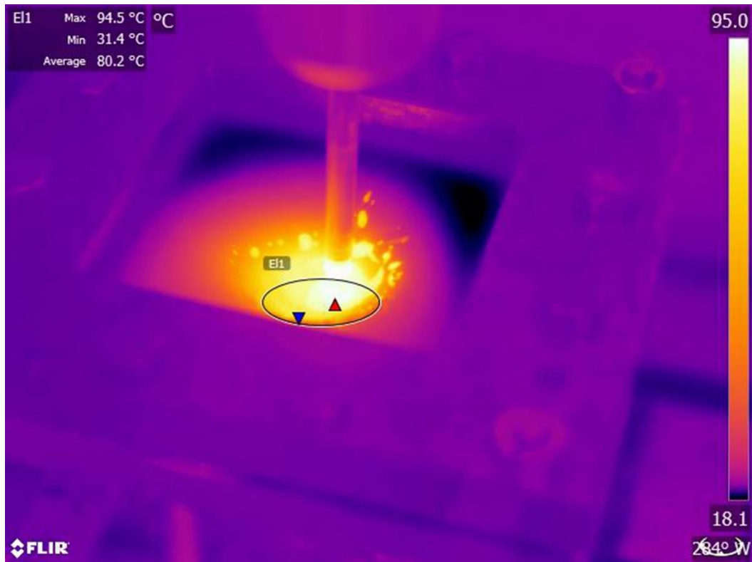
Slika 5.34 Maksimalna izmjerena temperatura za pokus broj 13 ( d = 8 \text{ mm} / PA12/Cloisite 93A-1% / \Delta z = 0,25 \text{ mm} / f = 1500 \text{ mm/min} / \omega = 2000 \text{ min}^{-1} / \psi = 40^\circ )
