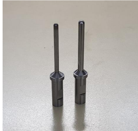
Slika 5.29 SPIF alati promjera 6 mm i 8 mm
