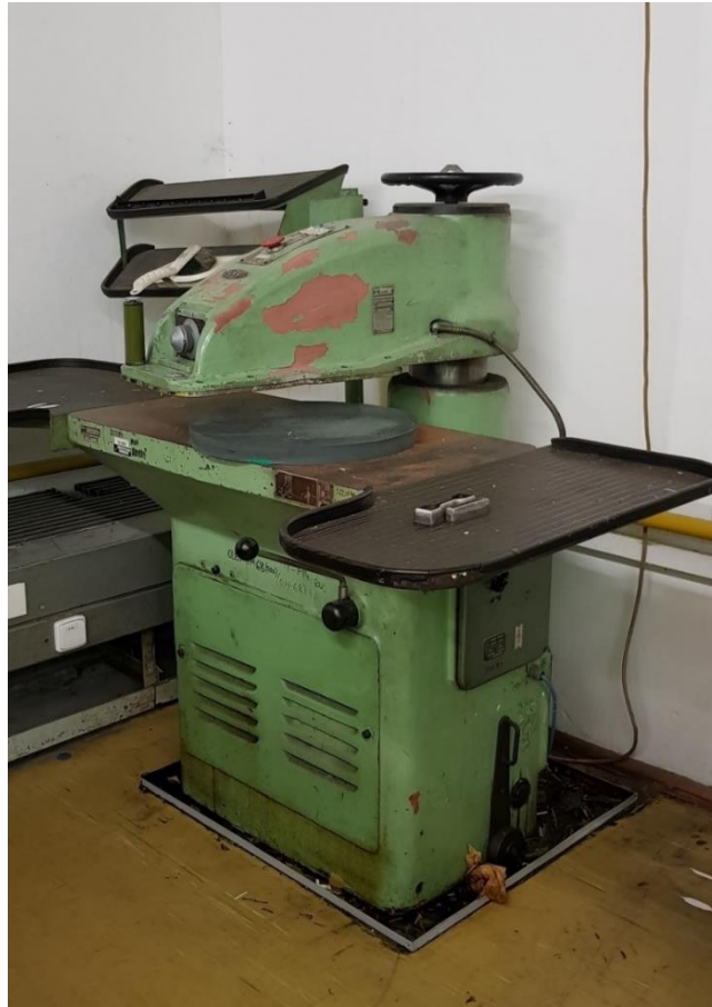
Slika 5.14 Hidraulička preša Svit za prosijecanje
