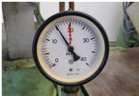
Slika 5.11 Prikaz radnog tlaka prešanja
