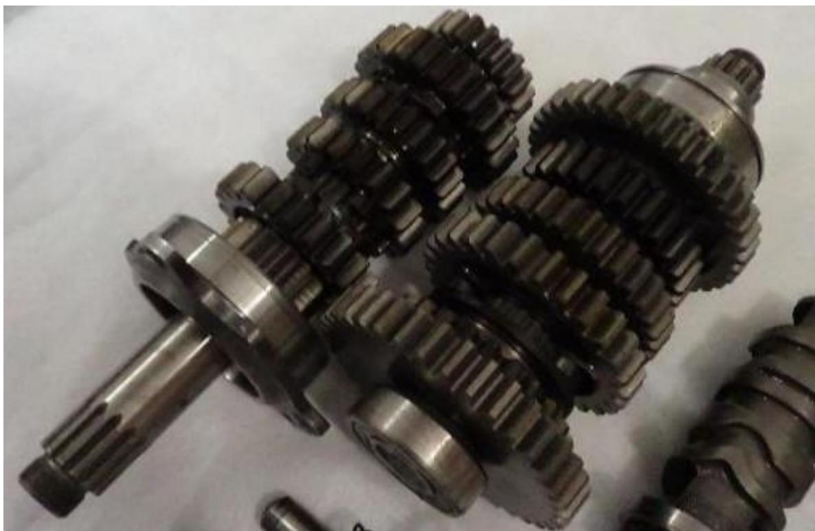
*Slika 2.3.4. Dijelovi mjenjača Yamaha R6 [12]*
