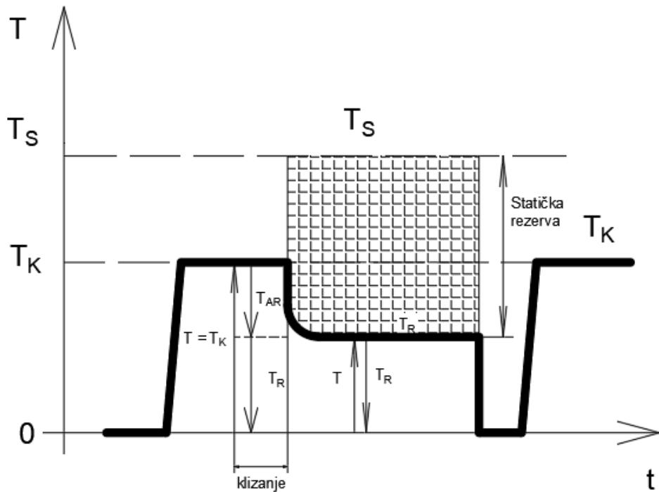
Slika 2.1. Pojednostavljeni dijagram momenta na spojci
