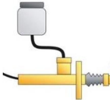
Slika 1.4. Prikaz sklopa hidrauličkog aktuatora kod automobila [3]
