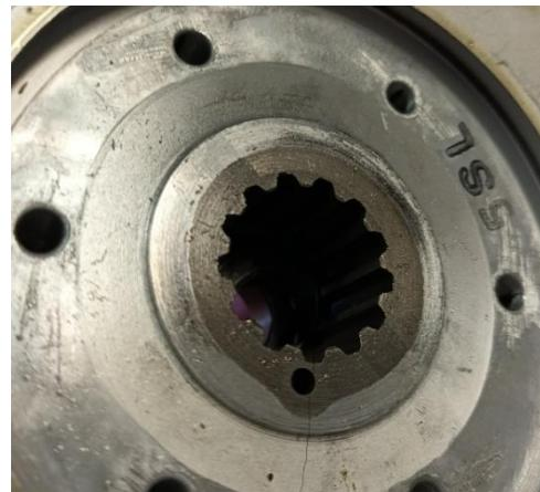
*Slika 3.1.2. Prikaz utora za ulazno vratilo mjenjača spojke motocikla Yamaha R6*
