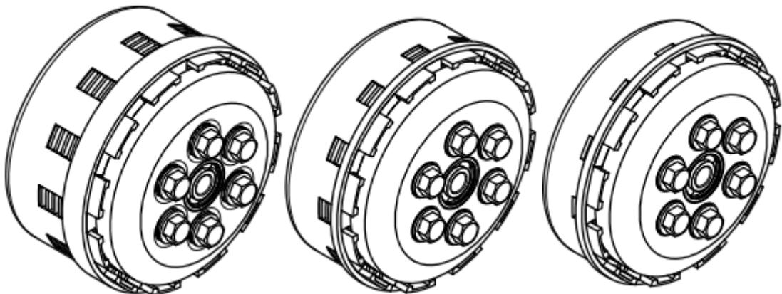
Slika 7.1. Prikaz konstrukcije različitih izvedba motociklističkih spojki u izometriji
