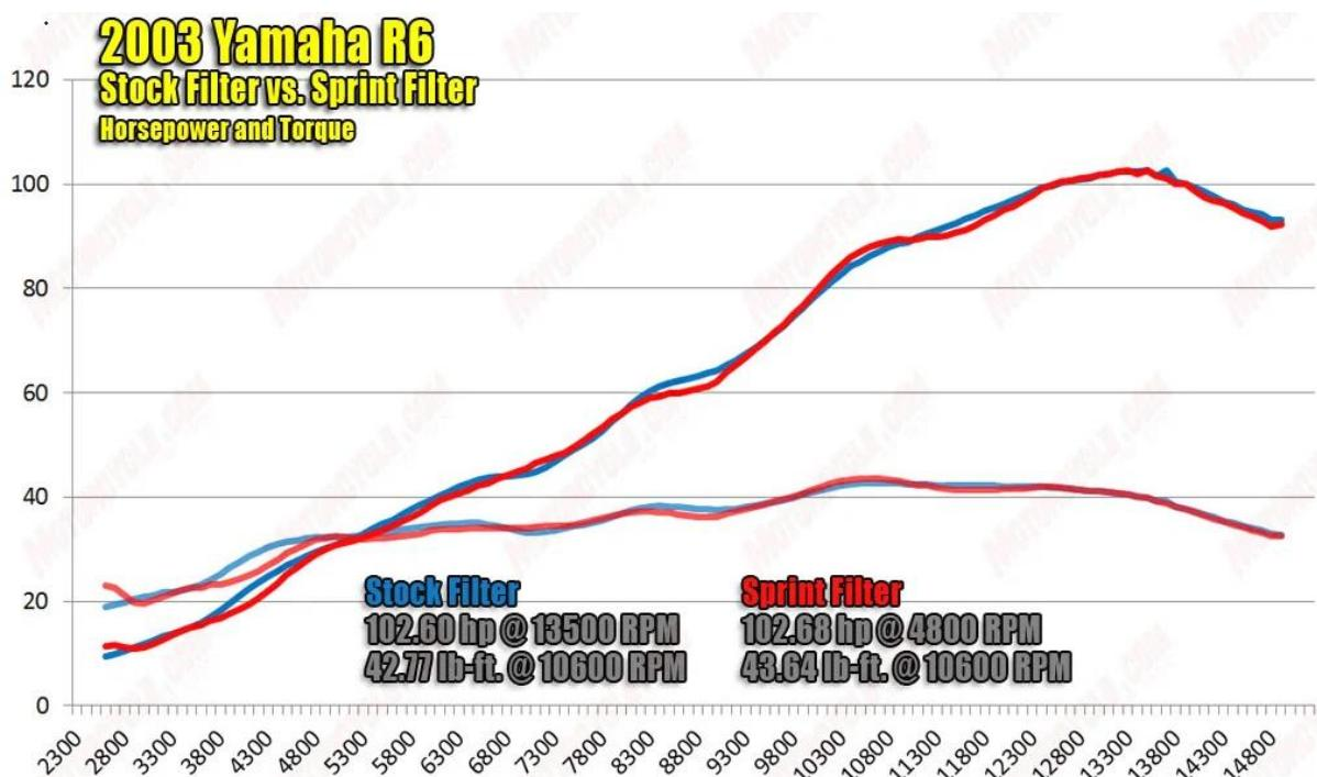
Slika 3.1.1. Prikaz krivulje momenta i snage motocikla Yamaha R6 sa tvorničkim filterom [14]
