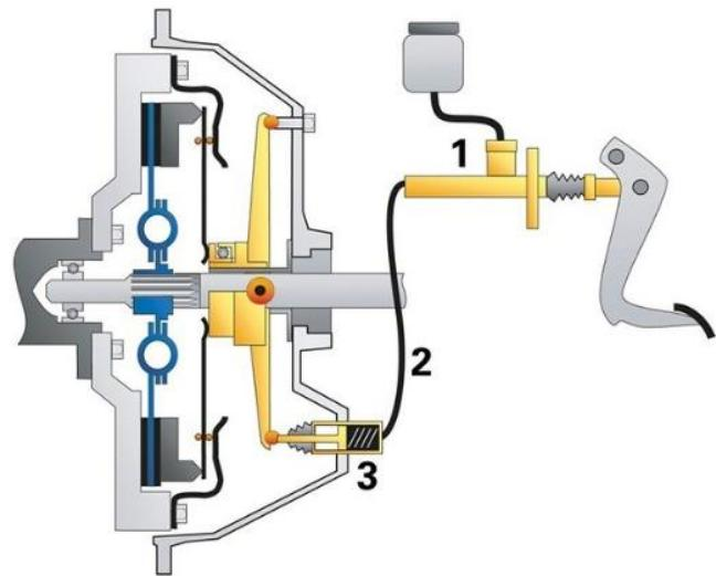
2.1.3.4. Hidraulički sustav aktivacije spojke Sachs [3]
