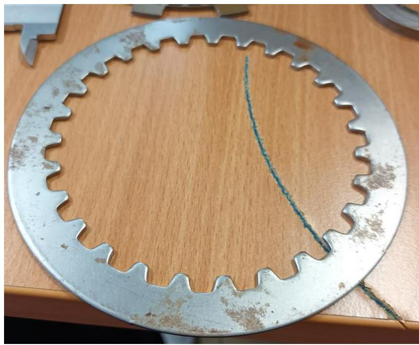
2.2.3. Prikaz unutarnje čelične lamele sa unutarnjim ozubljenjem
