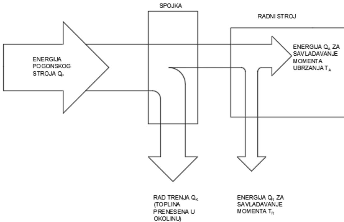
*Slika 2.1. Bilanca energije kod jednog uključivanja spojke*
