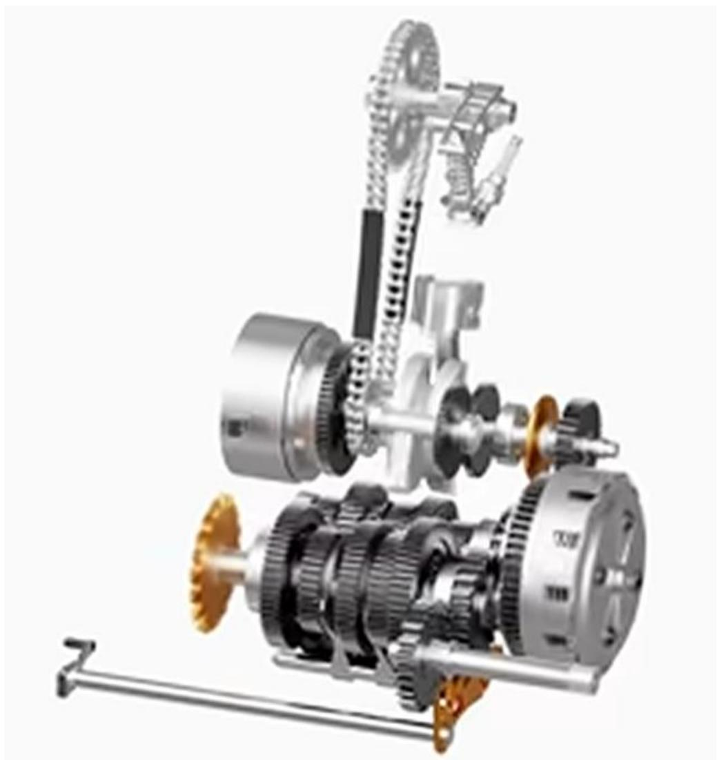
Slika 2.3.5. Općeniti prikaz cjelokupnog sklopa transmisije snage kod motocikla [13]
