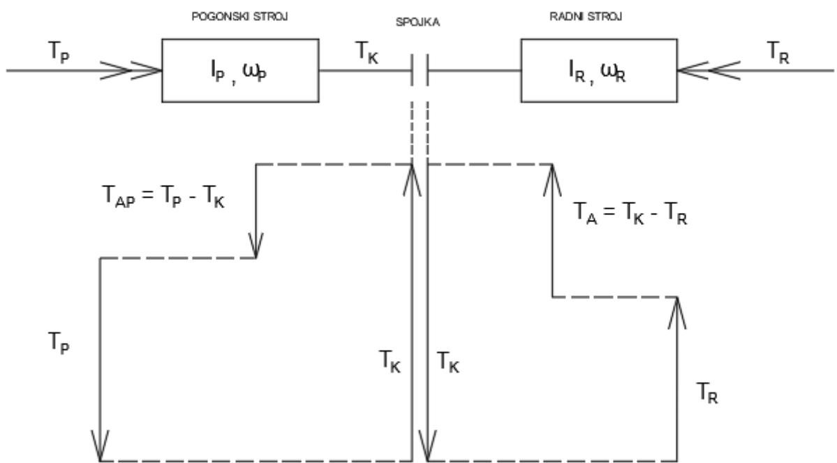
Slika 2.1. Pojednostavljena shema režima rada spojke
