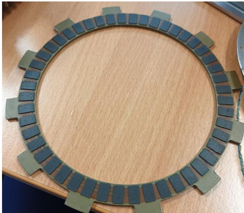
2.2.4. Prikaz vanjske čelične lamele sa vanjskim izdancima i oblogama od čelika
