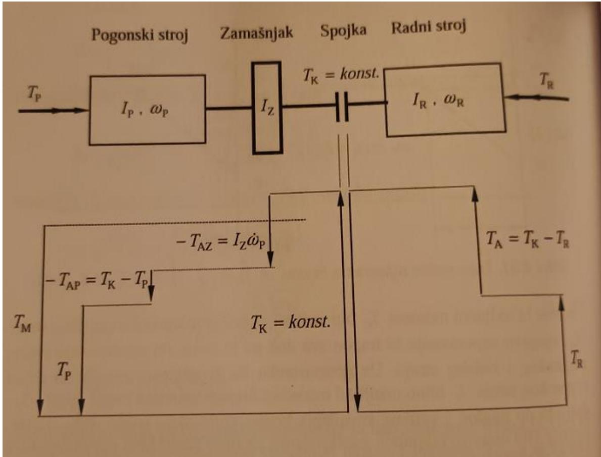
Slika 2.1. Dijagram momenta spojke sa zamašnjakom [7]
