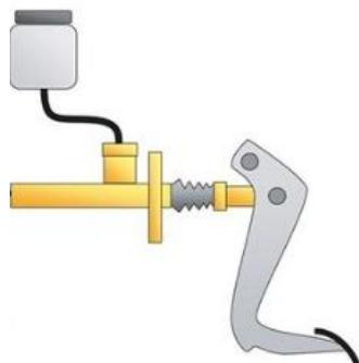
*Slika 1.2. Prikaz aktuacijskog sustava za automobile [3]*
