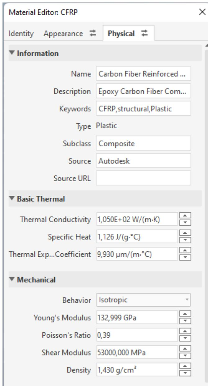
Slika 3.3.16. Toplinska i mehanička svojstva ugljičnih vlakna „CFRP“
