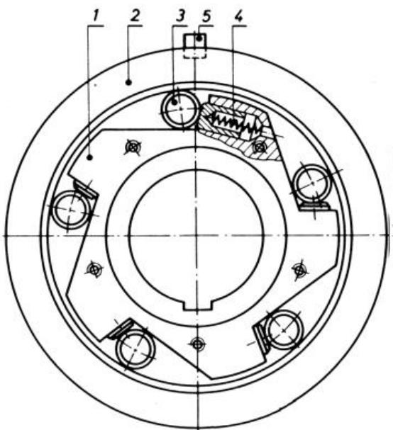
Slika 2.3.2. Primjer sklopa jednosmjerne tarne spojke [6]
