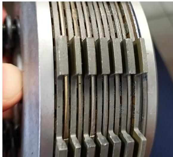
Slika 3.1.10. Prikaz tarnih ploha u kontaktu motociklističke spojke Yamaha R6
