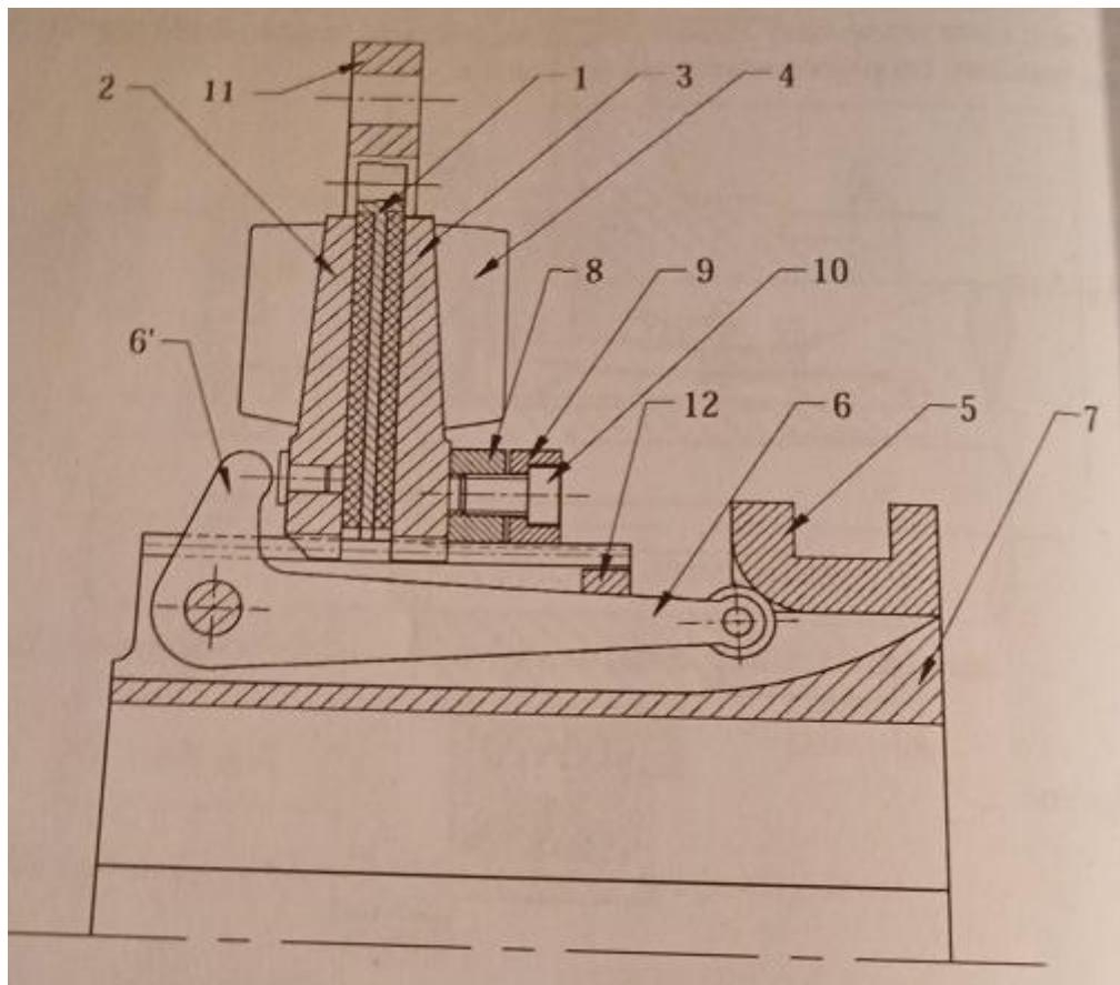
Slika 2.1.2.1. Jednolamelna tarna spojka za alatne strojeve [7]
