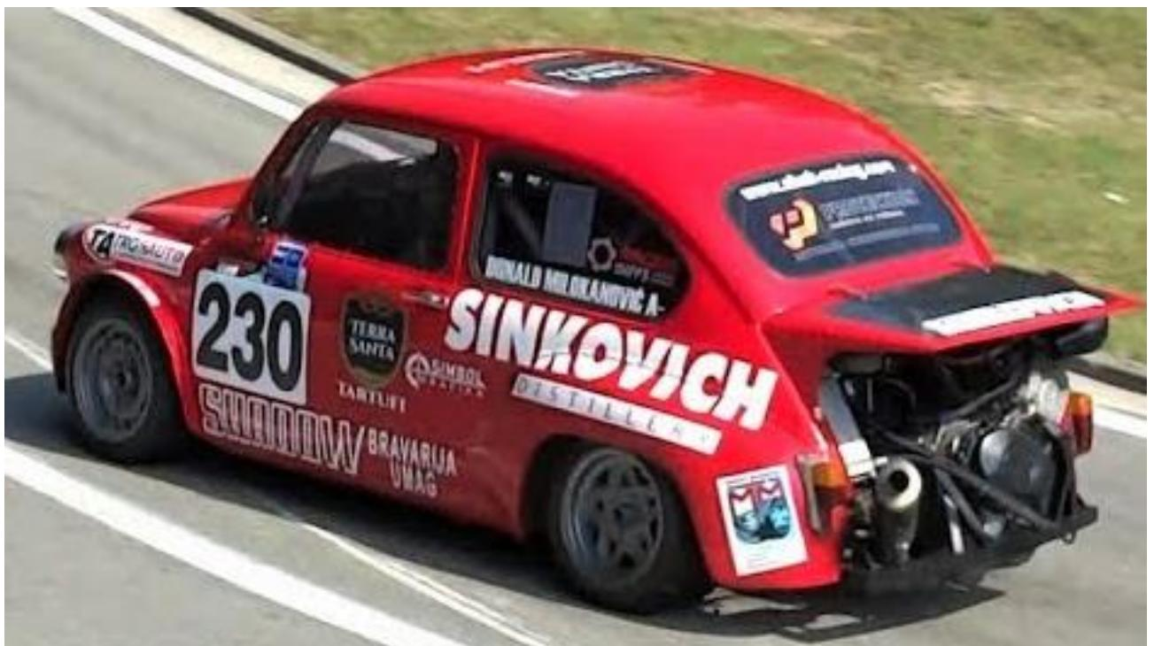
Slika 1.2. Trkači automobil Fiat 600 sa ugrađenim sustavom motocikla Suzuki GSX-R 1000 [2]
