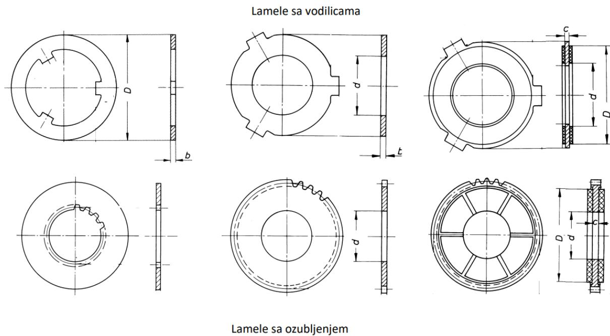
Slika 2.1. Podjela lamela prema načinu aksijalnog vođenja [6]
