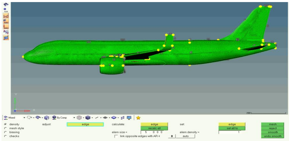
Slika 3.11 Airbus A320 opisan numeričkom mrežom u sučelju programa HyperMesh
