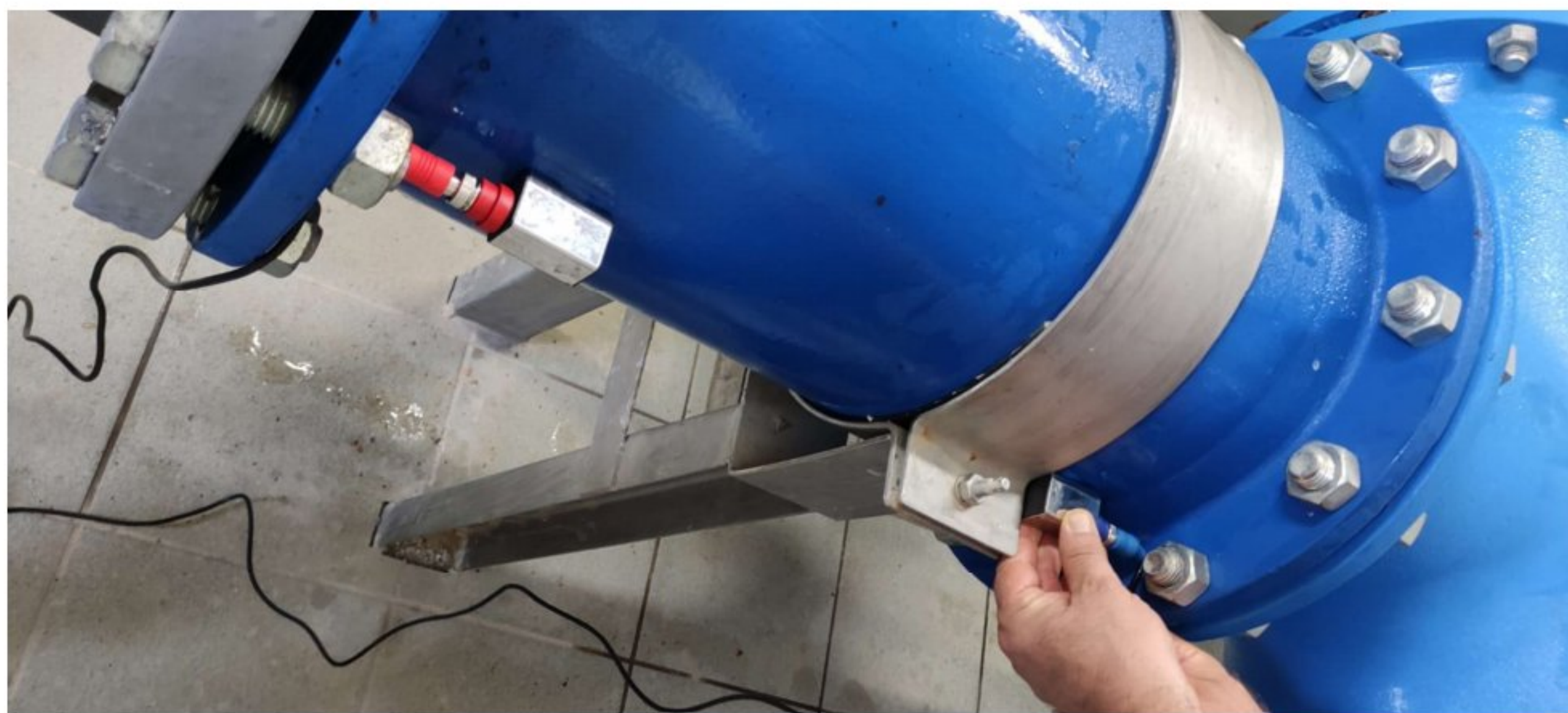
Slika 11: Postavljanje sondi na određenu udaljenost na cijev
