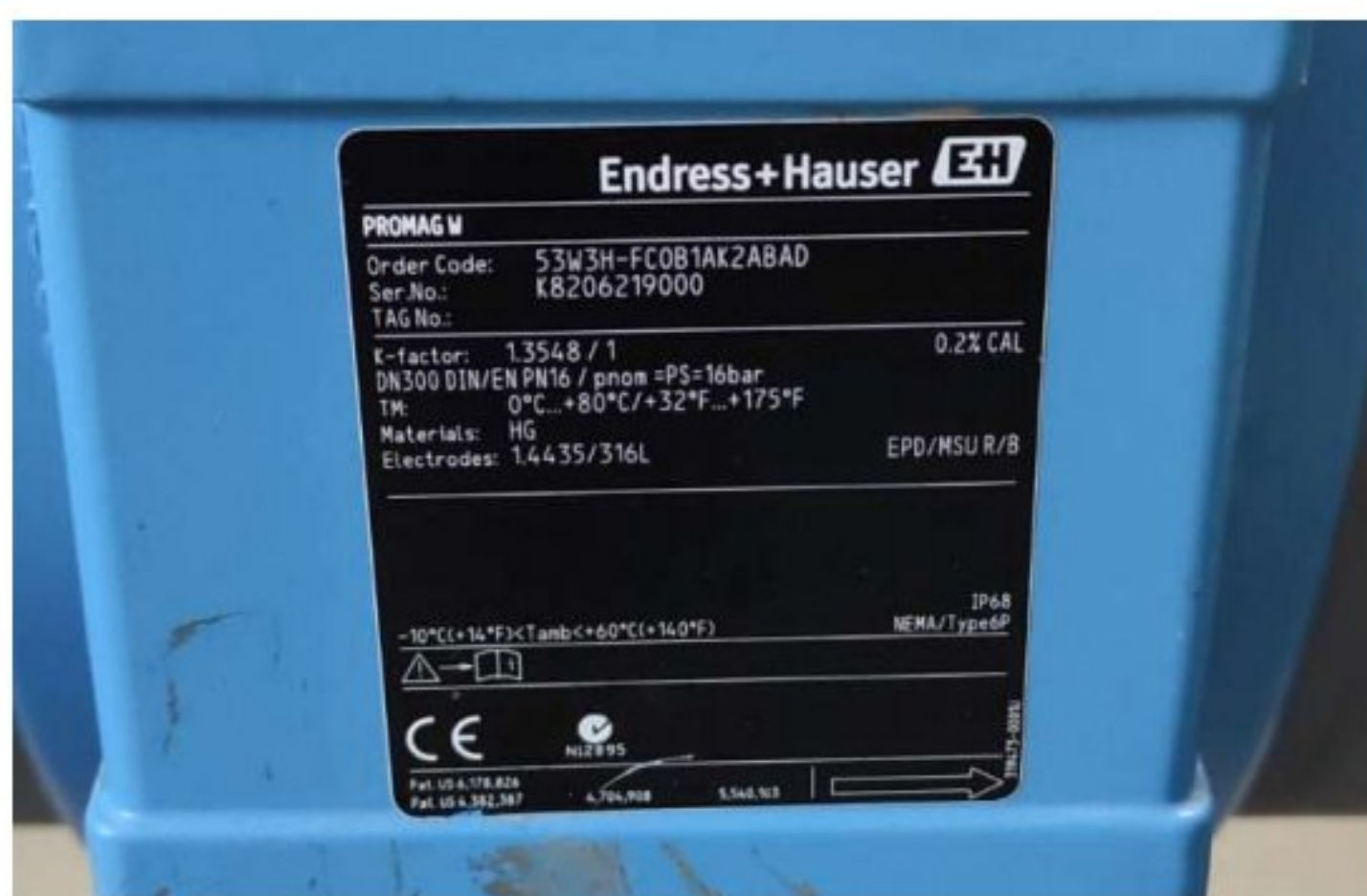
Slika 2: Podaci elektromagnetskog mjerača protoka Endress+Hauser
