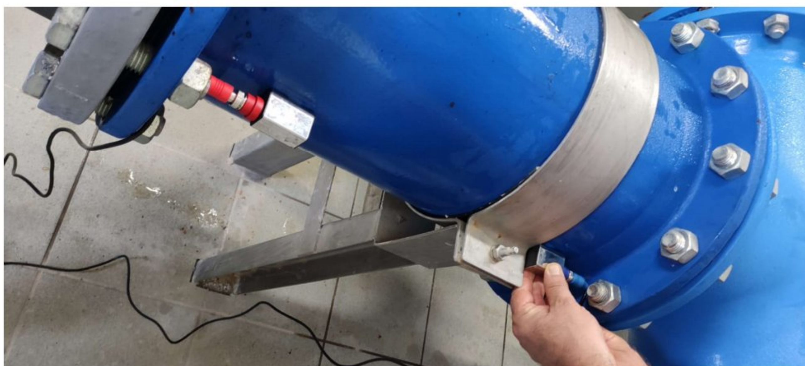
Slika 11: Postavljanje sonde na određenu udaljenost na cijev
