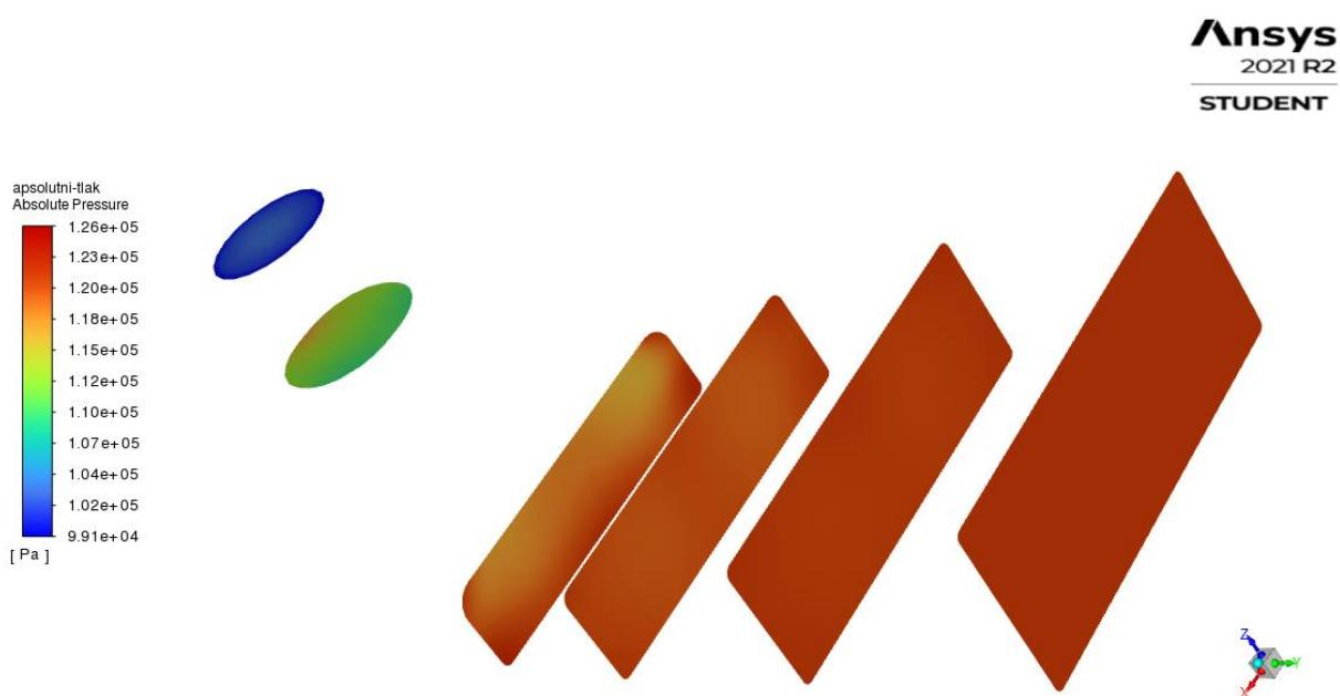
*Slika 5.14. Konture absolutnog tlaka po presjecima*
