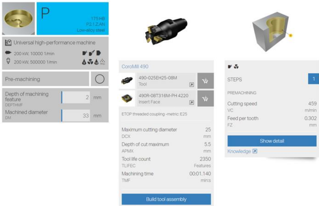
Slika 4.28 Izbor alata i režimi obrade - operacija 20, zahvat 5
