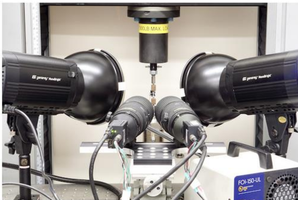
Slika 7.16: Pravilno postavljeni sustav za snimanje slike [16]
