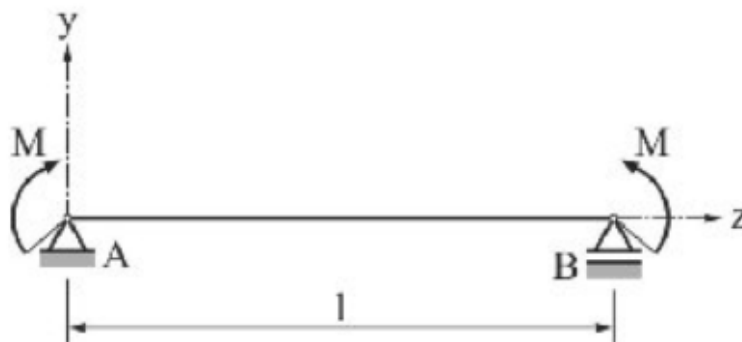
Slika 2.8: Nosač opterećen na ravno čisto savijanje [6]
