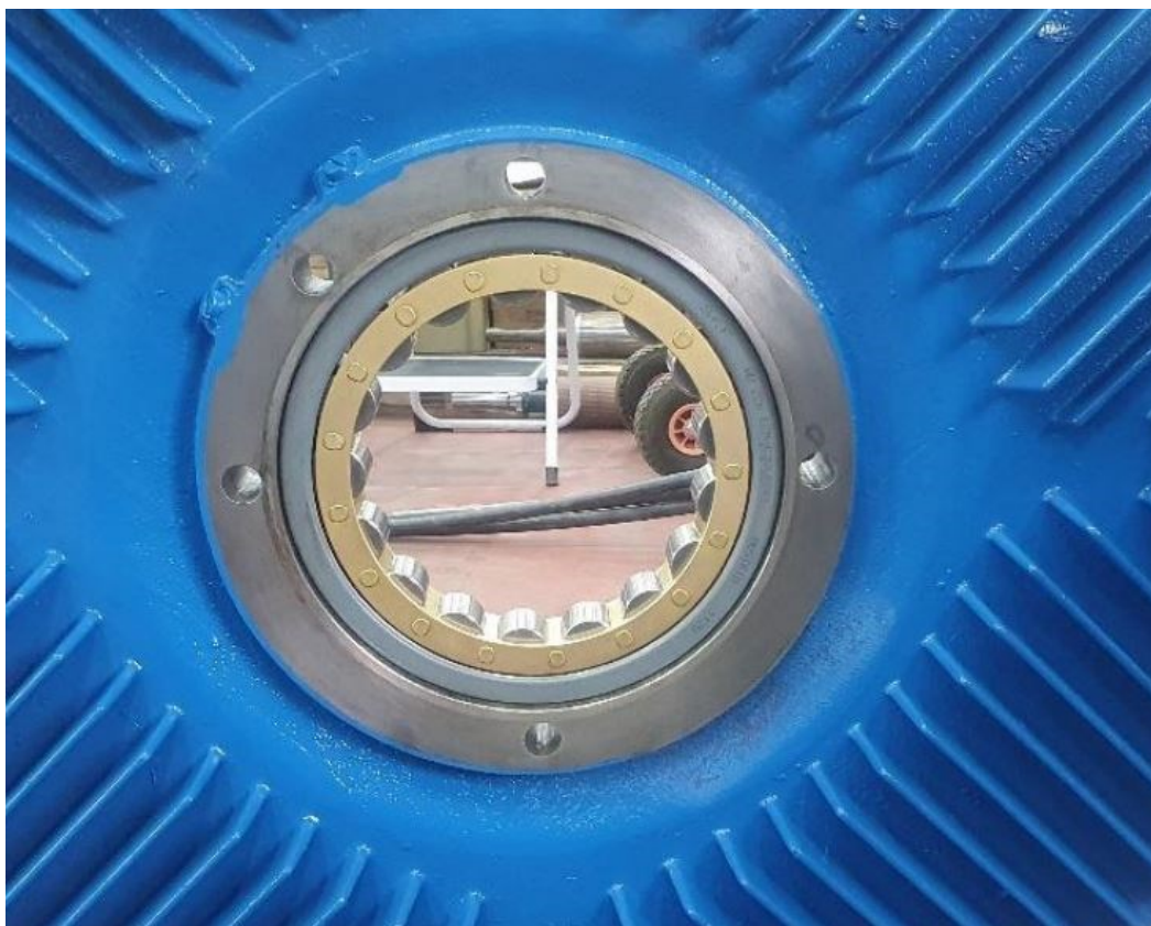
Slika 7.4. Montaža novog ležaja s keramičkom oblogom
