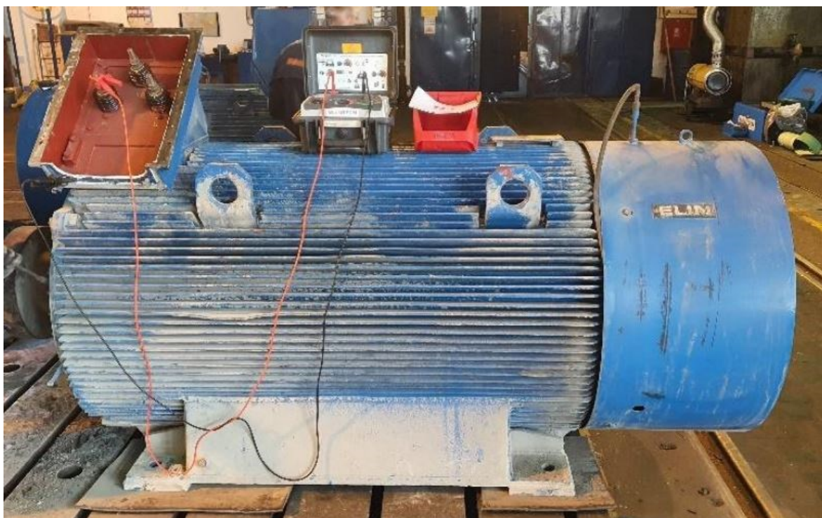
Slika 7.5. Mjerenje otpora izolacije namota statora
