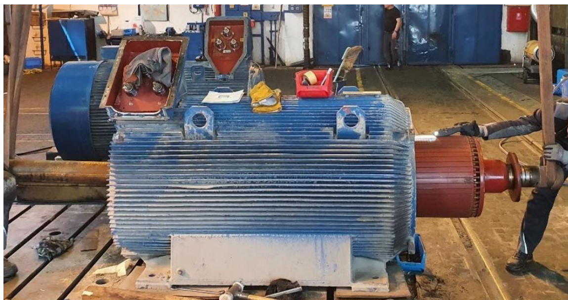
Slika 7.2. Vađenje rotora iz kućišta
