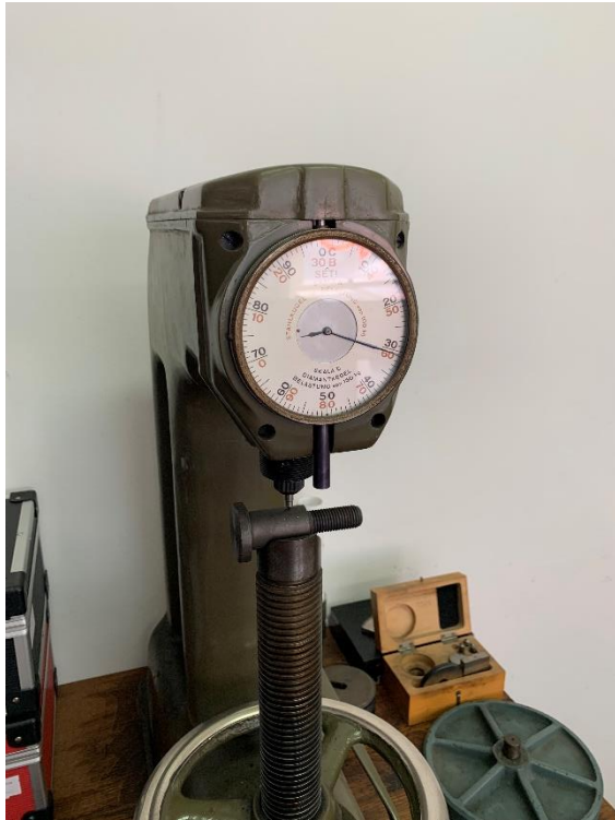
Slika 4.18. Ispitivanje tvrdoće na obodu nakon visokotemperaturnog popuštanja
