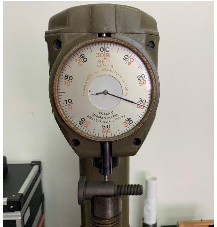
Slika 4.18. Ispitivanje tvrdoće na obodu nakon visokotemperaturnog popuštanja
