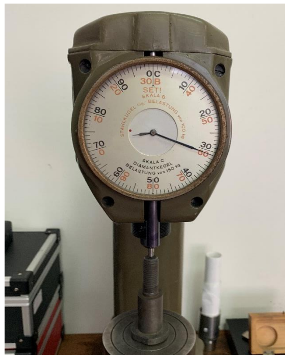
Slika 4.19. Ispitivanje tvrdoće na čeonj strani nakon visokotemperaturnog popuštanja
