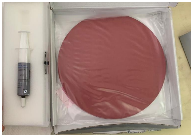
Slika 5.17. Podloga za poliranje (desno) i dijamantna pasta (lijevo)
