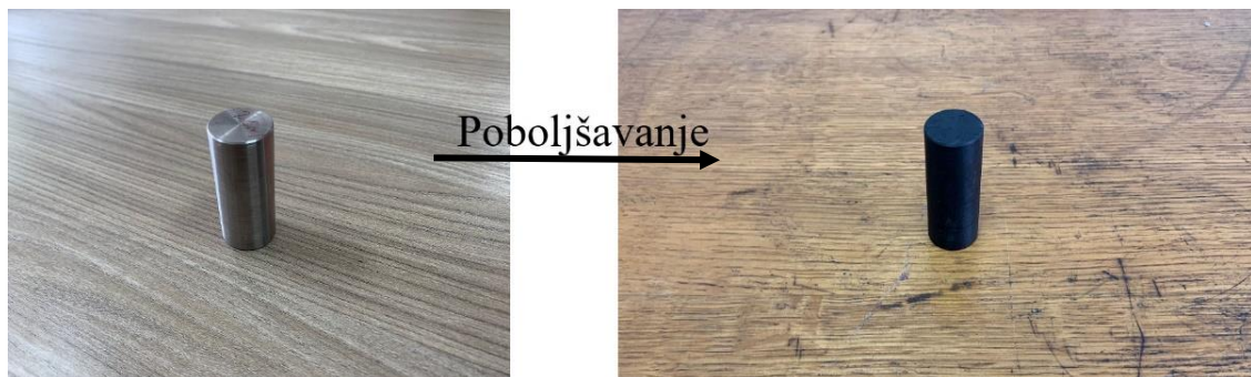
Slika 5.11. Strojni dio prije i poslije poboljšavanja
