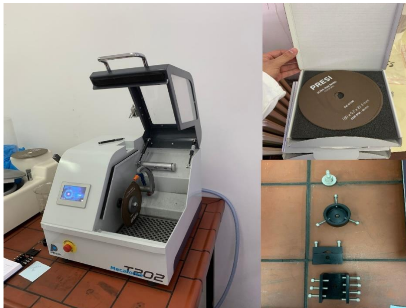
Slika 5.12. Mecatome T202, rezna ploča i stezne naprave
