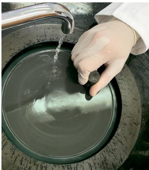
Slika 5.14. Uređaj za brušenje s pričvršćenim brusnim papirom
