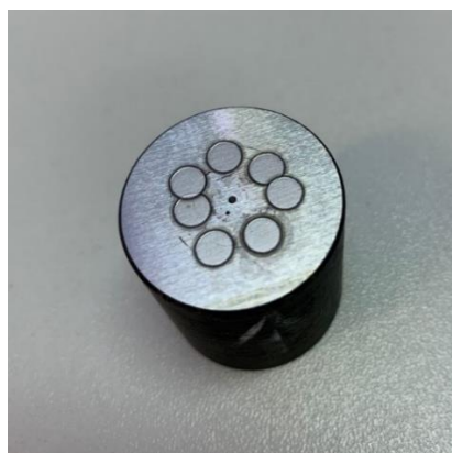
Slika 5.24. Ispitni uzorak nakon spektrofije
