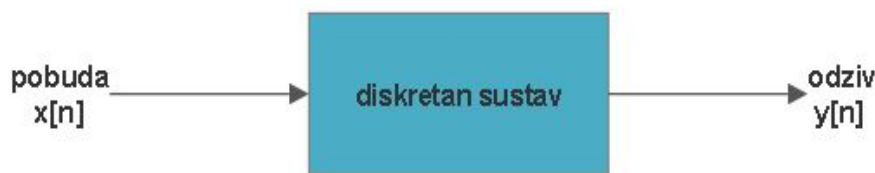
Slika 5.2. Blokovski dijagram diskretnog sustava. Izvor: Izrada autora.
