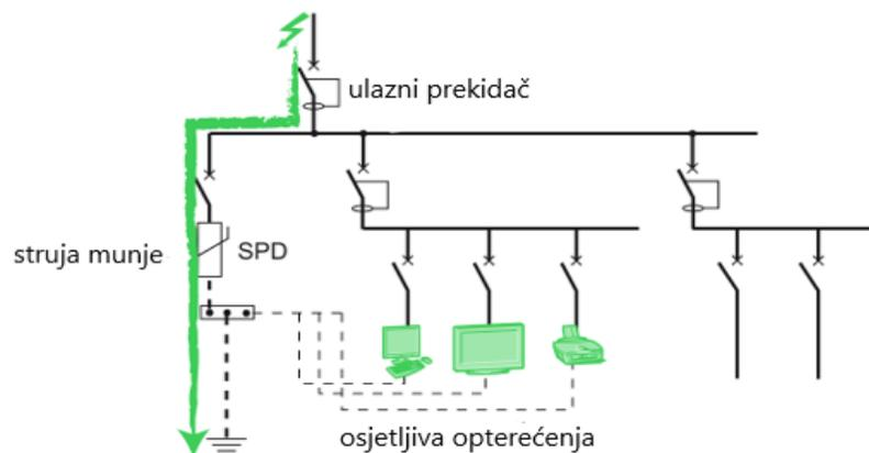
*Slika 4. Uređaj za zaštitu od prenapona*
