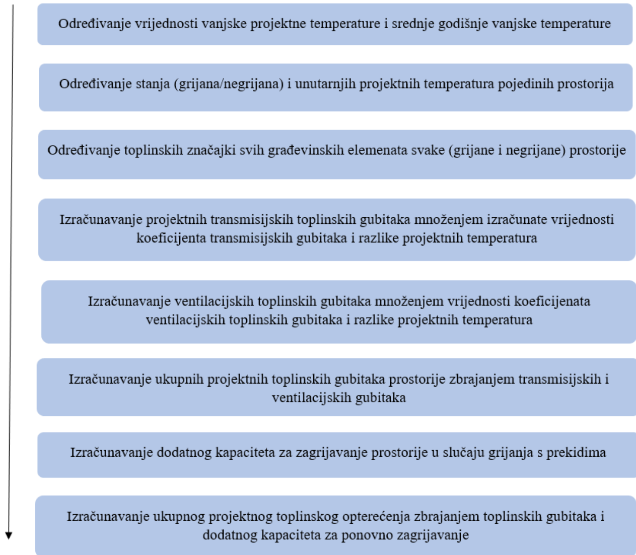
Slika 5.1 Postupak proračuna toplinskog opterećenja
