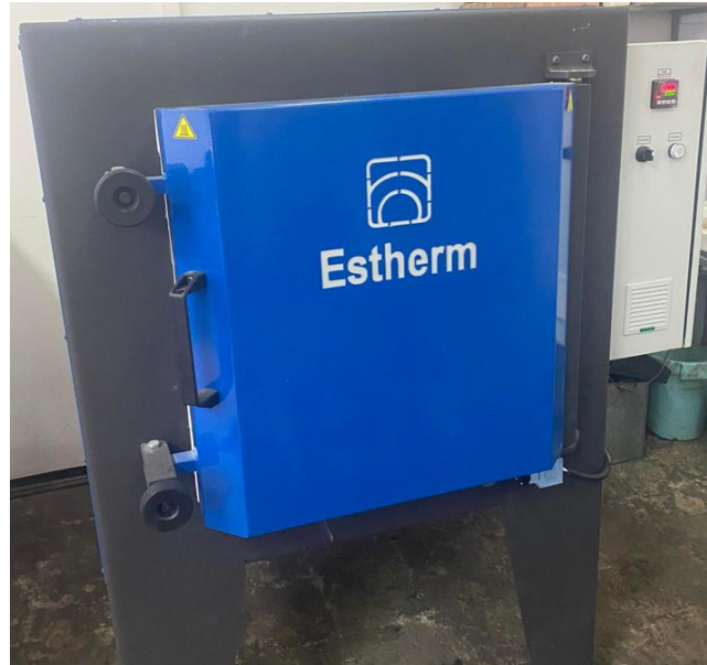
Slika 4.5. Peć za žarenje, tip "KER 175"
