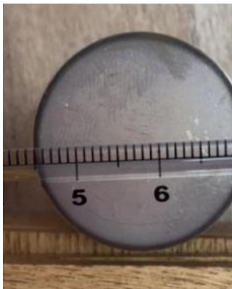
Slika 4.15. Mjerenje dubine pougljičenja ravnalom
