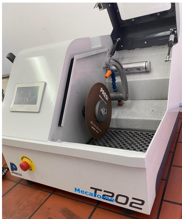
Slika 4.6. Uređaj za rezanje "Mecatome T202"
