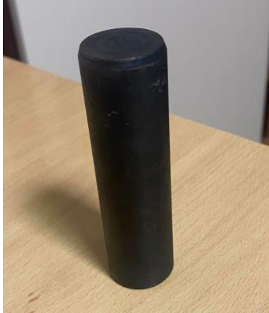
Slika 4.10. Strojni dio MJ.22-DT.39 nakon provedenog cementiranja
