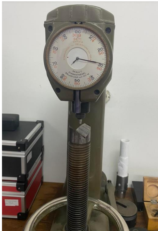
Slika 4.14. Uređaj za ispitivanje tvrdoće
