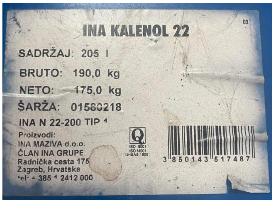
Slika 4.9. Ulje za kaljenje "INA Kalenol 22"
