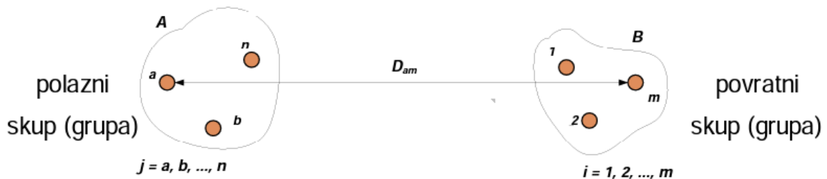
Slika 4.1. Podjela vodiča na grupu A i B
