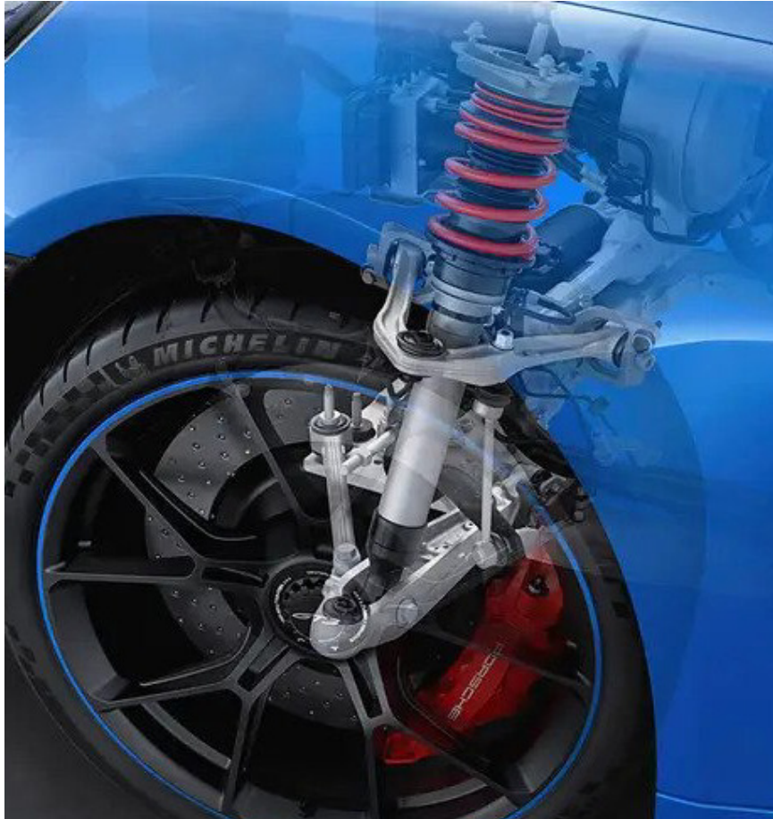
Slika 2.35 Vizualizacija ovjesa dvostrukih poprečnih ramena kod Porschea 911 GT3 [25]
