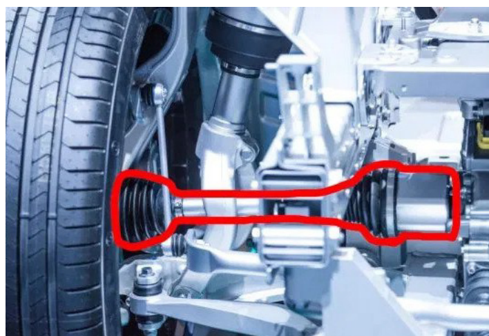
Slika 2.5 Poluvratilo u sklopu ovjesa [5]
