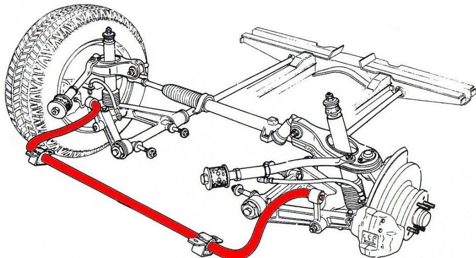
Slika 2.21 Stabilizator u sustavu ovjesa [17]
