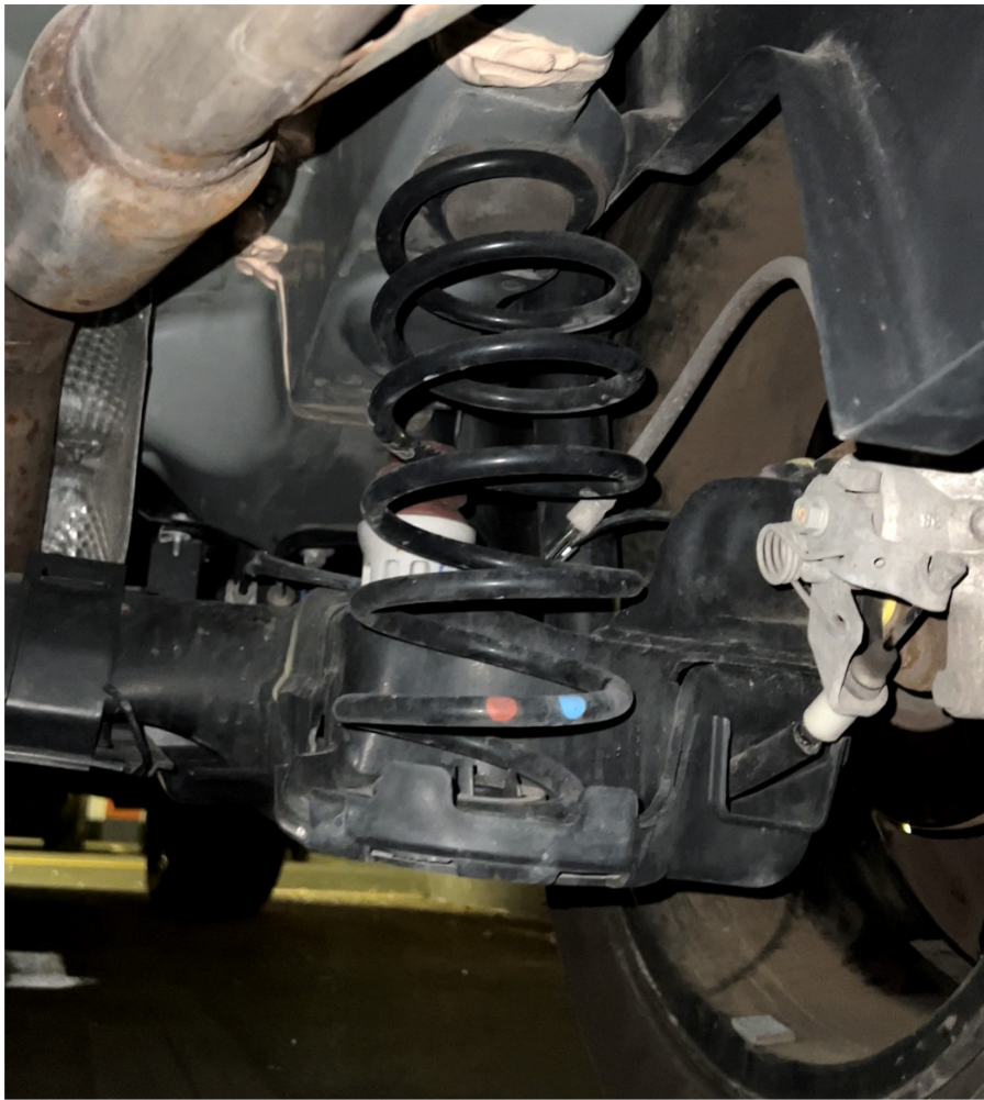
Slika 2.29 Zavisni ovjes nepogonjenoj osovini kod automobila Peugeot 2008 (2018. god.)
