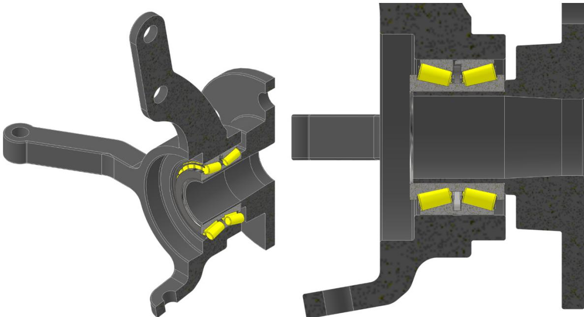
Slika 5.12 Poprečni presjek izrađenog sklopa u Inventoru
