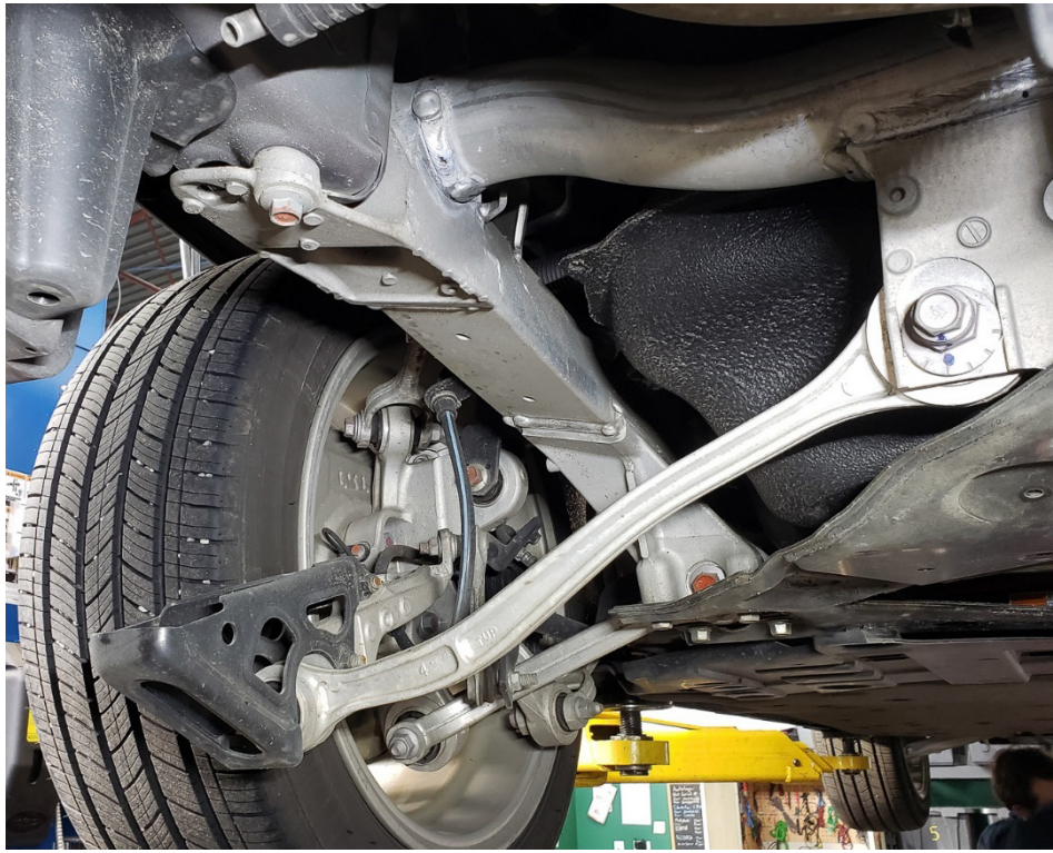
Slika 2.38 Višezglobni ovjes kod Honde Clarity (2018. god.) [27]
