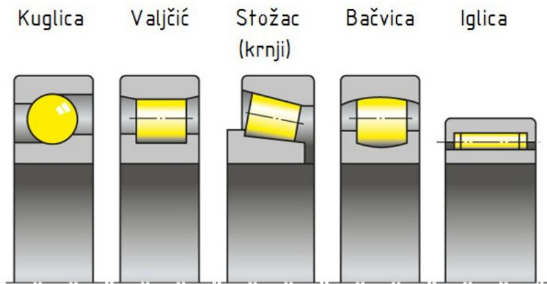
Slika 4.2 Vrste valjnih elemenata valjnih ležajeva
