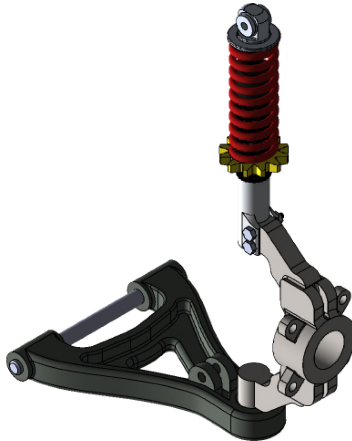
Slika 2.30 Kućište ležaja kotača, vilica i amortizer s oprugom u MacPhersonovom ovjesu
