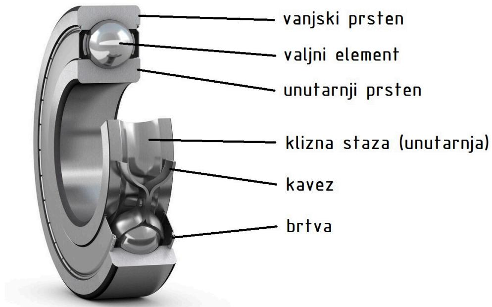
Slika 4.1 Glavni dijelovi valjnih ležajeva [38]
