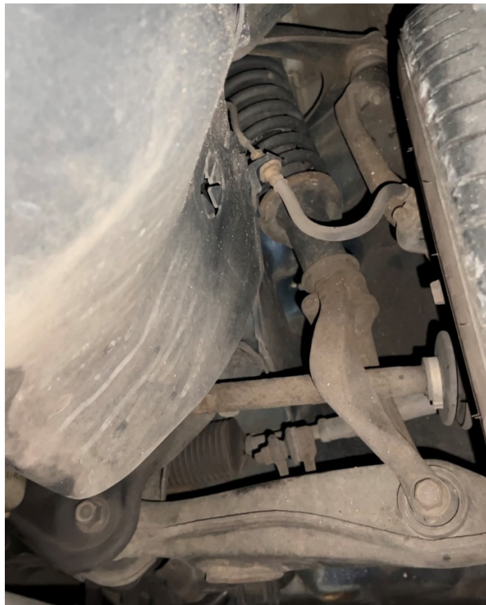
Slika 2.34 Ovjes s dvostrukim poprečnim ramenima kod Honde Civic šeste generacije
