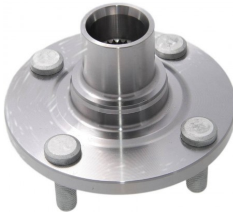
Slika 5.3 Odabrana vrsta glavčine kotača [47]
