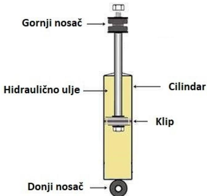
Slika 2.11 Glavni dijelovi amortizera s jednom cijevi [10]
