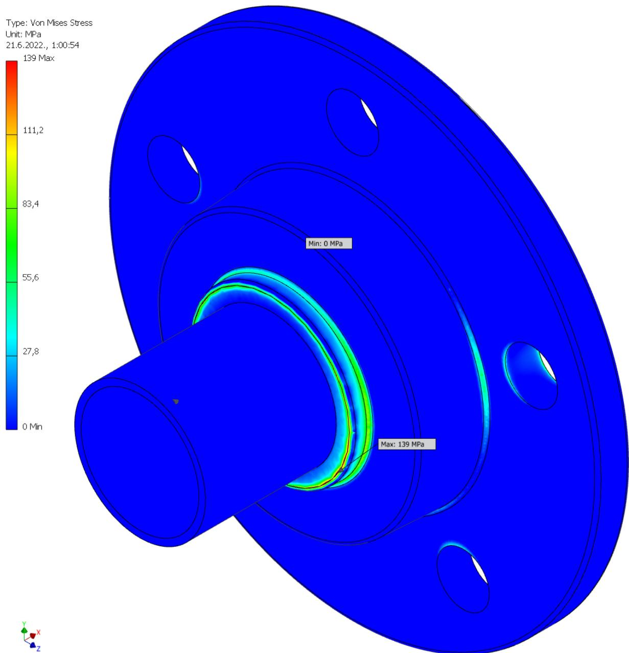
Slika 5.20 Von Misesova naprezanja na glavčini kotača
