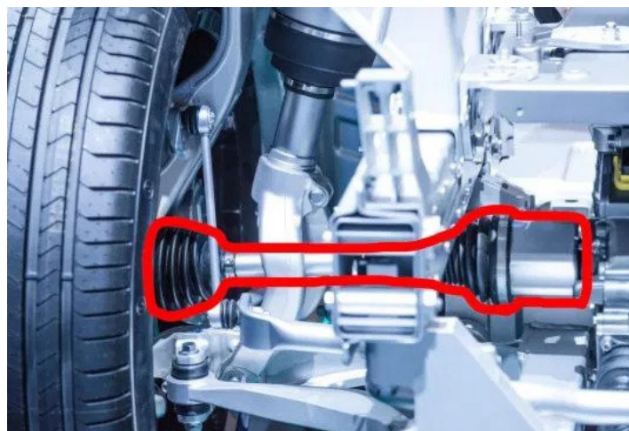
Slika 2.5 Poluvratilo u sklopu ovjesa [5]
