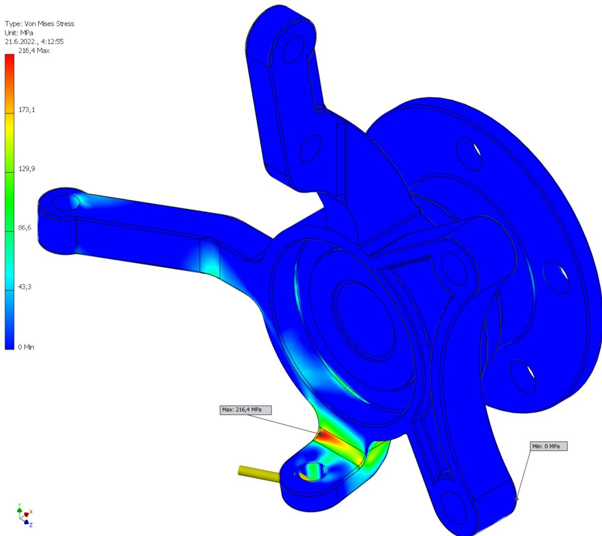
Slika 5.19 Von Misesova naprezanja u MKE analizi
