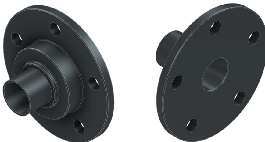
Slika 5.10 Modelirana glavčina kotača iz dva pogleda
