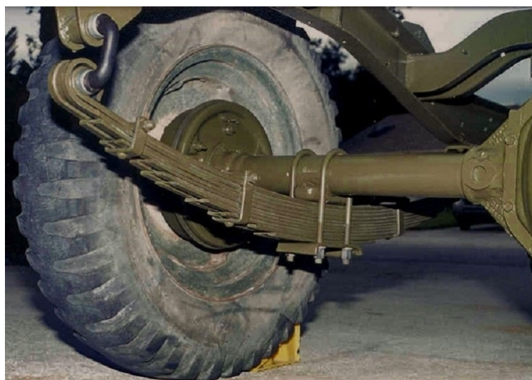
Slika 2.28 Zavisni ovjes s lisnatom oprugom kod kamiona [22]
