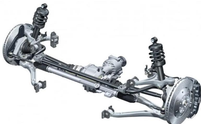
Slika 2.26 Općeniti nezavisni ovjes s dvostrukim vilicama, kočnicama i diferencijalom [21]
