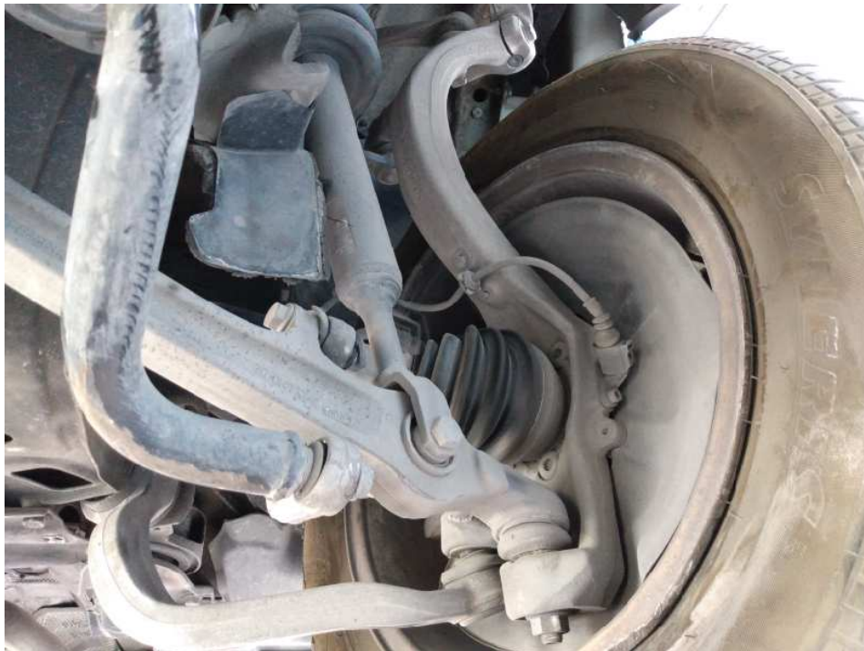
Slika 2.3 Prednji lijevi kotač automobila Audi A6 C6 s vidljivim kućištem ležaja kotača [3]
