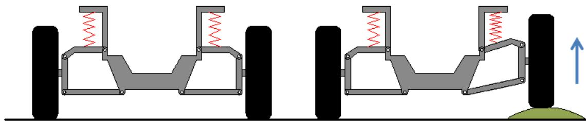
Slika 2.25 Shematski prikaz nezavisnog ovjesa u neutralnom i opterećenom stanju [20]
