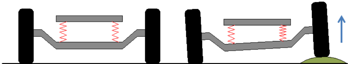
Slika 2.27 Shematski prikaz zavisnog ovjesa u neutralnom i opterećenom stanju [20]
