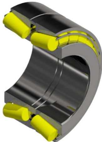
Slika 5.5 Ležaj SKF 32008T41.5 X/DB u Inventoru
