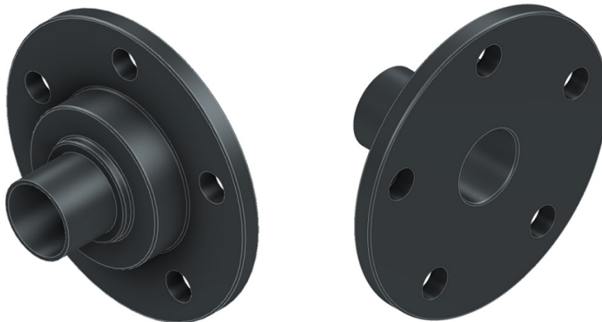
Slika 5.10 Modelirana glavčina kotača iz dva pogleda
