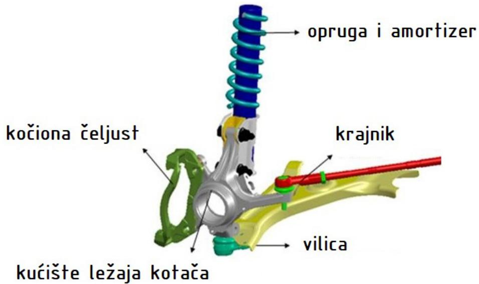
Slika 5.1 Kućište ležaja kotača s komponentama MacPhersonovog ovjesa [43]
