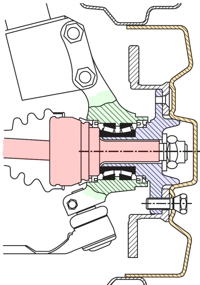
Slika 2.10 Nacrt poprečnog presjeka sklopa uležištenja kotača kod Ford Fieste [9]
