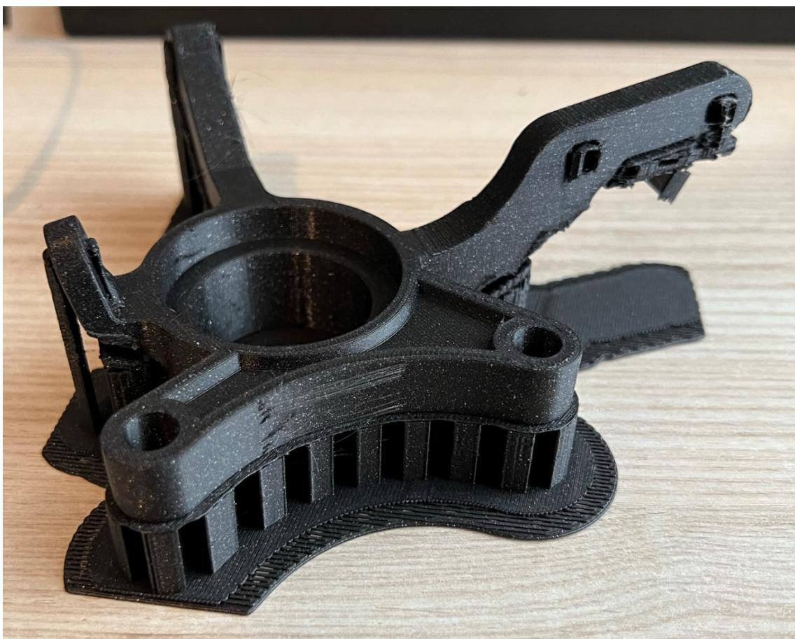
*Slika 6.3 3D printani model kućišta ležaja kotača*
