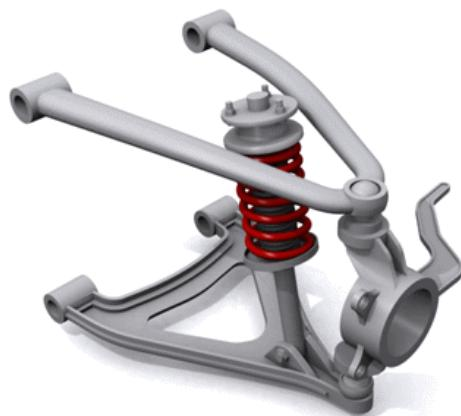
Slika 2.33 Ovjes s dvostrukim poprečnim ramenima
