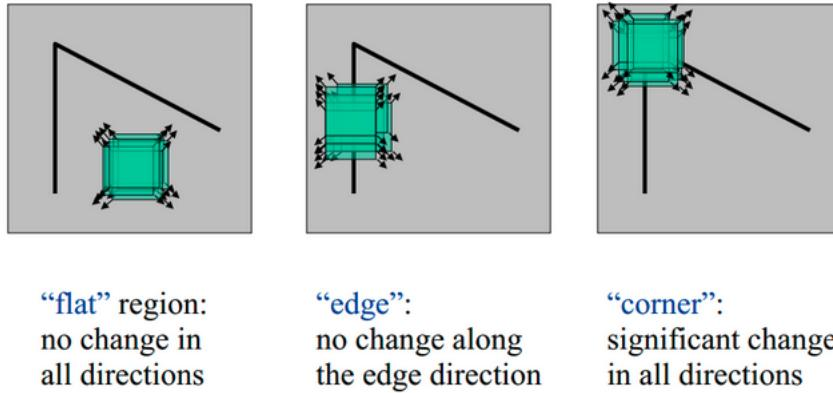
Slika 2: Detekcija ključnih točaka: jednolični prostor, rub, kut
