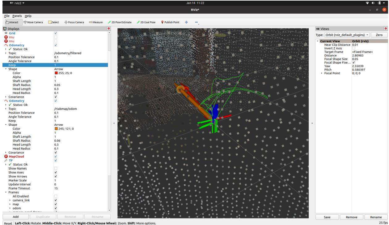
Slika 19: Vizualizacija vizuelne odometrije dobivene rgbd\_odometrijom (narančasta strelica) i odometrije dobivene iz čvora za estimaciju (crvena strelica): mali pomak u odometriji
