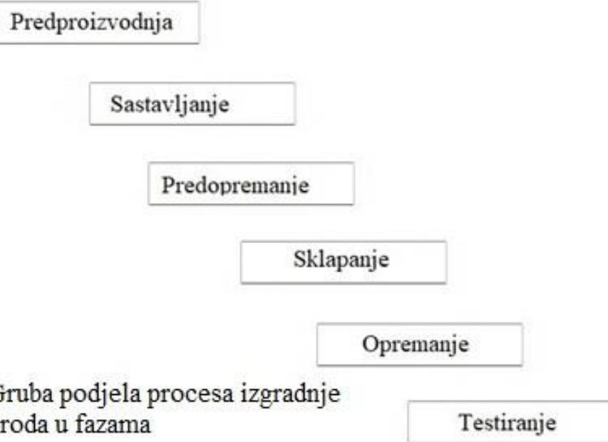
Slika 2.4. Gruba podjela procesa izgradnje broda u fazama [6]
