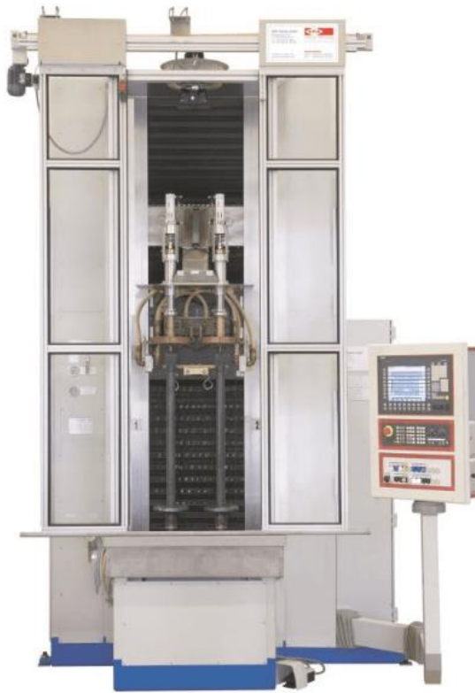
Slika 5.40 AICHELIN CETUS peć za indukcijsko kaljenje
