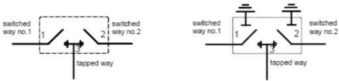
*Slika 5.5. Shematski prikaz ABB Sectos NXBD rastavne sklopke. [6]*
