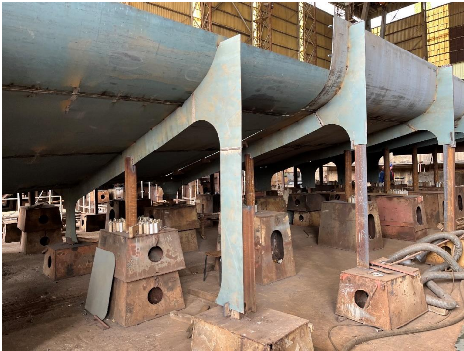
Slika 4.4. Izrada sekcije pomoću kolijevke
