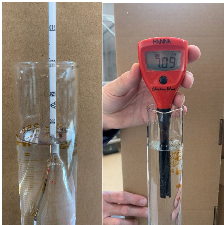
Slika 5.28. Očitavanje gustoće i pH otopine
