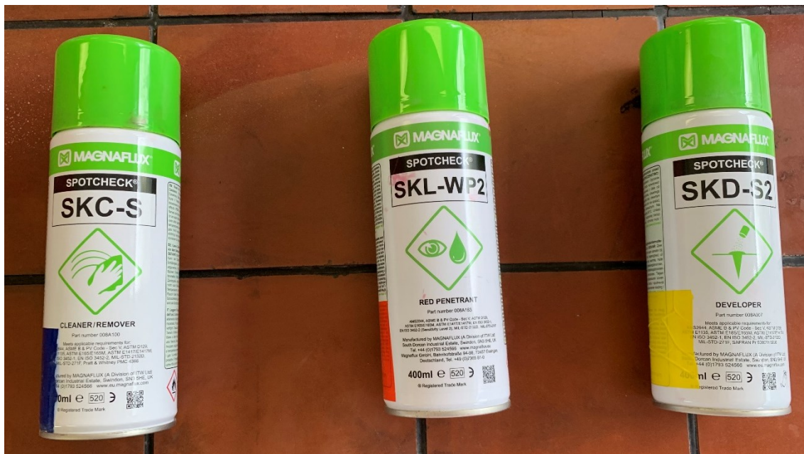
Slika 5.16. Sprejevi za testiranje penetrantima s lijeva na desno, čistač, penetrant i razvijatelj
