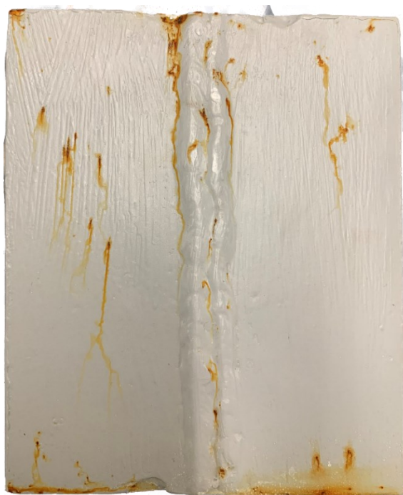
Slika 5.48. Uzorak 1-3: a) ispitivanje penetrantom, b) početak ispitivanja, c) nakon 72 sata, d) nakon 168 sati
