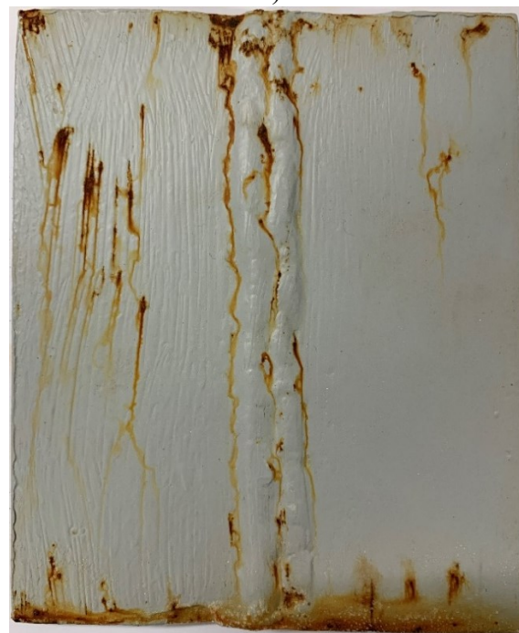
Slika 5.48. Uzorak 1-3: a) ispitivanje penetrantom, b) početak ispitivanja, c) nakon 72 sata, d) nakon 168 sati
