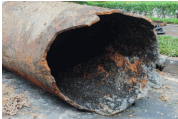
Slika 3.12. Grafitizacija ukopanog cjevovoda od sivog lijeva [32]
