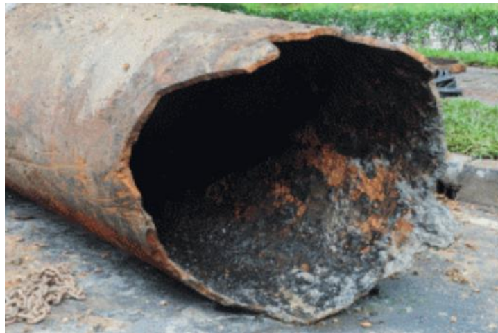
Slika 3.12. Grafitizacija ukopanog cjevovoda od sivog lijeva [32]
