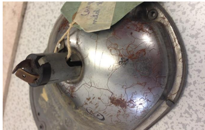
Slika 3.8. Filiformna korozija metalnog kućišta automobilskog svjetla [28]
