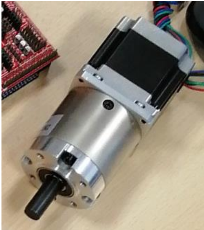
Slika 3.7. Koračni motor s planetarnim prijenosom
