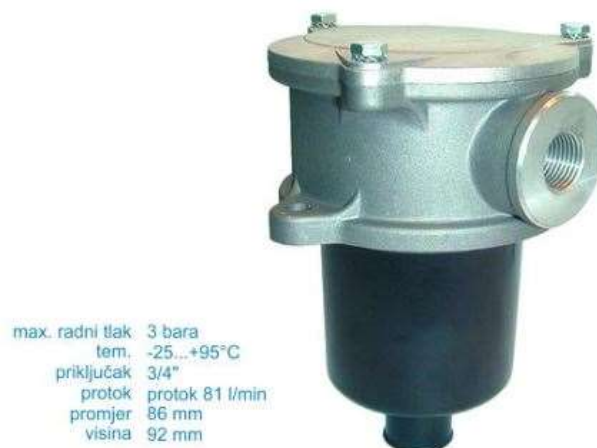
Slika 3-8 Povratni filter od 81 litara
