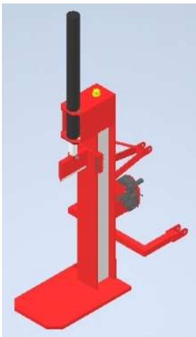
Slika 3-16 3D model konstruiranog cjepača
