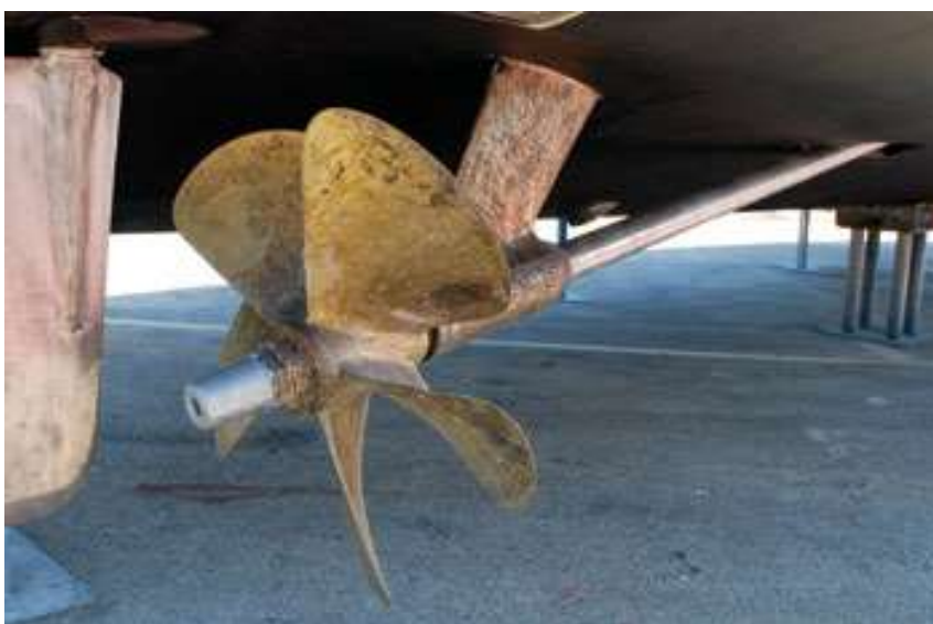
Slika 3.20 Brodski vijak sa vratilom i skrokom, [9]
