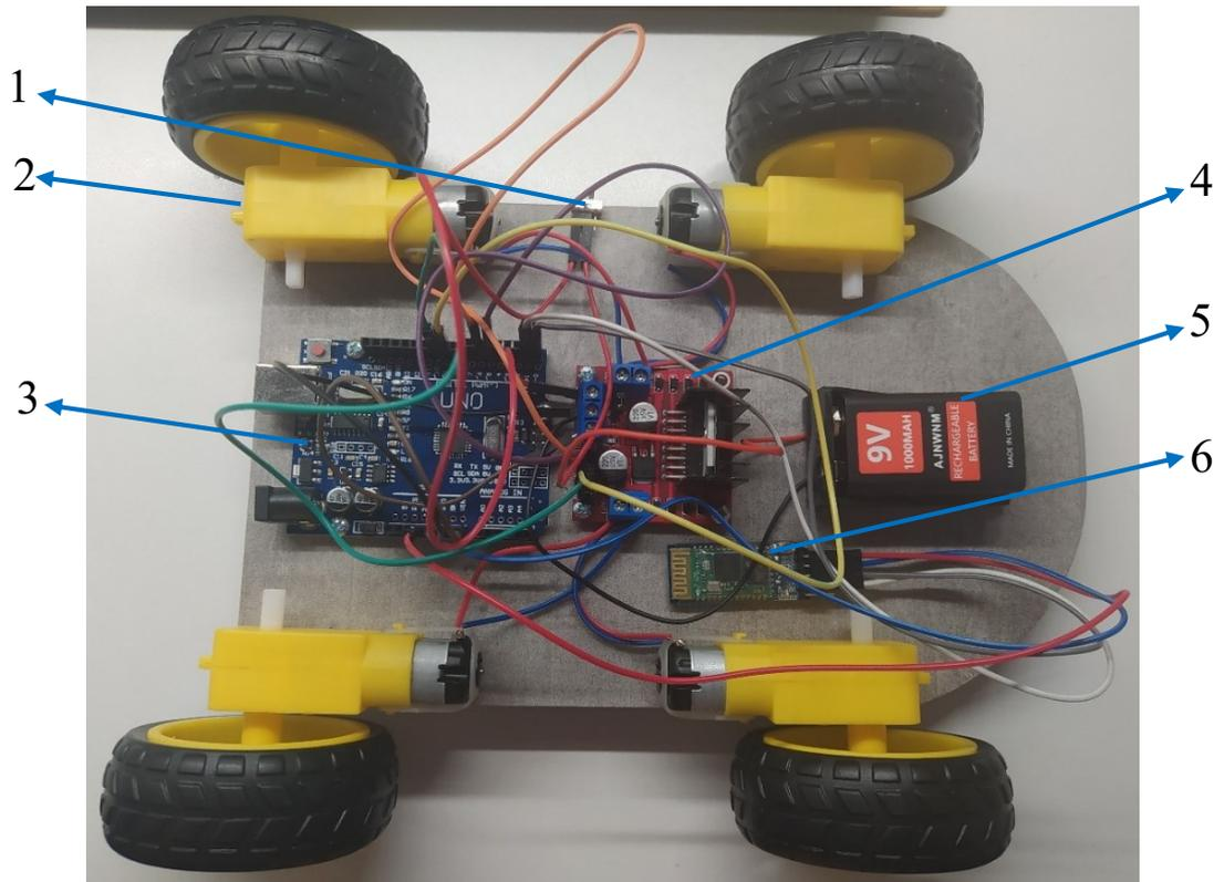
*Slika 3.4. Prikaz robotskih kolica odozgo s označenim komponentama: 1) Klizni prekidač, 2) Istosmjerni motor, 3) Arduino pločica, 4) L298N motor driver, 5) 9 V baterija, 6) HC-05 Bluetooth modul*
