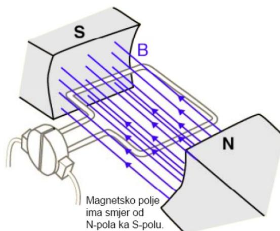
Slika 2.7. Uzbudno magnetsko polje DC motora [7].
