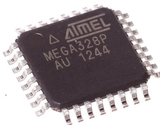
Slika 2.3. ATmega328P mikrokontroler [5].
