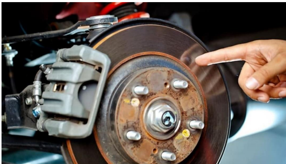
Slika 4.2. Sklop kočionog diska [14]
