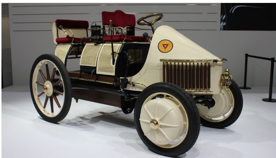
Slika 2.1 - Porsche hibridni automobil s elektromotorima u kotačima [7]
