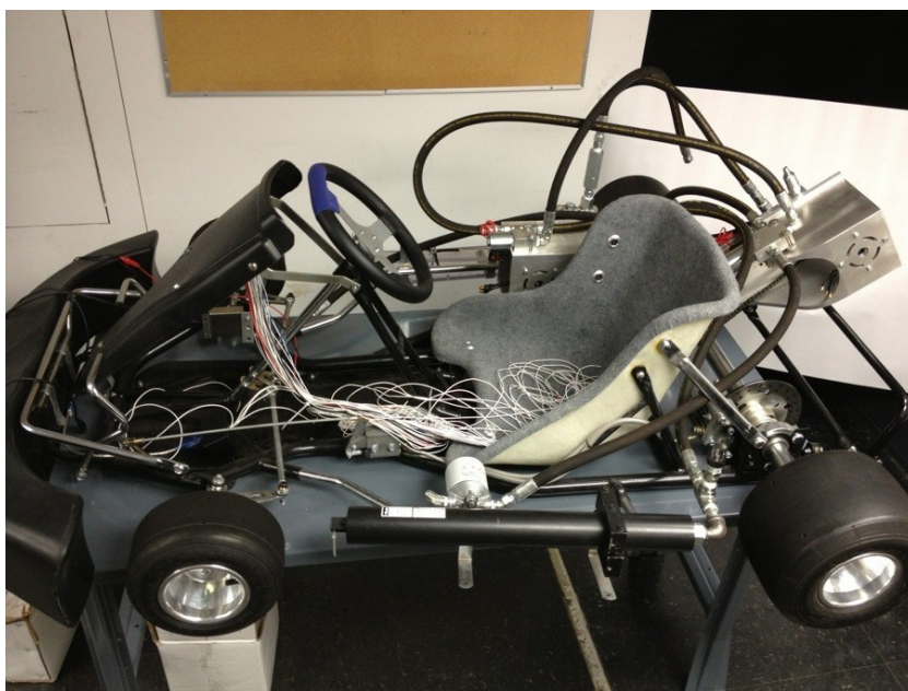
Slika 4.1 – Testno go-kart hidrauličko električno hibridno vozilo [15]
