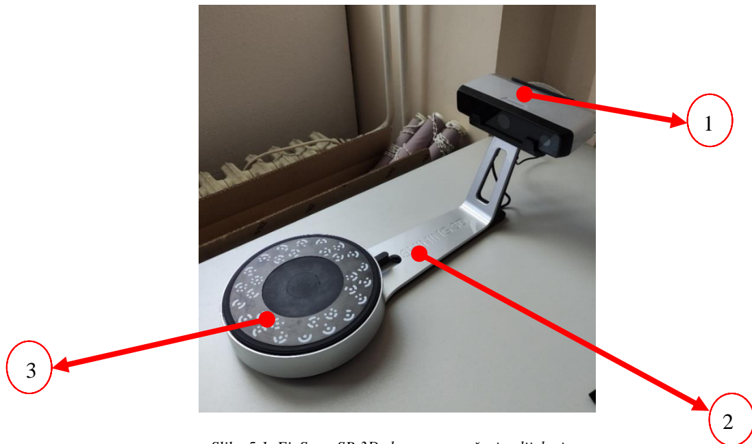
Slika 5.1. EinScan-SP 3D skener s označenim dijelovima
