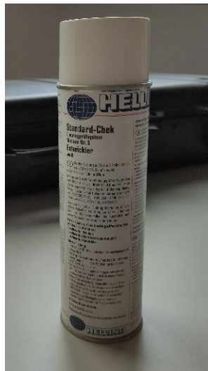
Slika 5.2. Prah za pripremu površine prilikom kontrole bez razaranja
