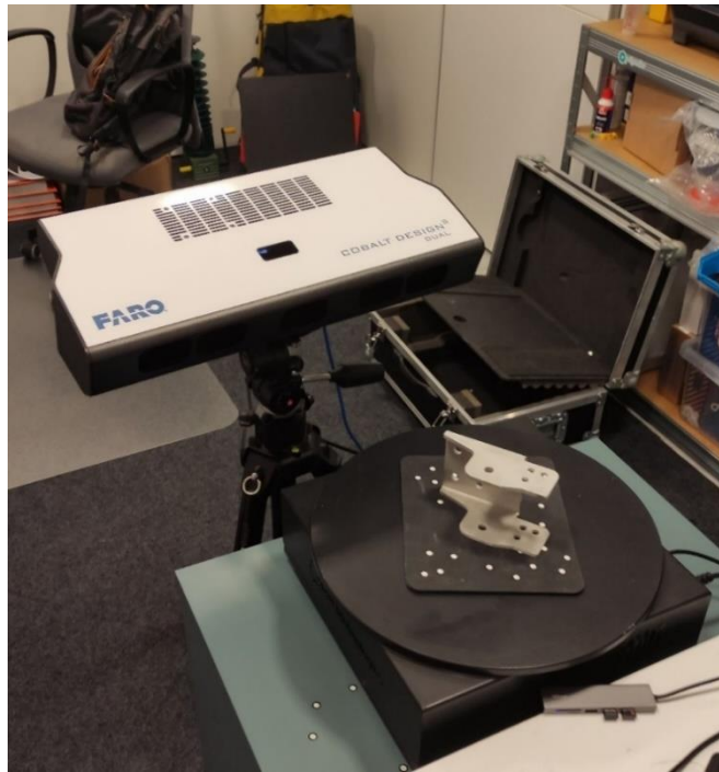
Slika 3.1. Faro Cobalt Design Duo skener sa strukturiranim svjetlom
