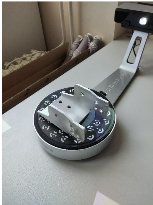
Slika 5.15. Drugi položaj skeniranja elementa 1
