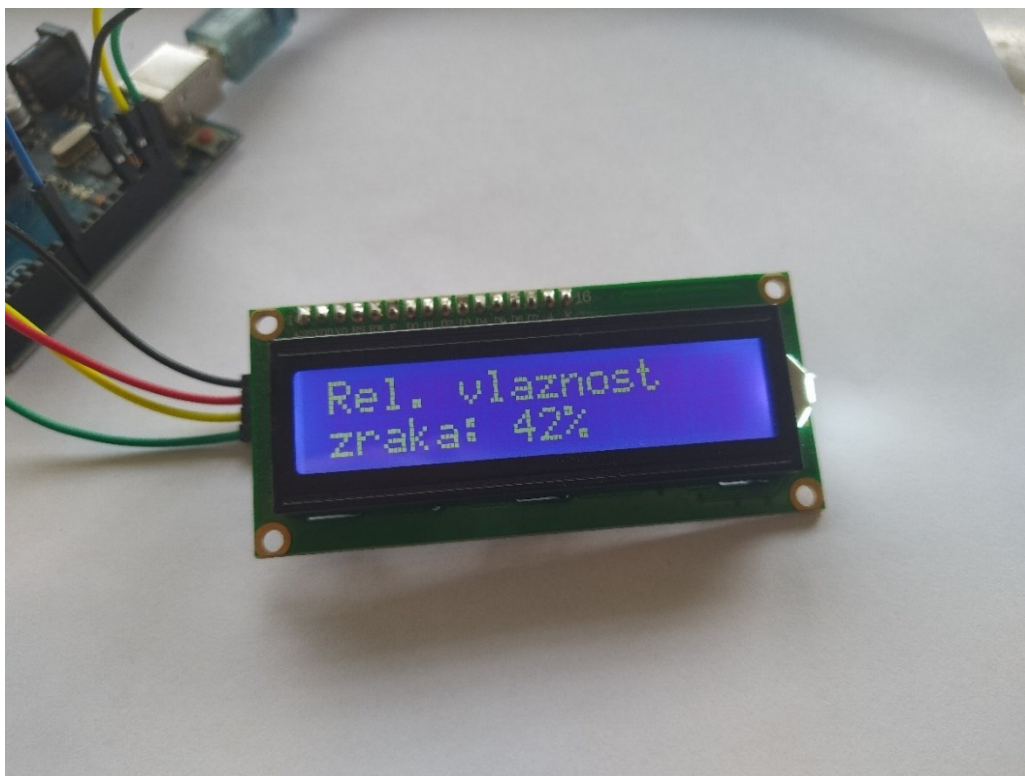
Slika 4.19. Ispis postotne relativne vlažnosti zraka na LCD 16x2 zaslonu
