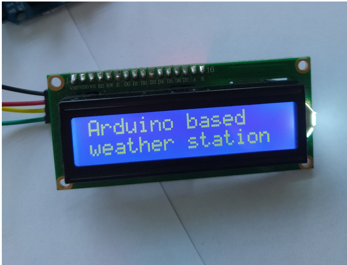
Slika 4.6. Prikaz LCD 16x2 zaslona pri ispisu u svrhu provjere ispravnosti uređaja
