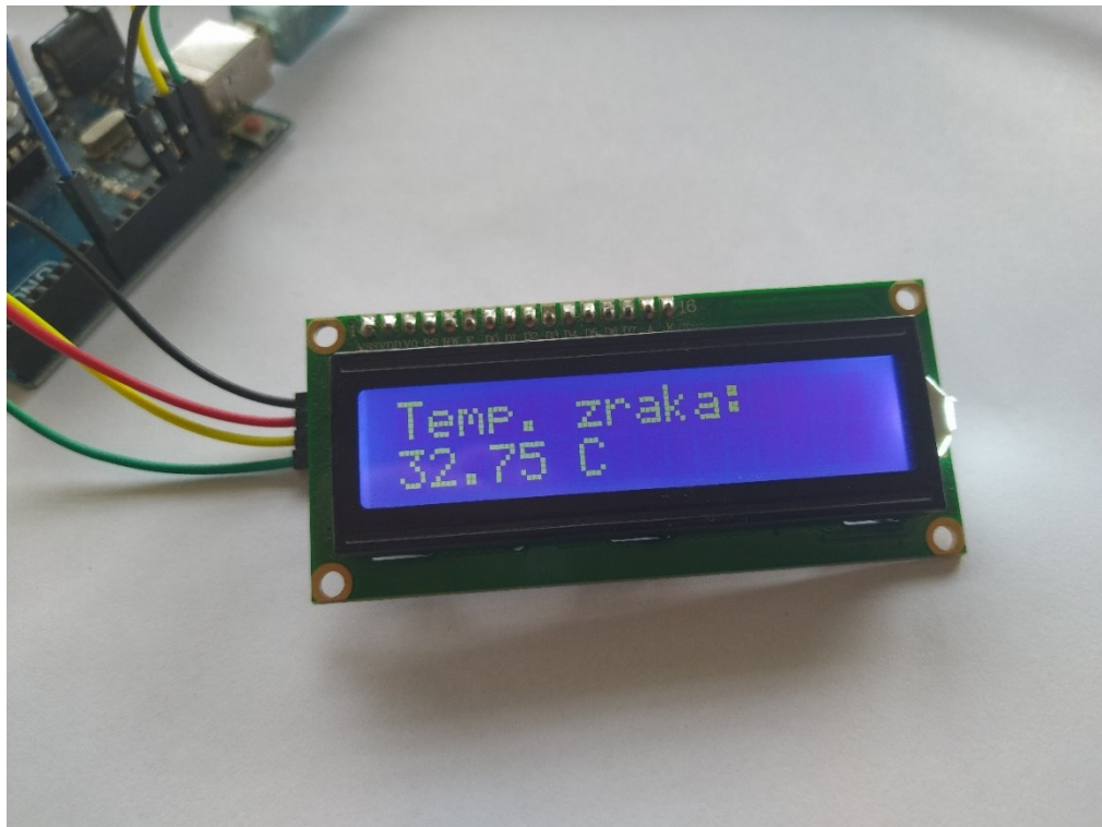
Slika 4.10. Ispis vrijednosti temperature zraka na LCD 16x2 zaslonu
