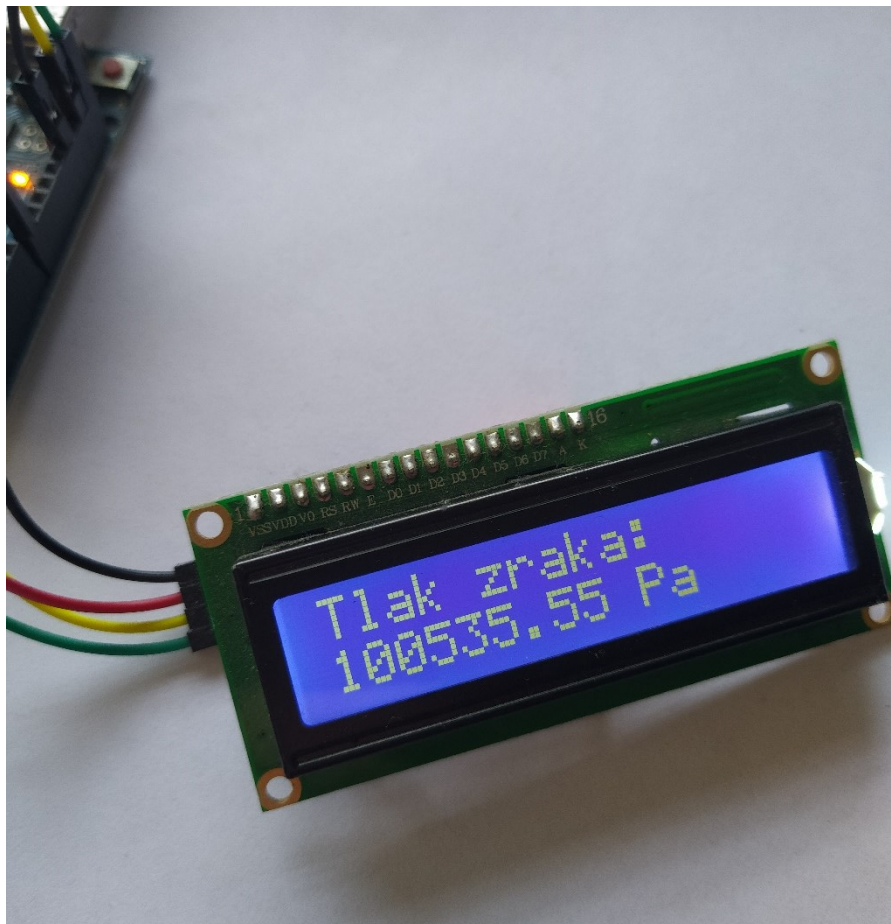
Slika 4.11. Ispis vrijednosti atmosferskog tlaka na LCD 16x2 zaslonu
