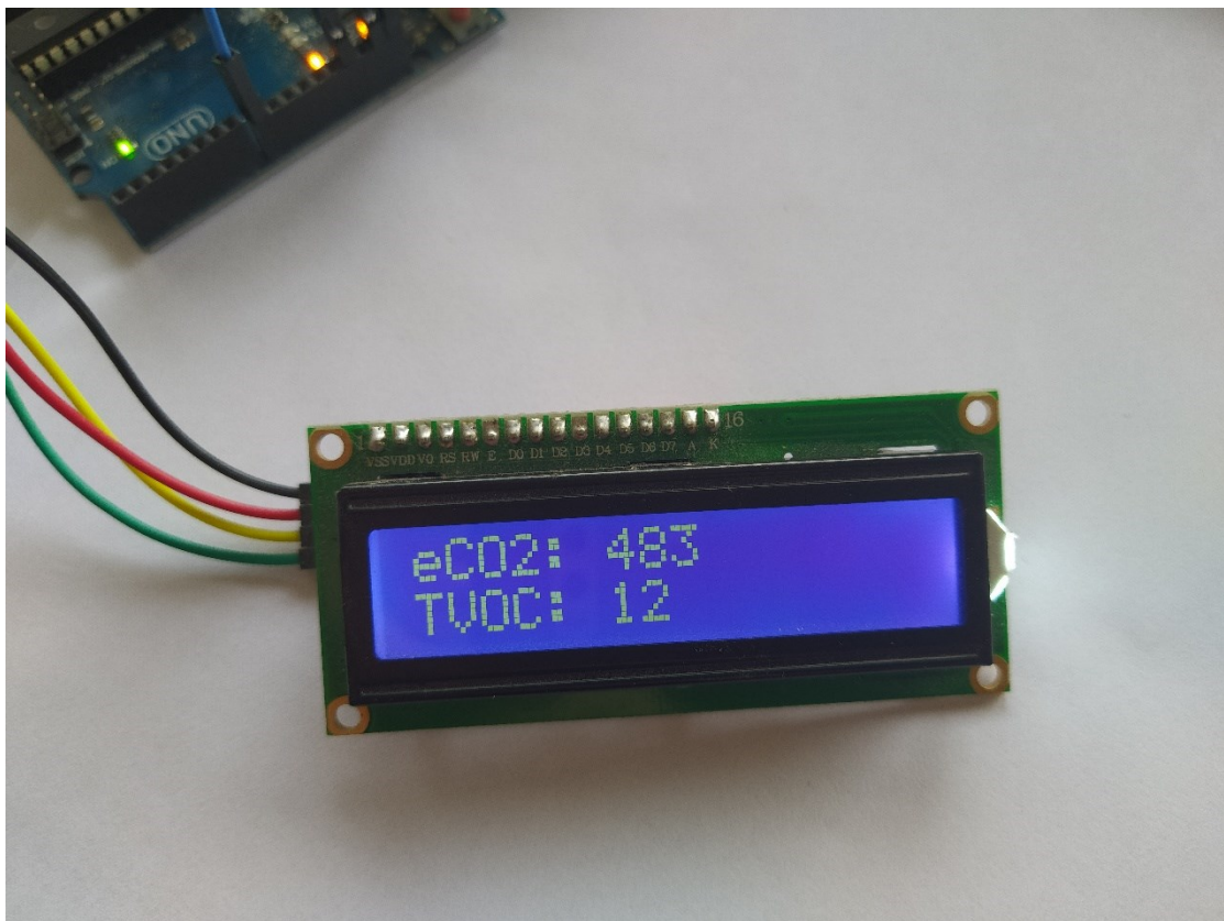
Slika 4.15. Ispis eCO 2 i TVOC vrijednosti na LCD 16x2 zaslonu 5 minuta nakon uključanja
