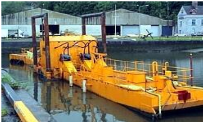
Slika 4 Model McCabe-ove pumpe, izvor [11]
