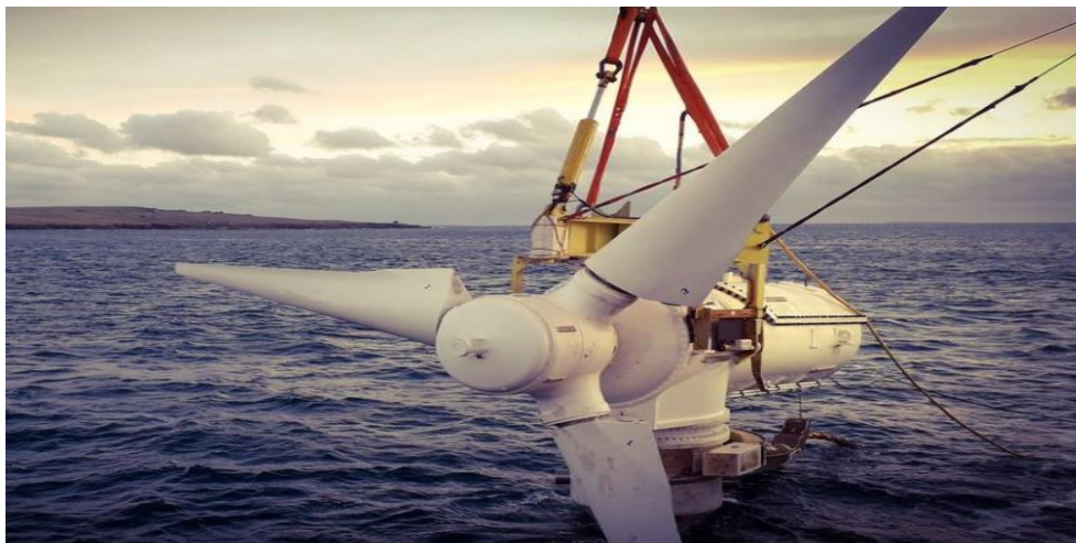
Slika 20 Plimna energetska turbina projekta MeyGen u Škotskoj, izvor [70]
