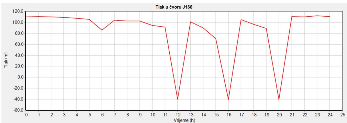
Slika 6.11. Graf tlak-vrijeme u čvoru J168 kada je osnovna potražnja 5,8 l/s
