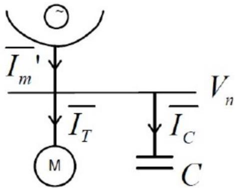
Slika 4.b) Kondenzatorska baterija spojena paralelno potrošaču [8]
