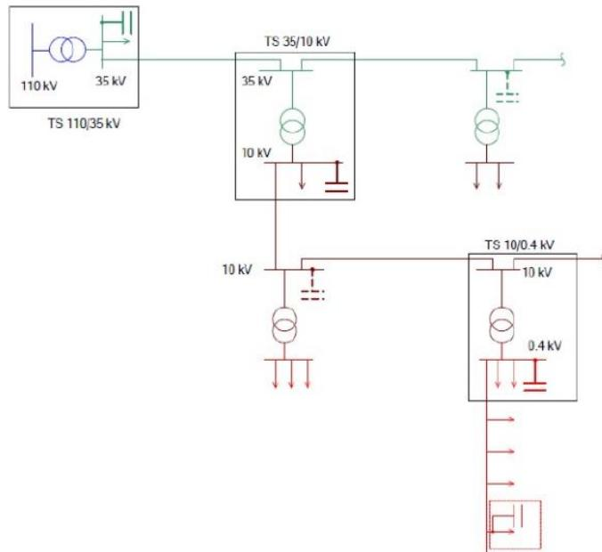
*Slika 4.1.1.a) Ugradnja kondenzatorskih baterija na strani nižeg napona, [8]*
