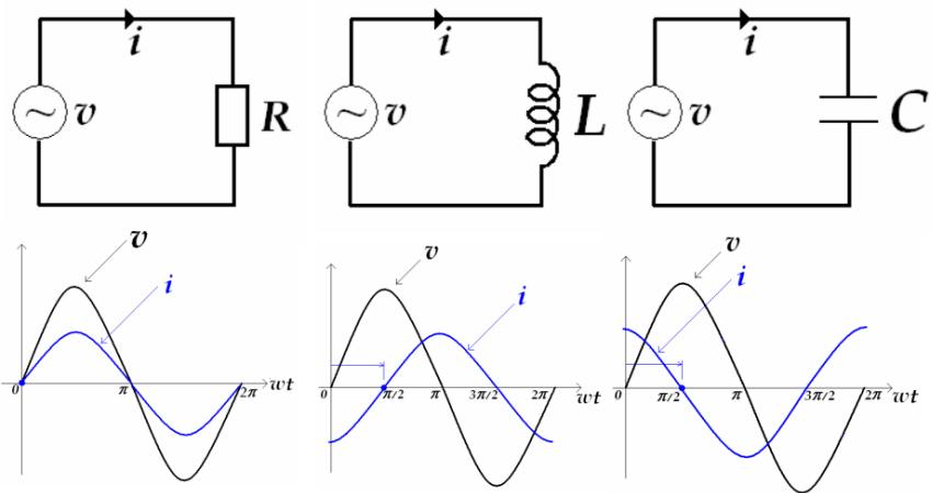
*Slika 2. Usporedba valnih oblika čisto otpornog (lijevo), čisto induktivnog (sredina) i čisto kapacitivnog (desno) trošila*
