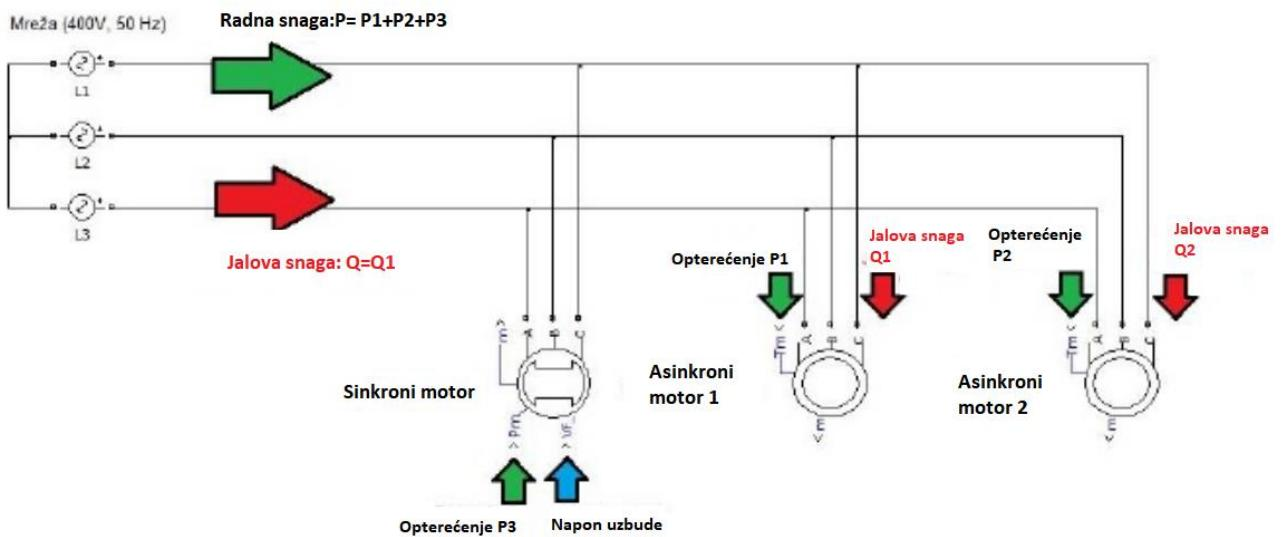
*Slika 4.1.5.a) Kompenzacija jalove snage pomoću sinkronog motora [8]*
