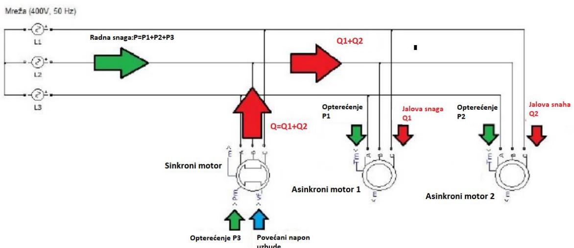
*Slika 4.1.5. b) Kompenzacija jalove snage pomoću asinkronog motora [8]*
