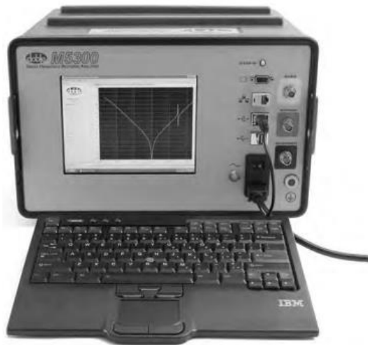
Slika 3.10. Instrument za ispitivanje frekvencijskog odziva M5300 [1]
