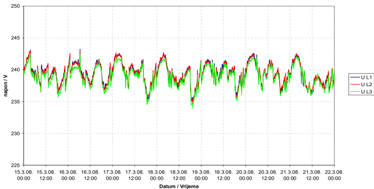
Slika 5.5. Vrijednost napona na mjernom mjestu 1 [18]
