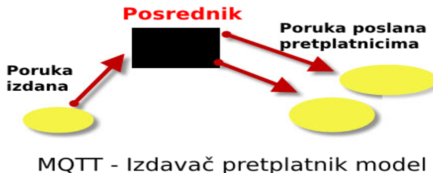
Slika 7.1. MQTT - Izdavač pretplatnik model
