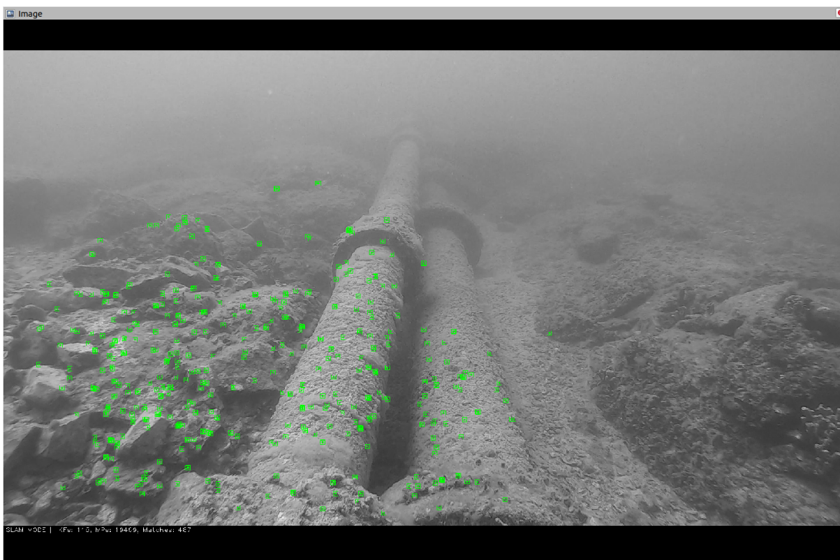
Slika 3.14: Primjer: više značajki u okolini nego na objektu kojeg želimo modelirati
