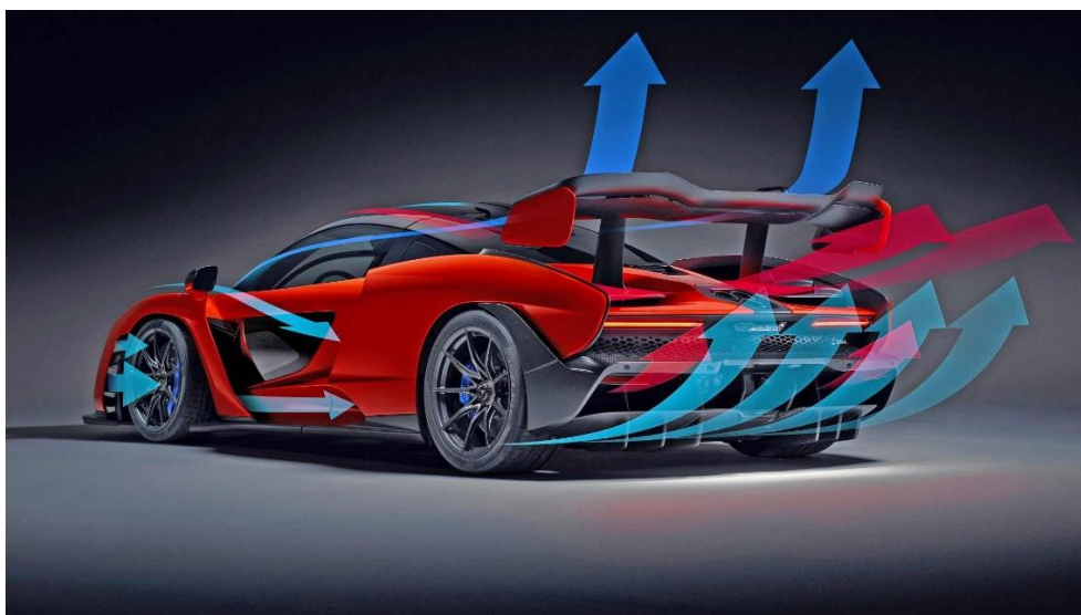
Slika 3.3. Prikaz strujanja zraka oko automobila [7]
